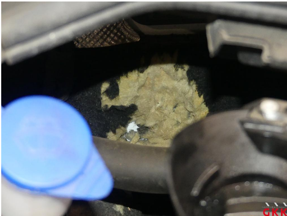
Bild 16 Motorraum, Dämmmatte, beschädigt, ersetzen
