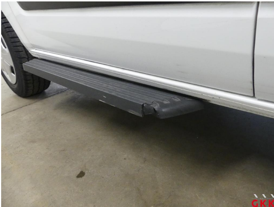
Bild 22 Schweller rechts, Trittbrett, beschädigt, ersetzen
