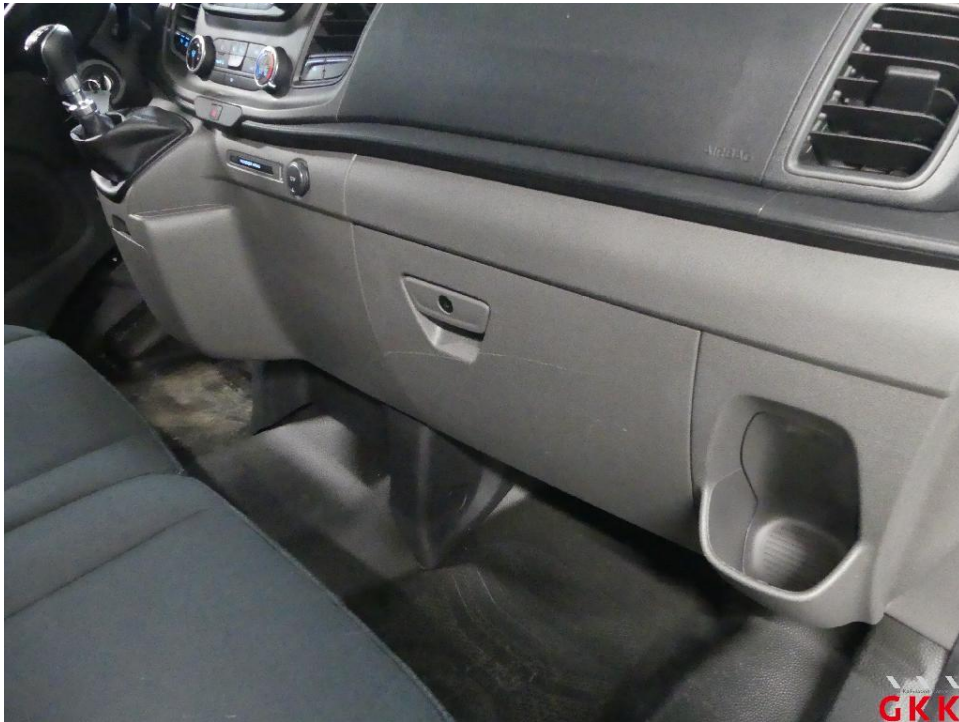
Bild 17 Handschuhfach, Deckel, verkratzt, Smartrepair
