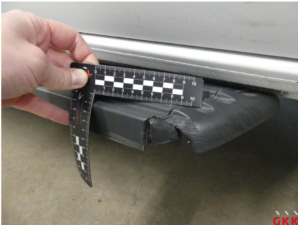
Bild 20 Schweller rechts, Trittbrett, beschädigt, ersetzen
