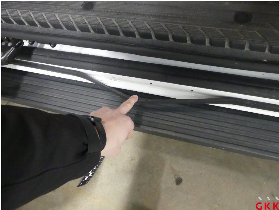
Bild 23 Schiebetür rechts, Dichtung -Einstieg-, lose, ersetzen
