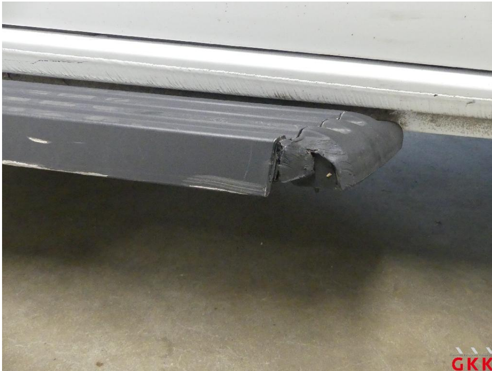
Bild 21 Schweller rechts, Trittbrett, beschädigt, ersetzen
