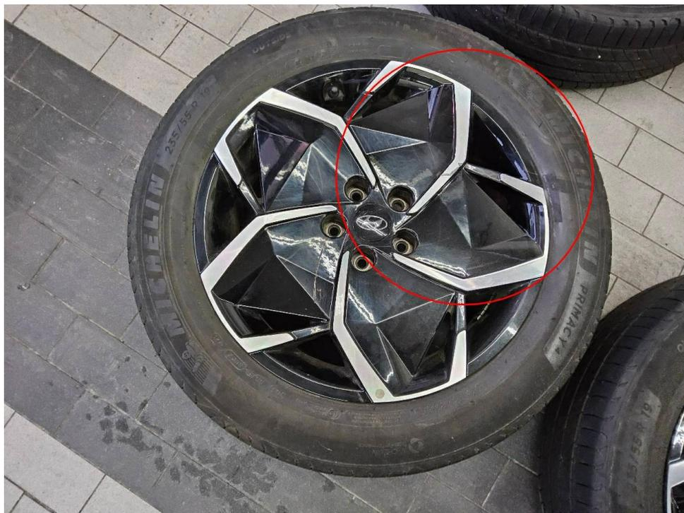
Bild 9 : Alufelge hinten rechts, verschrammt
