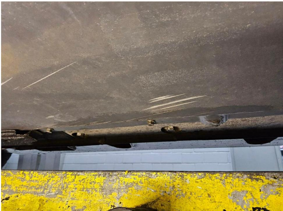
Bild 13 : Unterbodenverkleidung, verschrammt
