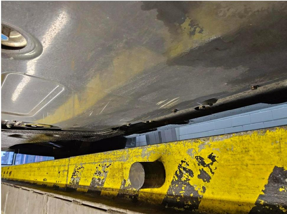
Bild 12 : Unterbodenverkleidung, verschrammt
