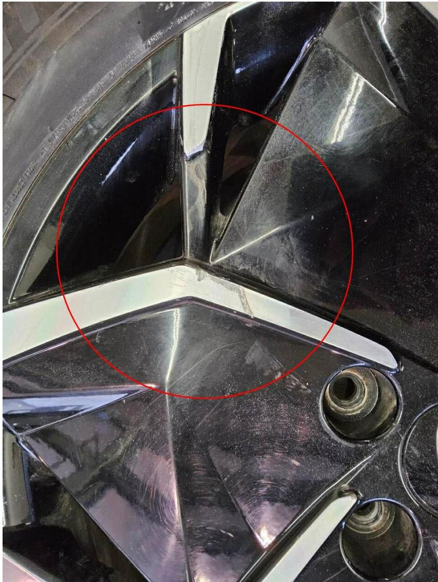
Bild 11 : Alufelge hinten rechts, verschrammt
