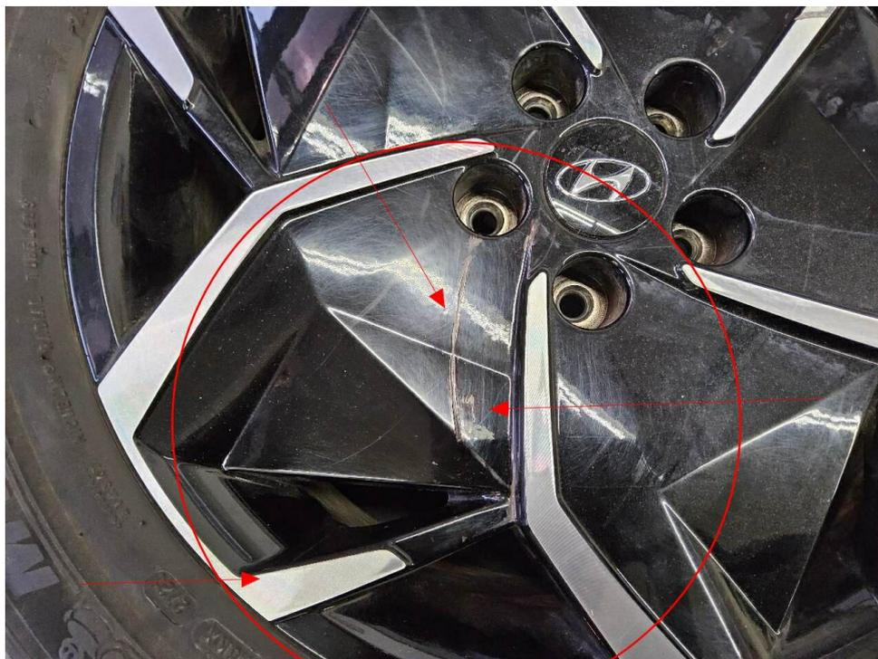
Bild 10 : Alufelge hinten rechts, verschrammt
