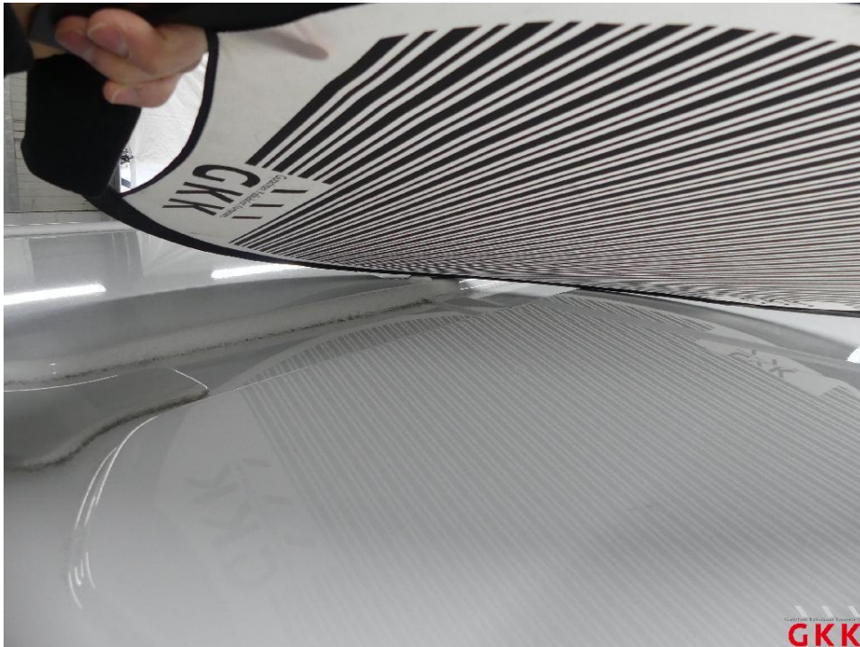
Bild 19 Fahrzeug, Hagelschaden, instand setzen
