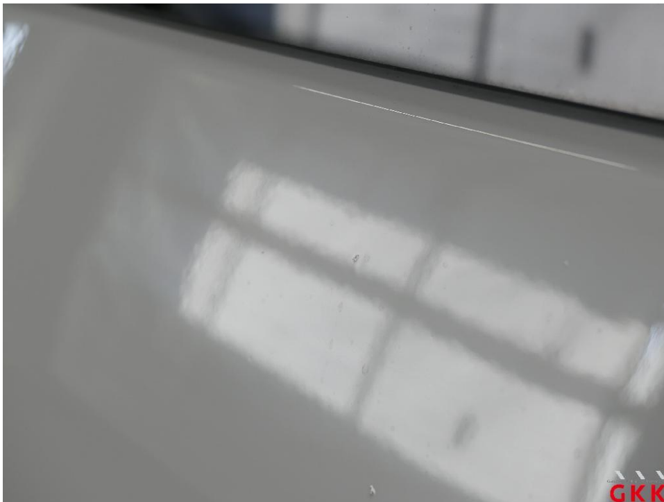
Bild 36 Hecktür rechts, Reparaturmangel, polieren
