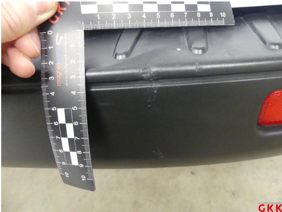
Bild 27 Stoßfänger hinten, Verkleidung -unlackiert-, aufgeworfen, ersetzen
