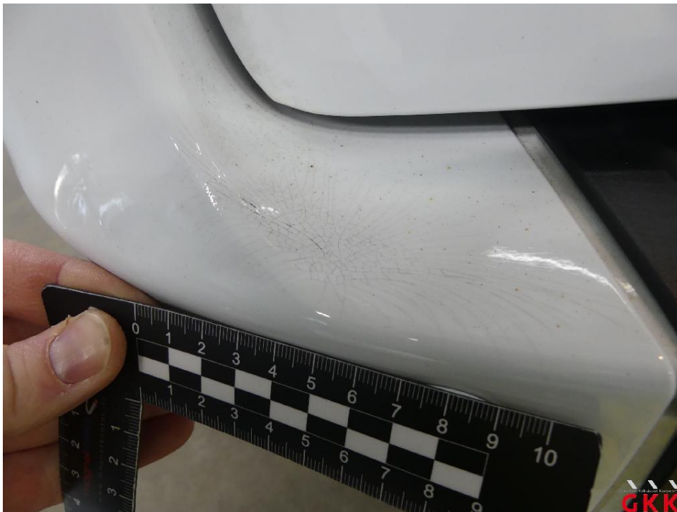
Bild 34 Stoßfänger hinten, Ecke links -lackiert-, beschädigt, instand setzen - lackieren
