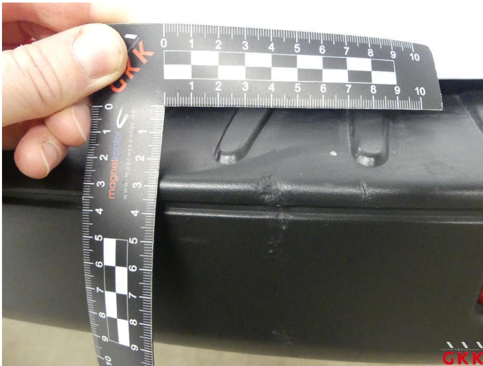
Bild 28 Stoßfänger hinten, Verkleidung -unlackiert-, aufgeworfen, ersetzen
