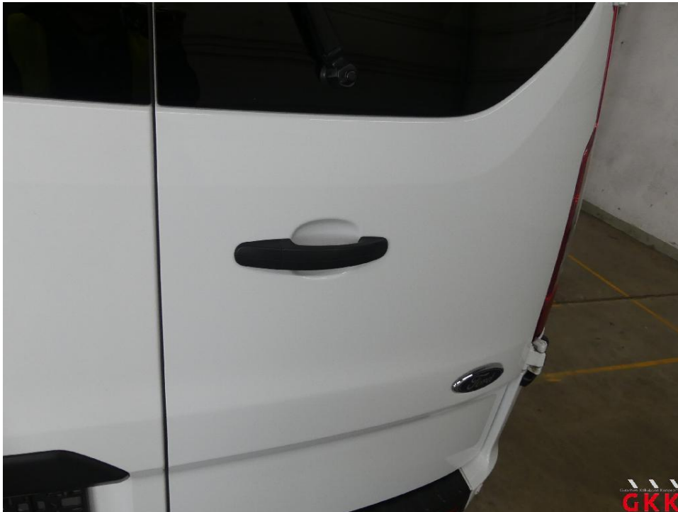
Bild 35 Hecktür rechts, Reparaturmangel, polieren
