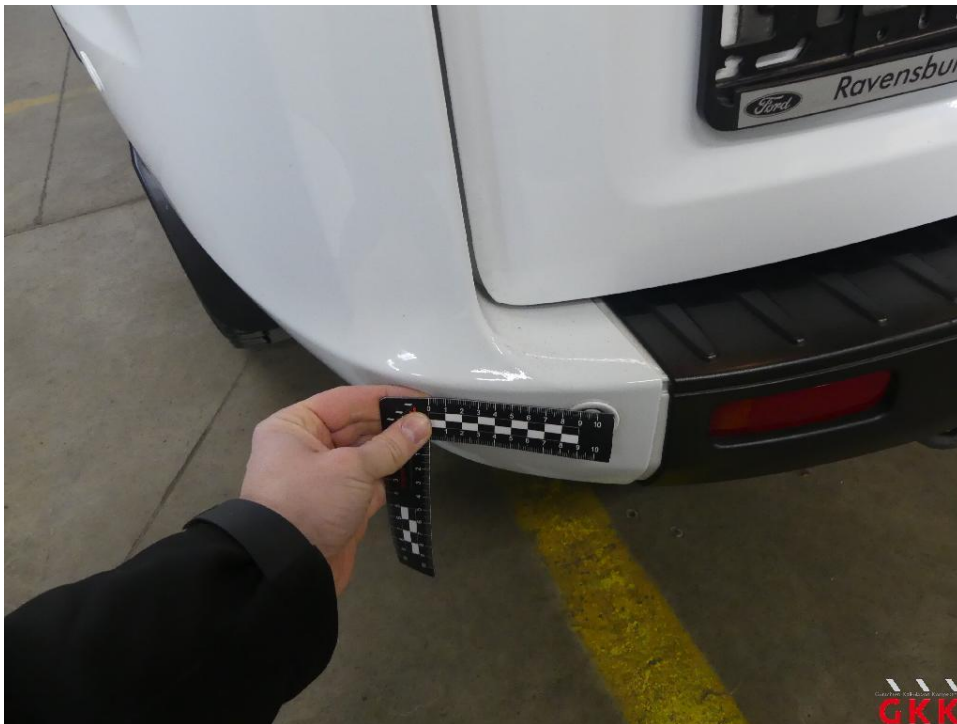
Bild 32 Stoßfänger hinten, Ecke links -lackiert-, beschädigt, instand setzen - lackieren
