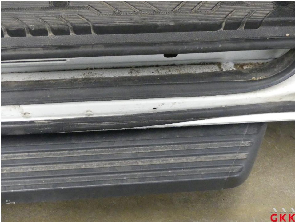
Bild 25 Schiebetür rechts, Dichtung -Einstieg-, lose, ersetzen
