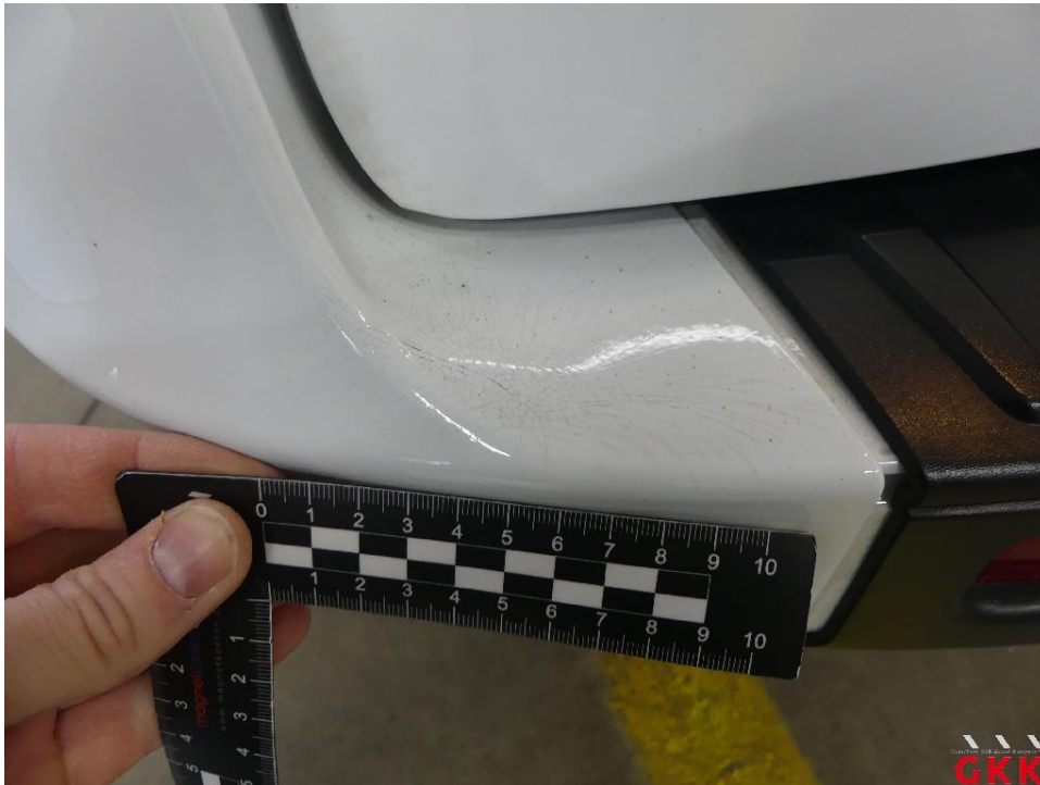
Bild 33 Stoßfänger hinten, Ecke links -lackiert-, beschädigt, instand setzen - lackieren
