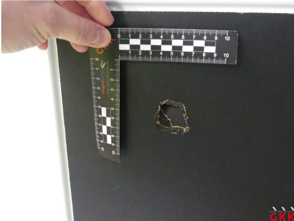
Bild 31 Hecktür links, Innenverkleidung, beschädigt, ersetzen
