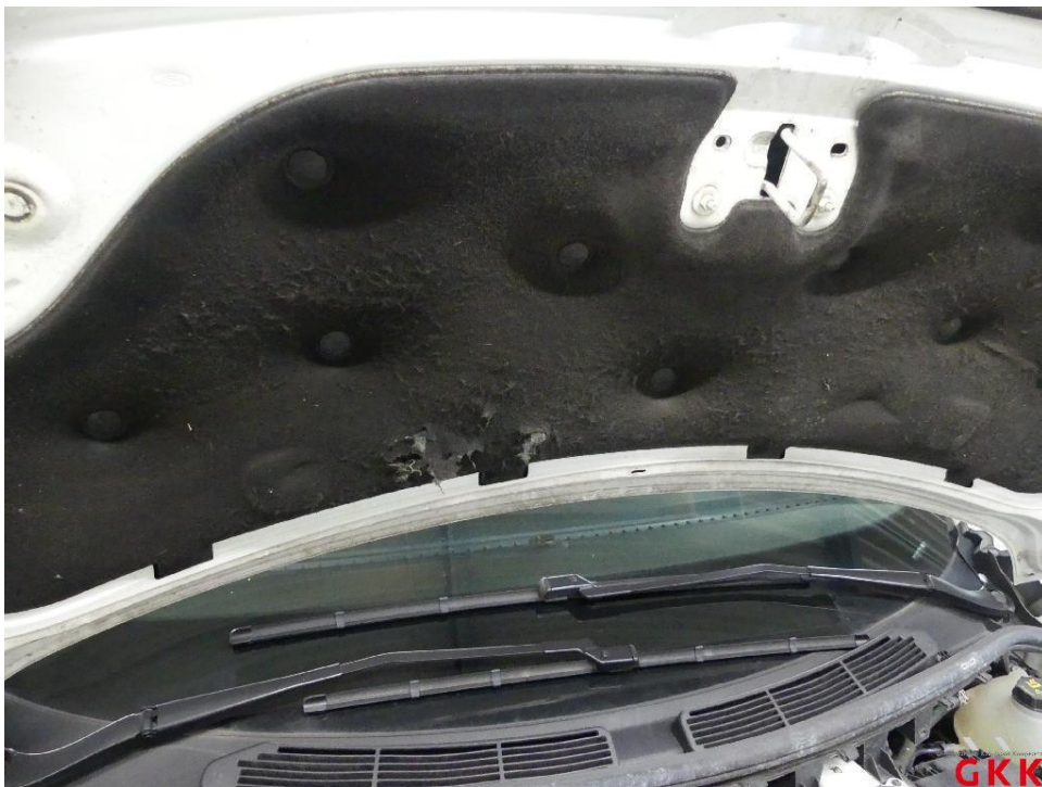
Bild 14 Motorhaube, Dämmmatte, beschädigt, ersetzen
