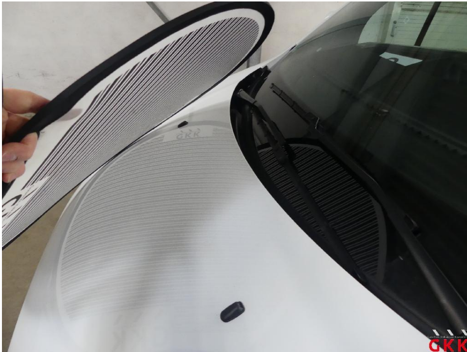
Bild 17 Fahrzeug, Hagelschaden, instand setzen
