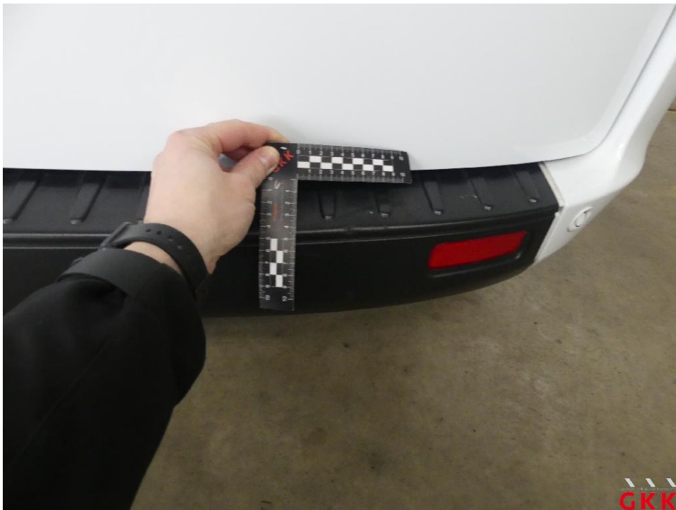
Bild 26 Stoßfänger hinten, Verkleidung -unlackiert-, aufgeworfen, ersetzen
