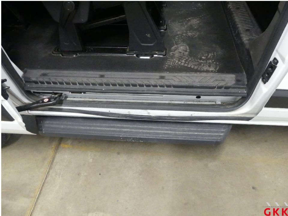
Bild 23 Schiebetür rechts, Dichtung -Einstieg-, lose, ersetzen
