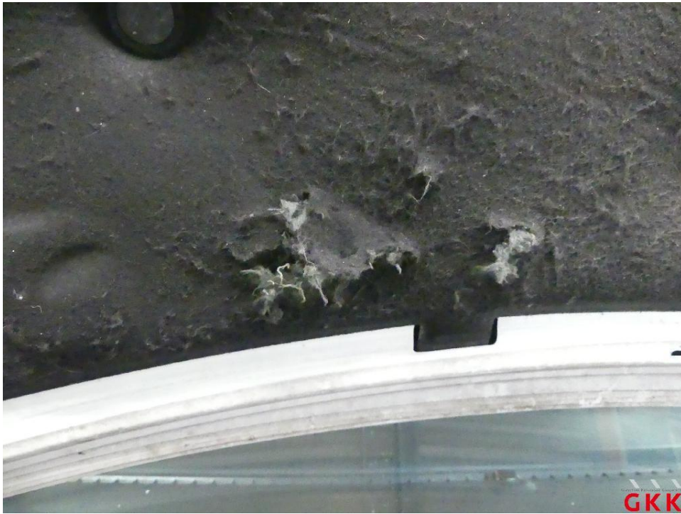
Bild 15 Motorhaube, Dämmmatte, beschädigt, ersetzen
