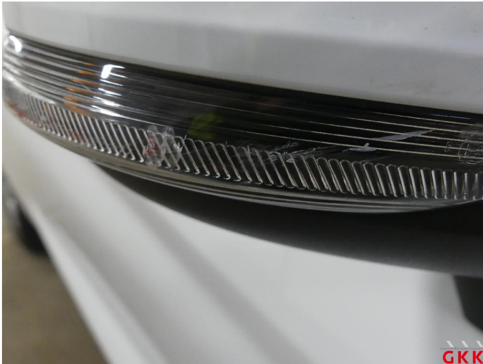
Bild 33 Spiegelgehäuse rechts, Blinker, verkratzt, ersetzen
