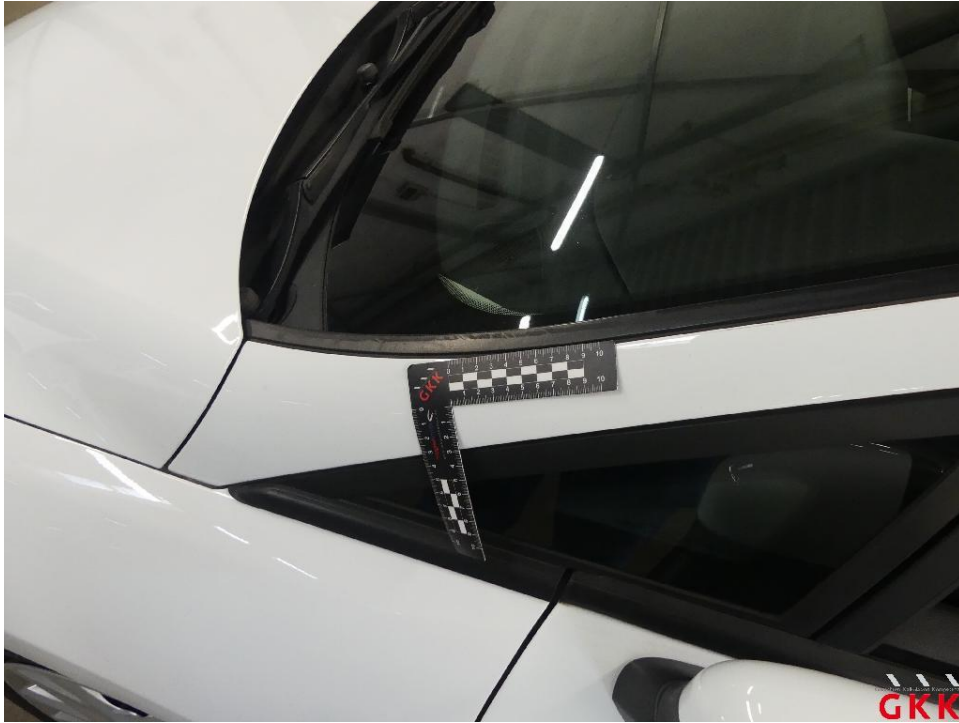
Bild 15 Frontscheibe, Leiste -links-, verkratzt, ersetzen
