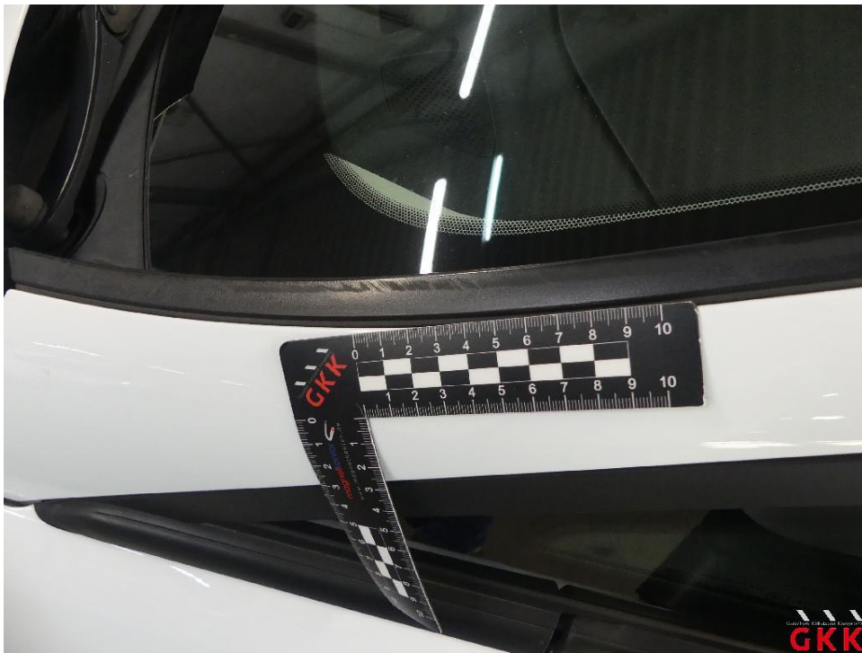
Bild 16 Frontscheibe, Leiste -links-, verkratzt, ersetzen
