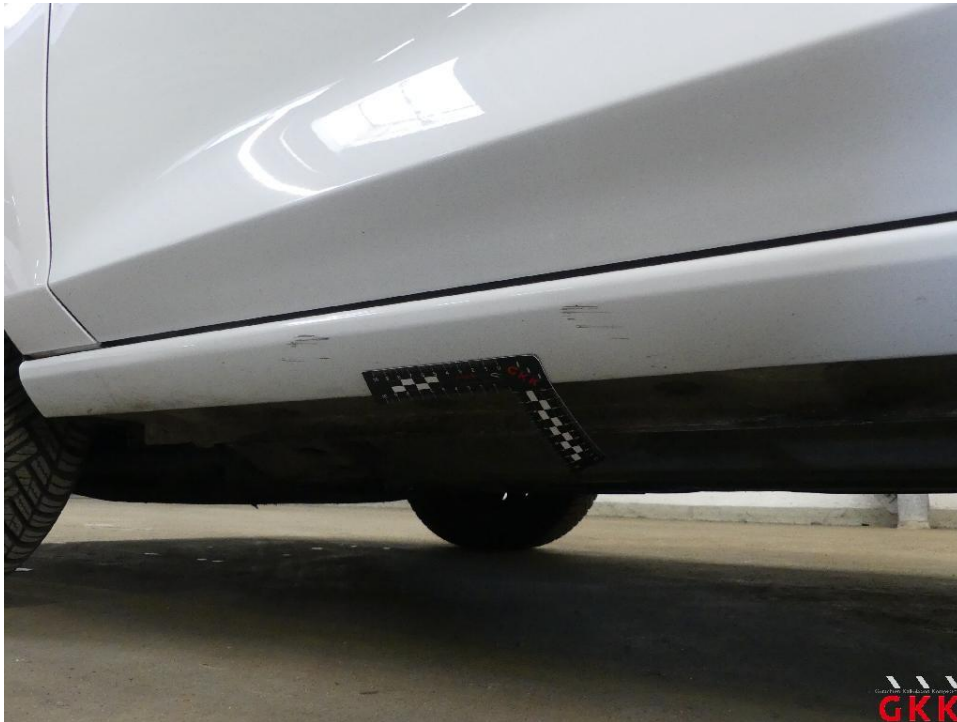
Bild 29 Schweller links, beschädigt, instand setzen - lackieren
