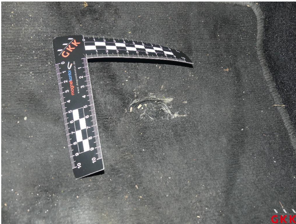
Bild 28 Fußmatte(n), vorne links, beschädigt, ersetzen
