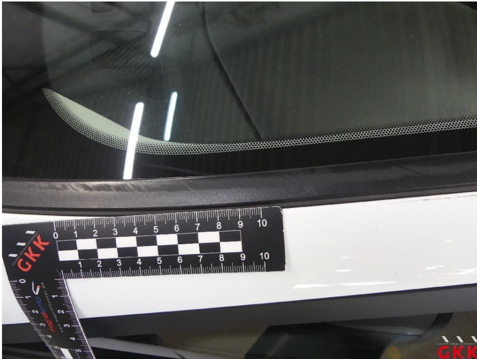
Bild 17 Frontscheibe, Leiste -links-, verkratzt, ersetzen
