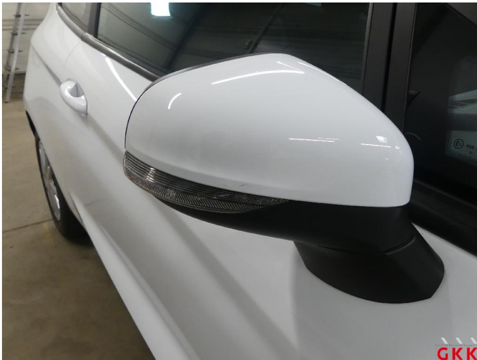
Bild 32 Spiegelgehäuse rechts, Blinker, verkratzt, ersetzen
