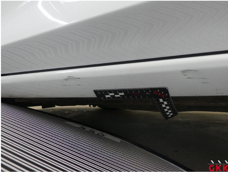
Bild 31 Schweller links, beschädigt, instand setzen - lackieren
