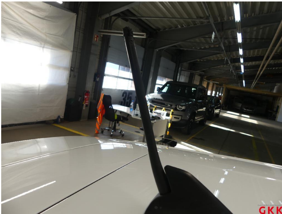
Bild 18 Antenne, Stab, beschädigt, ersetzen
