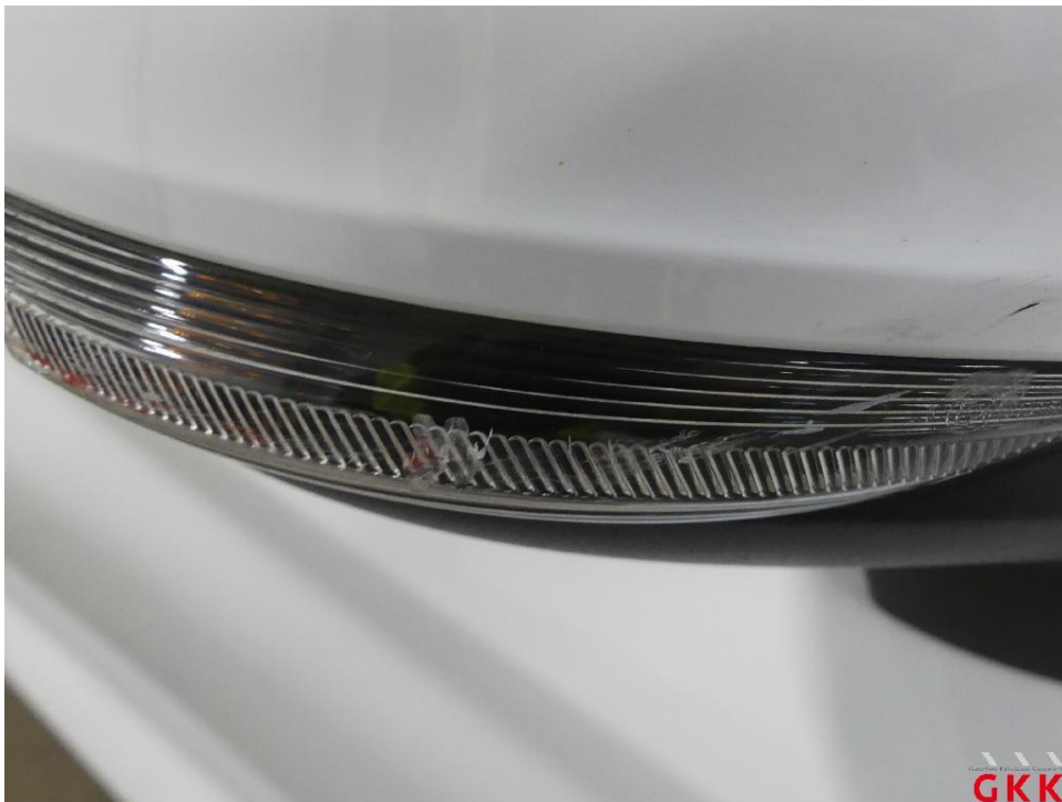
Bild 34 Spiegelgehäuse rechts, Blinker, verkratzt, ersetzen
