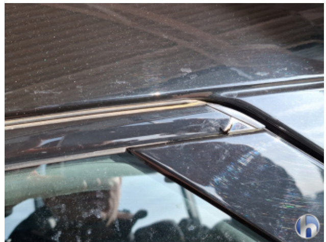
5. Tür Hinten - Links Beschädigt - Erneuern
