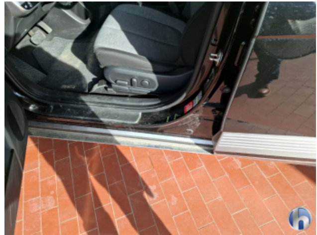
2. Türeinstieg Vorne - Links 3 Dellen - Smart Repair
