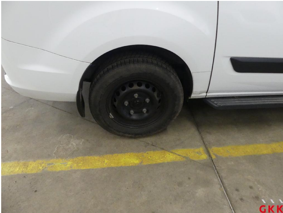
Bild 23 Radkappe(n), hinten rechts, fehlt, ersetzen
