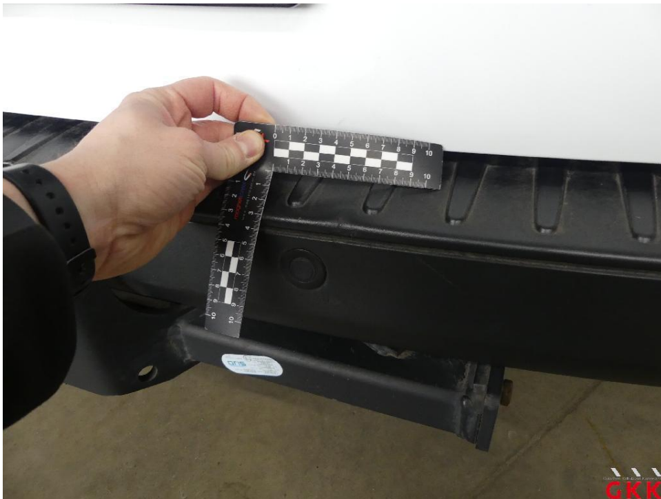
Bild 24 Stoßfänger hinten, Verkleidung -unlackiert-, aufgeworfen, ersetzen
