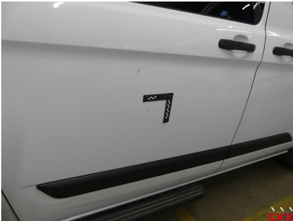
Bild 18 Schiebetür rechts, beschädigt, instand setzen - lackieren
