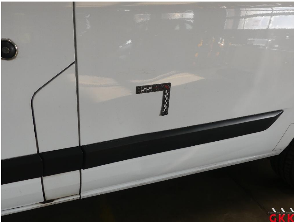
Bild 30 Seitenwand links, beschädigt, instand setzen - lackieren
