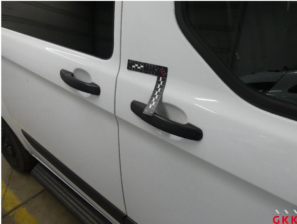
Bild 15 Tür vorne rechts, beschädigt, instand setzen - lackieren
