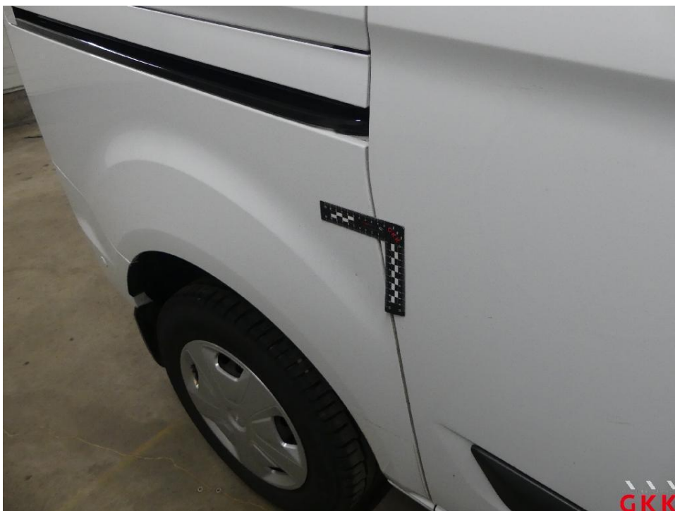
Bild 14 Seitenwand rechts, beschädigt, instand setzen - lackieren
