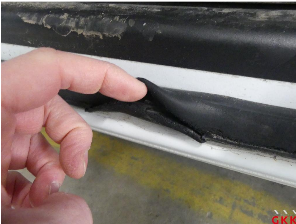
Bild 22 Tür vorne links, Dichtung -Einstieg-, gerissen, ersetzen
