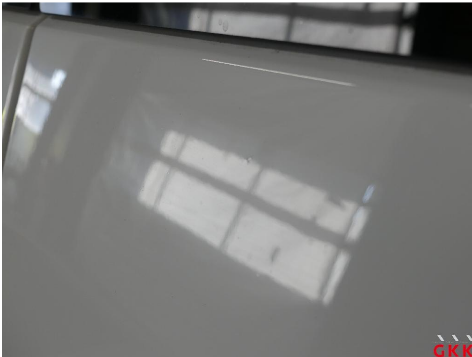
Bild 24 Hecktür rechts, Reparaturmangel, polieren
