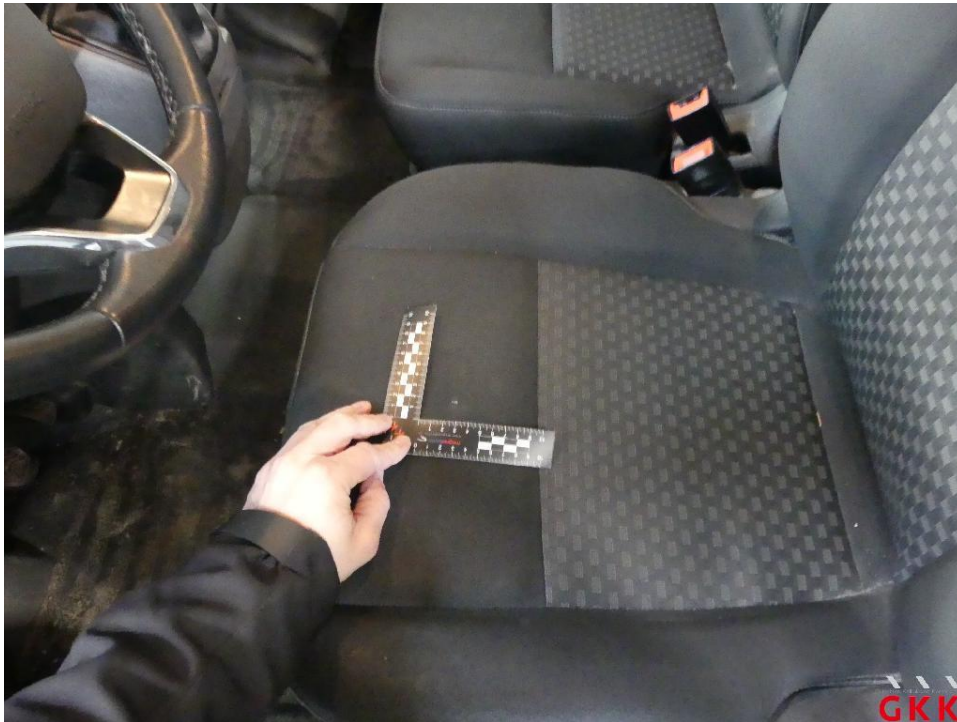
Bild 17 Sitz vorne links, Bezug Sitzkissen -Stoff-, Brandloch, Smartrepair
