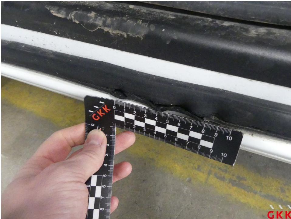
Bild 21 Tür vorne links, Dichtung -Einstieg-, gerissen, ersetzen
