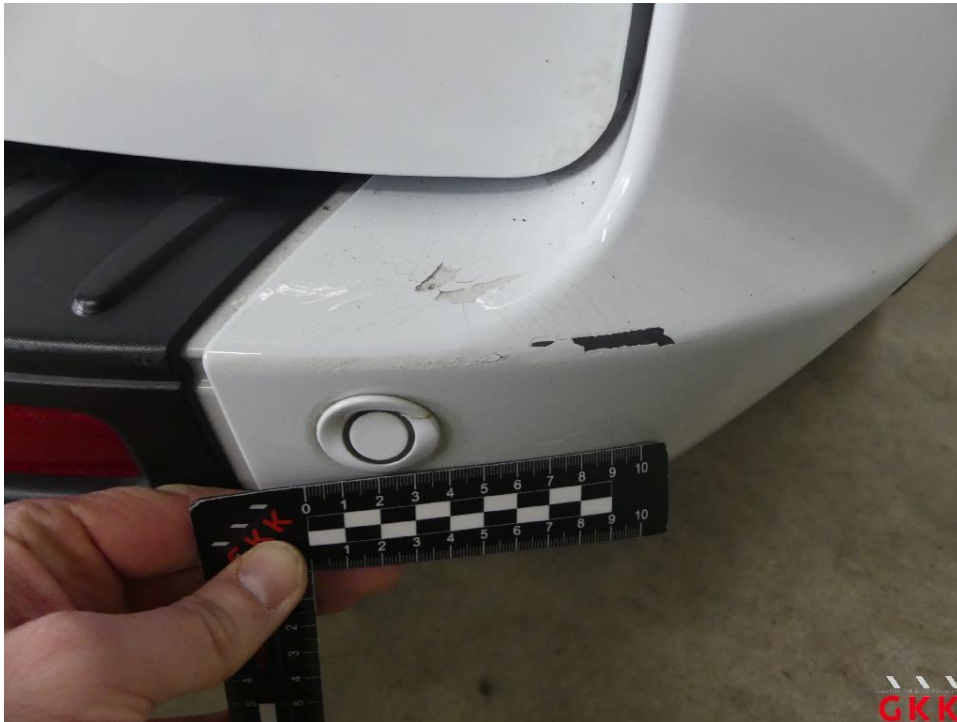
Bild 35 Stoßfänger hinten, Ecke rechts -lackiert-, beschädigt, ersetzen
