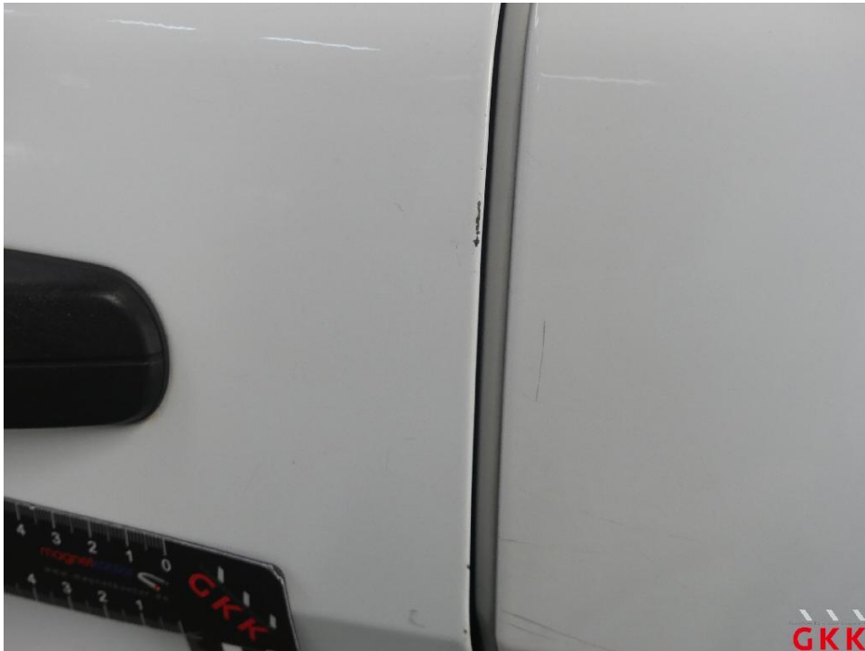
Bild 45 Tür vorne links, Kante, verkratzt, auslegen, schleifen, polieren
