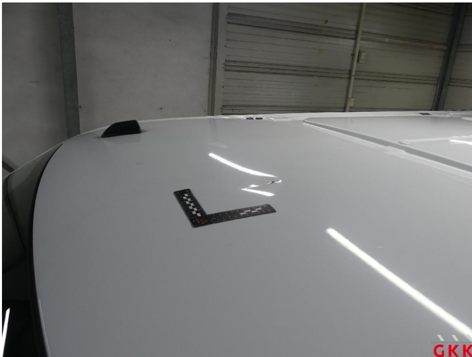
Bild 26 Dach, beschädigt, instand setzen - lackieren
