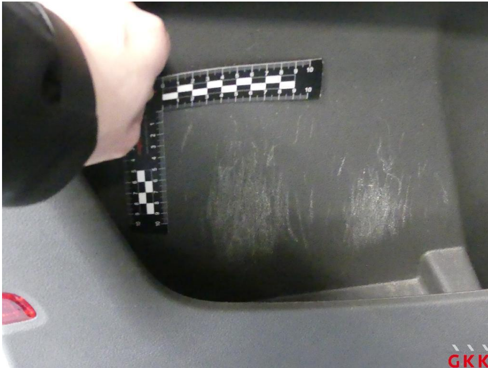
Bild 47 Tür vorne links, Innenverkleidung -Abdeckung-, verkratzt, ersetzen
