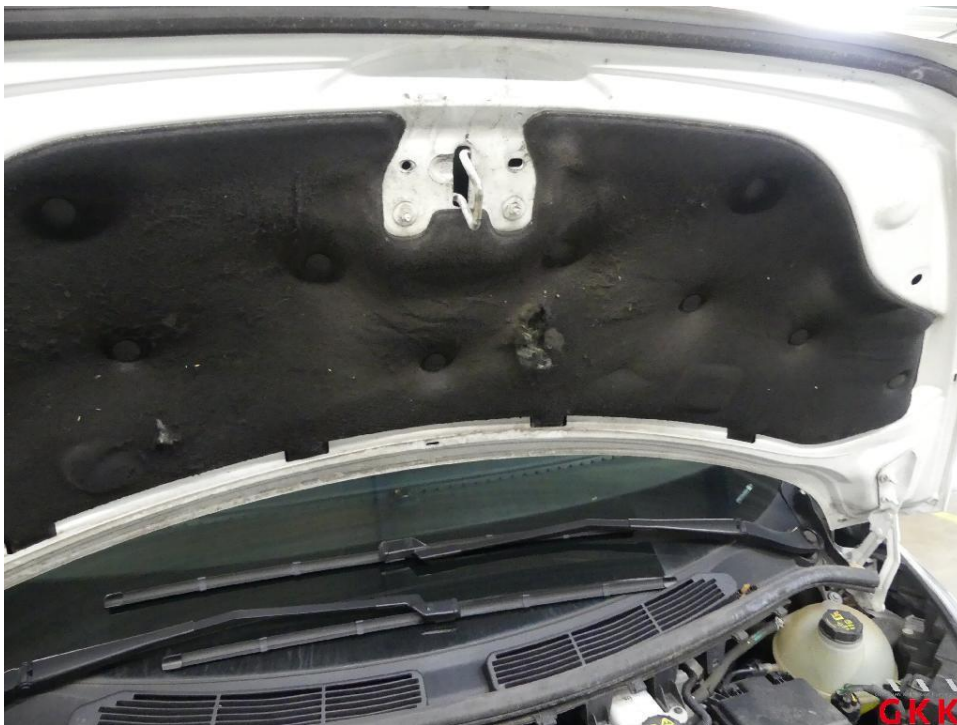
Bild 14 Motorhaube, Dämmmatte, beschädigt, ersetzen
