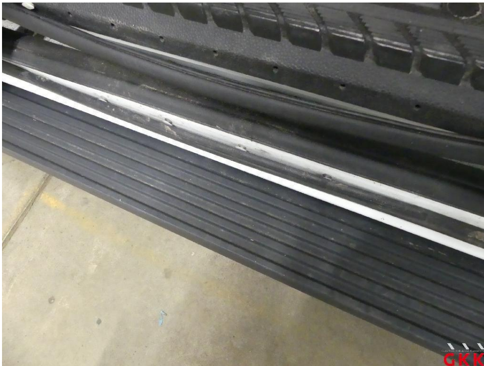
Bild 24 Schiebetür rechts, Dichtung -Einstieg-, lose, ersetzen
