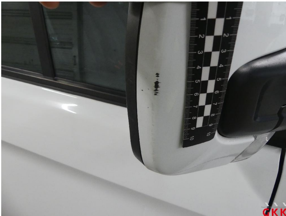
Bild 20 Spiegelgehäuse rechts, Kappe -lackiert-, verkratzt, lackieren ohne LV
