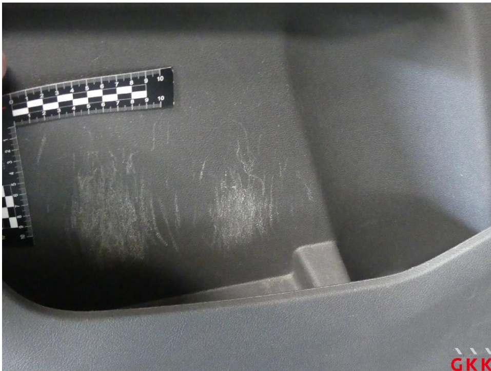
Bild 48 Tür vorne links, Innenverkleidung -Abdeckung-, verkratzt, ersetzen
