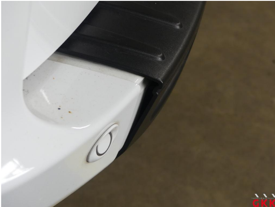
Bild 39 Stoßfänger hinten, Verkleidung -unlackiert-, beschädigt, instand setzen
