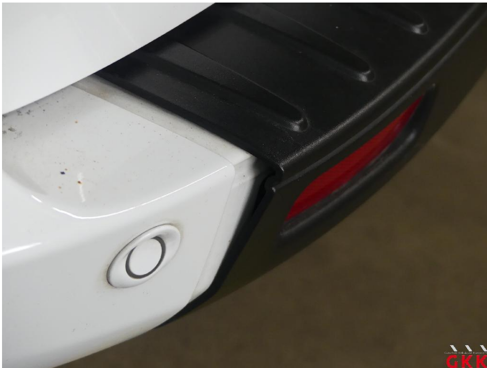
Bild 38 Stoßfänger hinten, Verkleidung -unlackiert-, beschädigt, instand setzen
