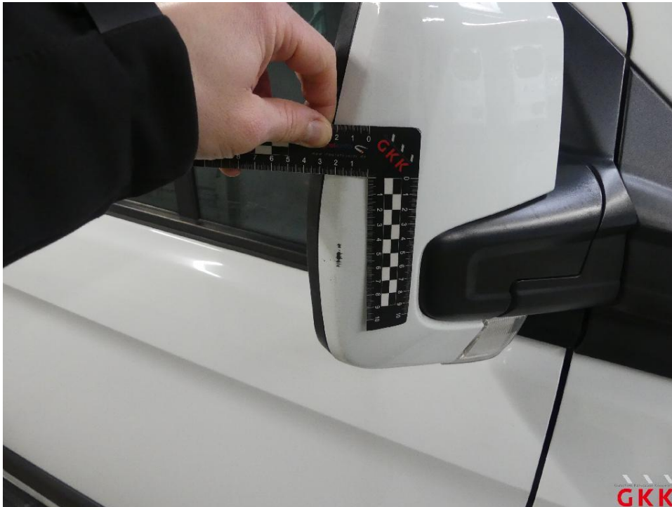
Bild 19 Spiegelgehäuse rechts, Kappe -lackiert-, verkratzt, lackieren ohne LV
