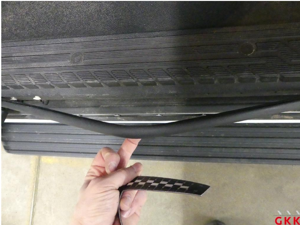
Bild 23 Schiebetür rechts, Dichtung -Einstieg-, lose, ersetzen
