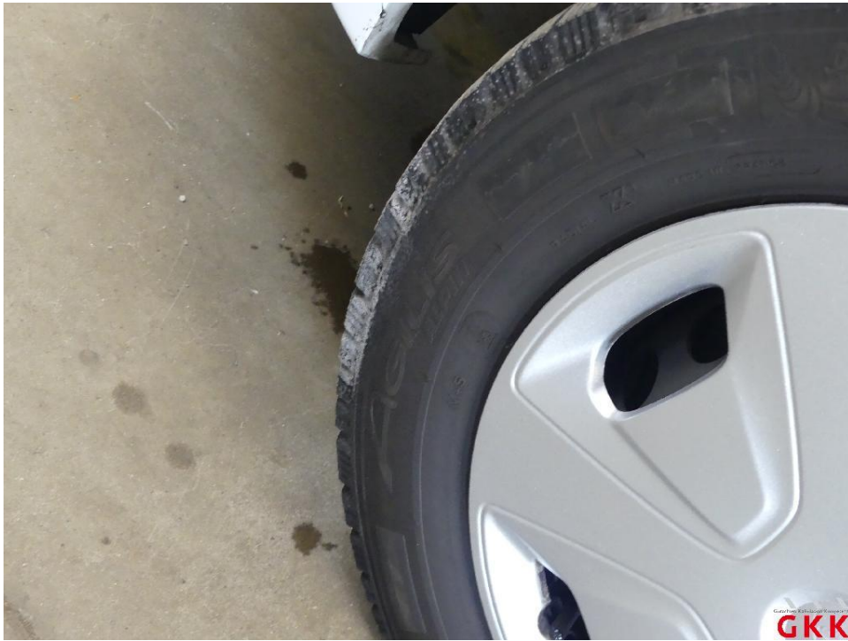
Bild 49 Reifen, vorn links und rechts, falsche Reifenart, ersetzen
