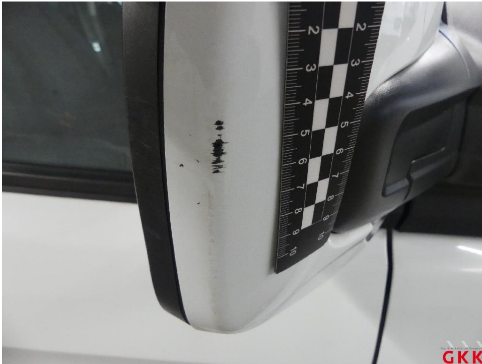
Bild 21 Spiegelgehäuse rechts, Kappe -lackiert-, verkratzt, lackieren ohne LV
