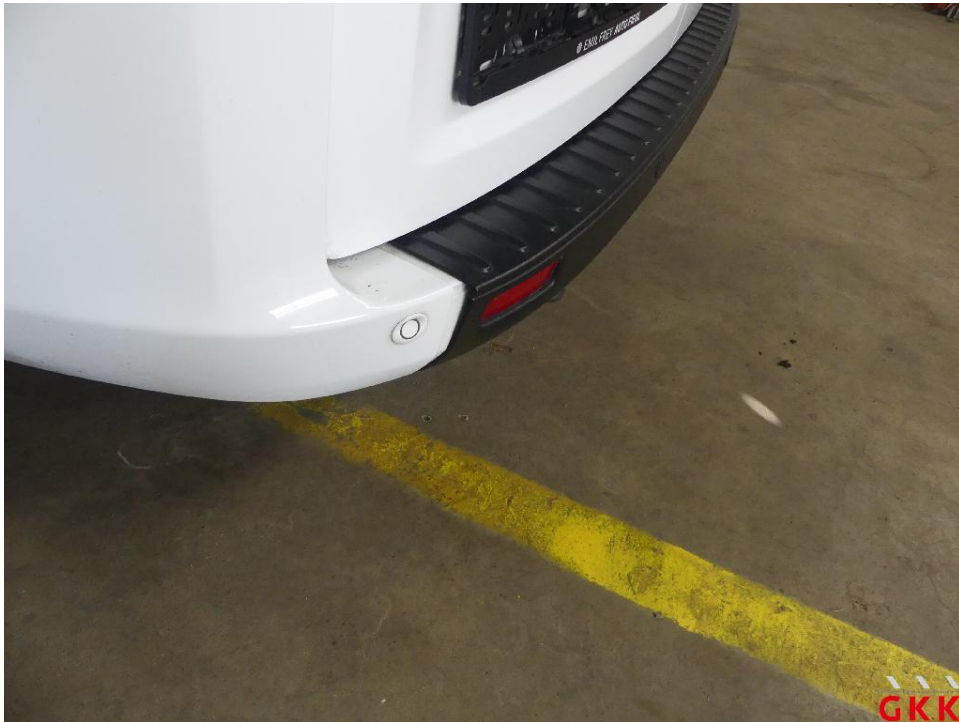
Bild 37 Stoßfänger hinten, Verkleidung -unlackiert-, beschädigt, instand setzen
