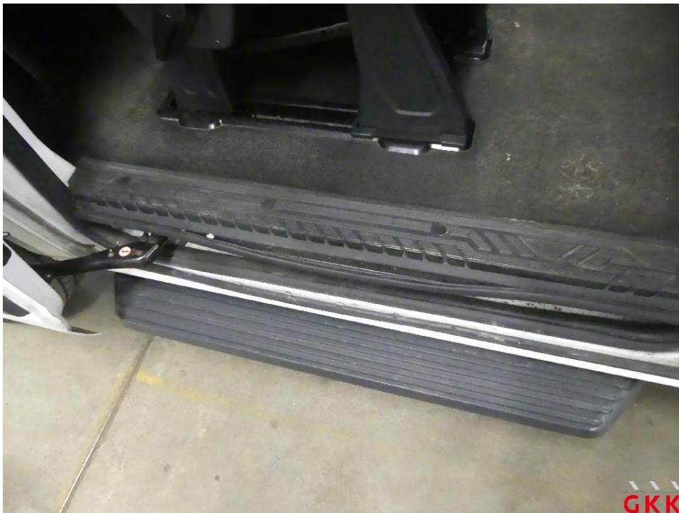
Bild 22 Schiebetür rechts, Dichtung -Einstieg-, lose, ersetzen
