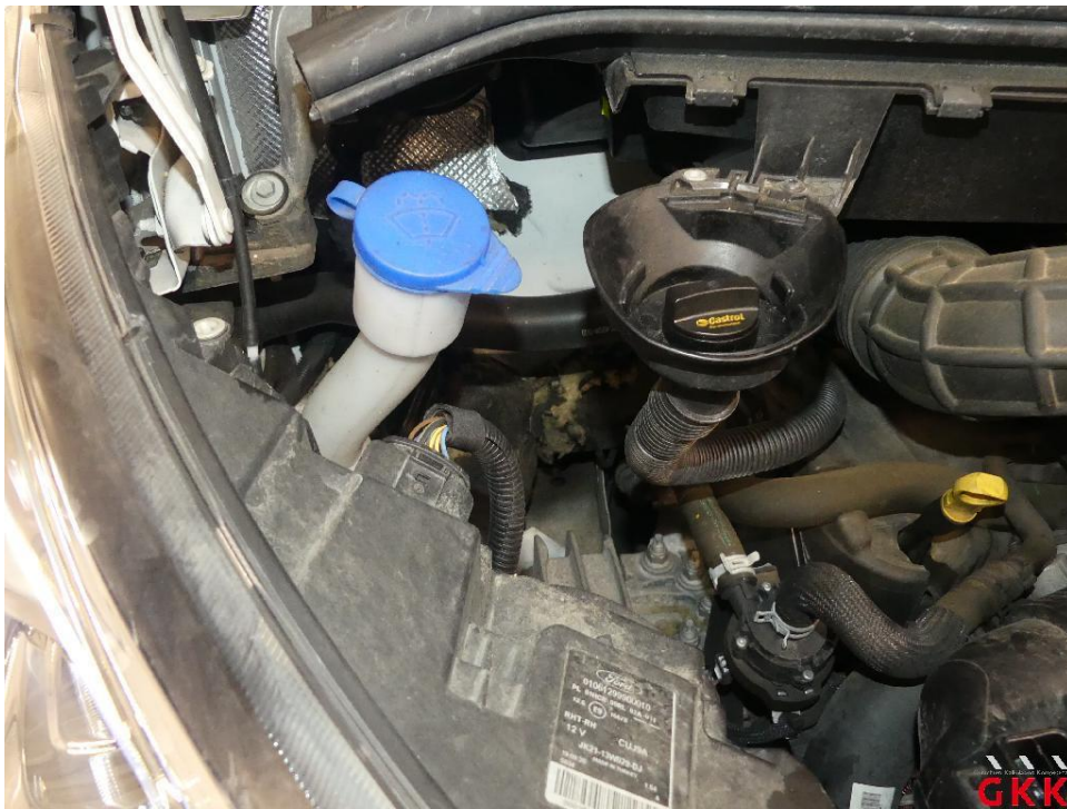
Bild 16 Motorraum, Dämmmatte, beschädigt, ersetzen
