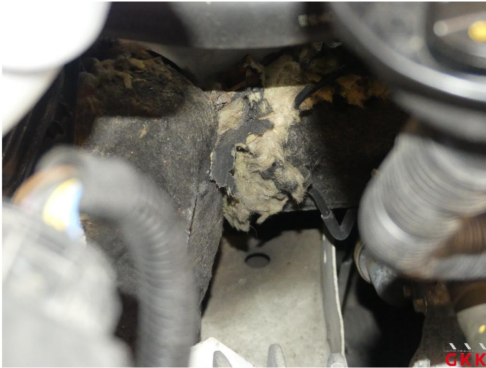
Bild 17 Motorraum, Dämmmatte, beschädigt, ersetzen
