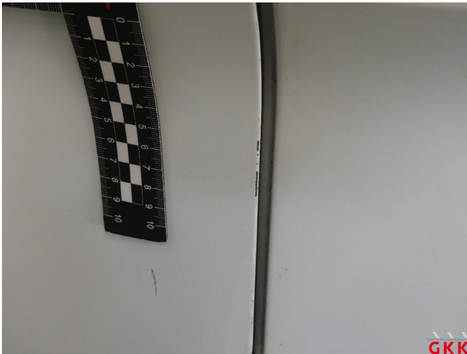
Bild 44 Tür vorne links, Kante, verkratzt, auslegen, schleifen, polieren
