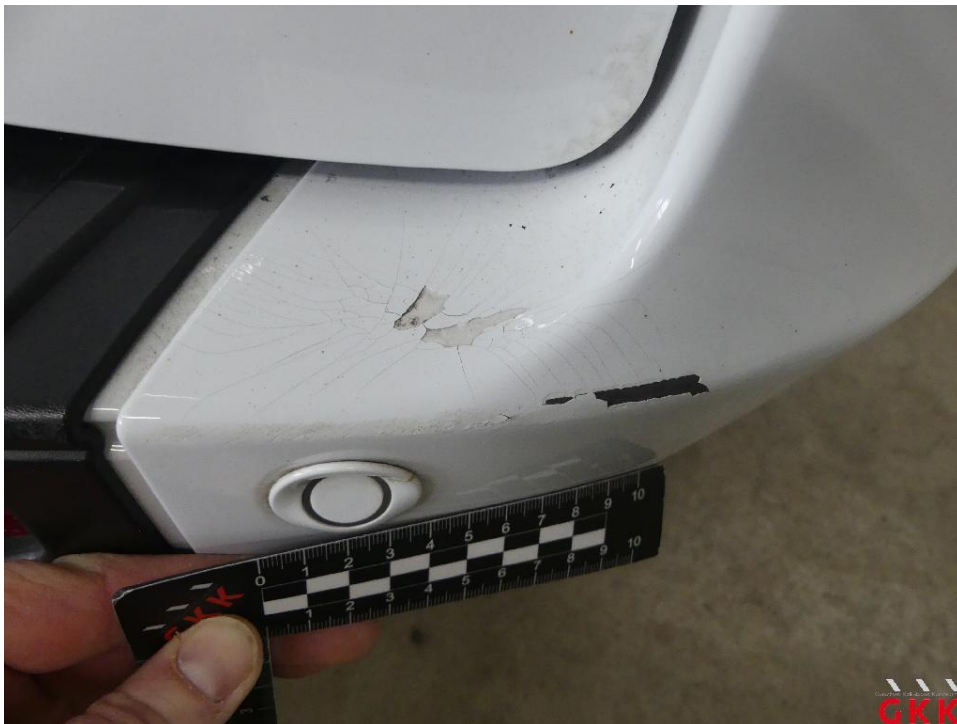
Bild 36 Stoßfänger hinten, Ecke rechts -lackiert-, beschädigt, ersetzen
