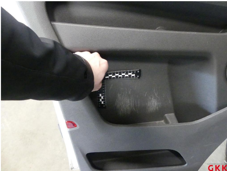
Bild 46 Tür vorne links, Innenverkleidung -Abdeckung-, verkratzt, ersetzen
