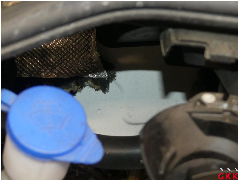
Bild 18 Motorraum, Dämmmatte, beschädigt, ersetzen
