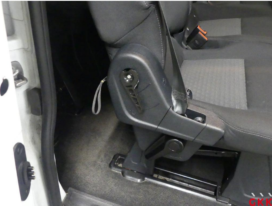
Bild 29 Sitz hinten rechts, Griff, beschädigt, ersetzen
