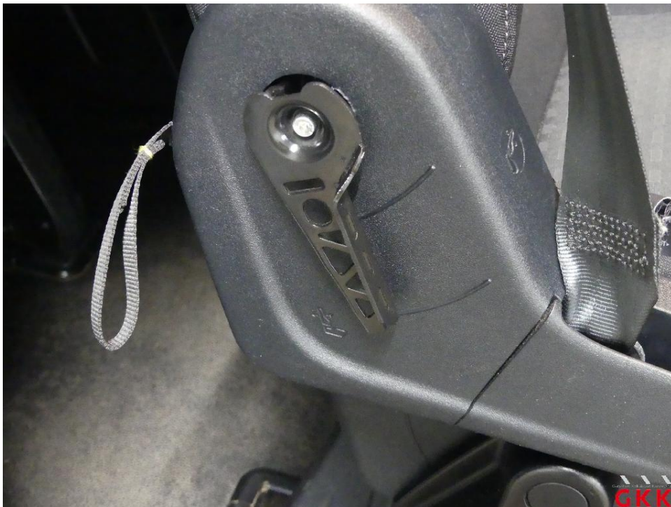
Bild 30 Sitz hinten rechts, Griff, beschädigt, ersetzen
