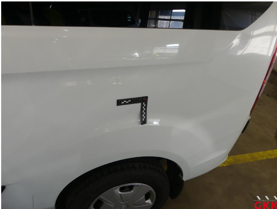
Bild 40 Seitenwand links, beschädigt, instand setzen - lackieren
