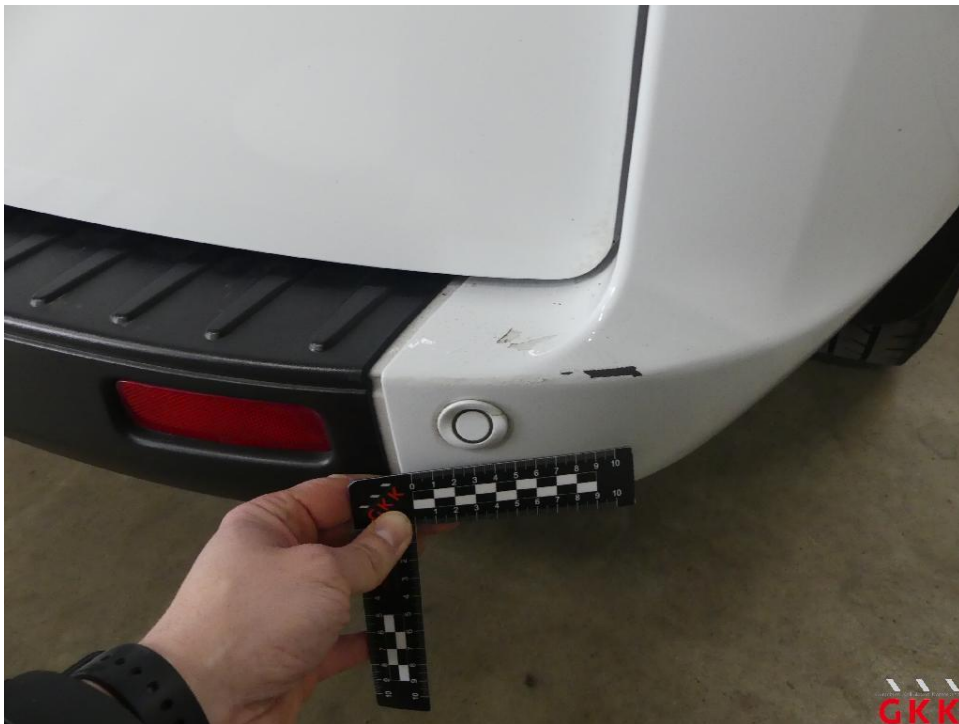
Bild 34 Stoßfänger hinten, Ecke rechts -lackiert-, beschädigt, ersetzen
