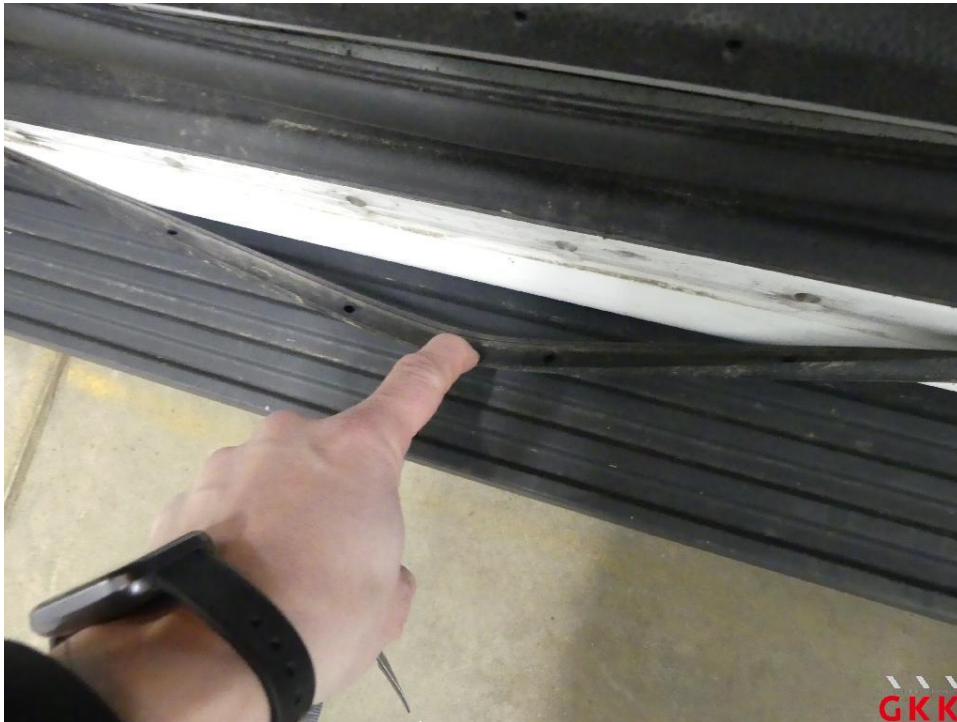
Bild 25 Schiebetür rechts, Dichtung -Einstieg-, lose, ersetzen
