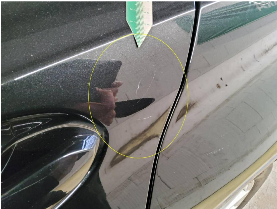
Bild 14 : Tür hinten links Lackierung, zerkratzt, lackieren mit Lackaufbau
