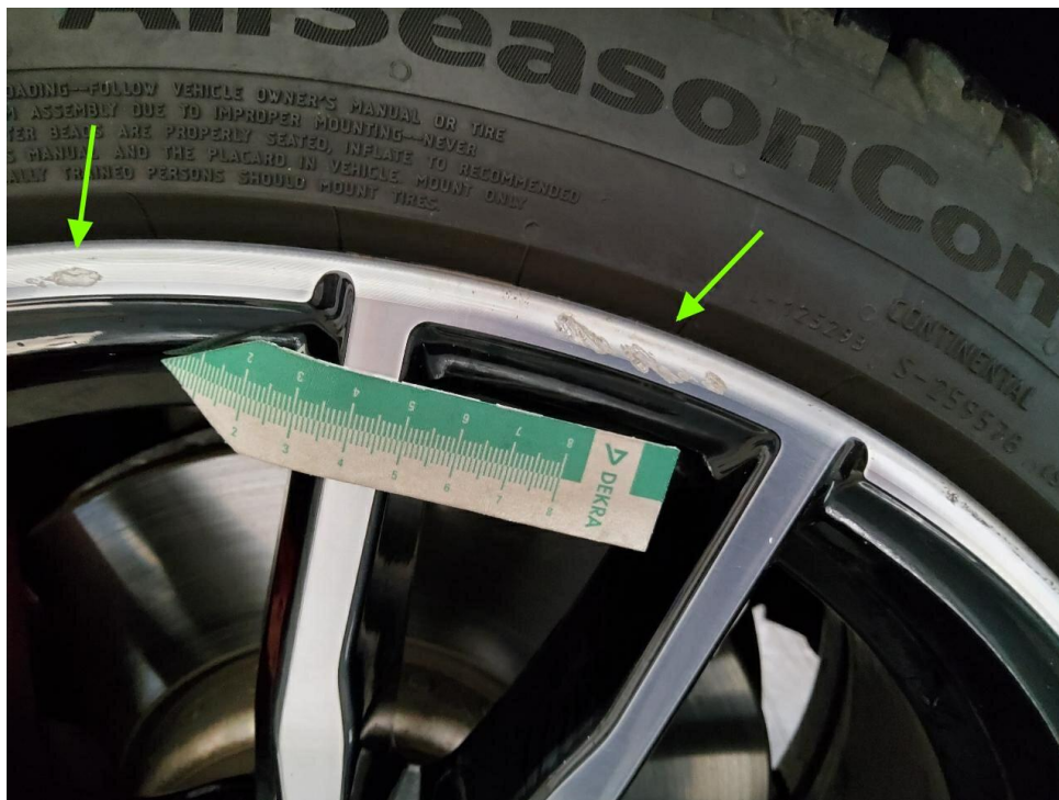
Bild 11 : Felge vorne rechts verschrammt (glanzgedreht)
