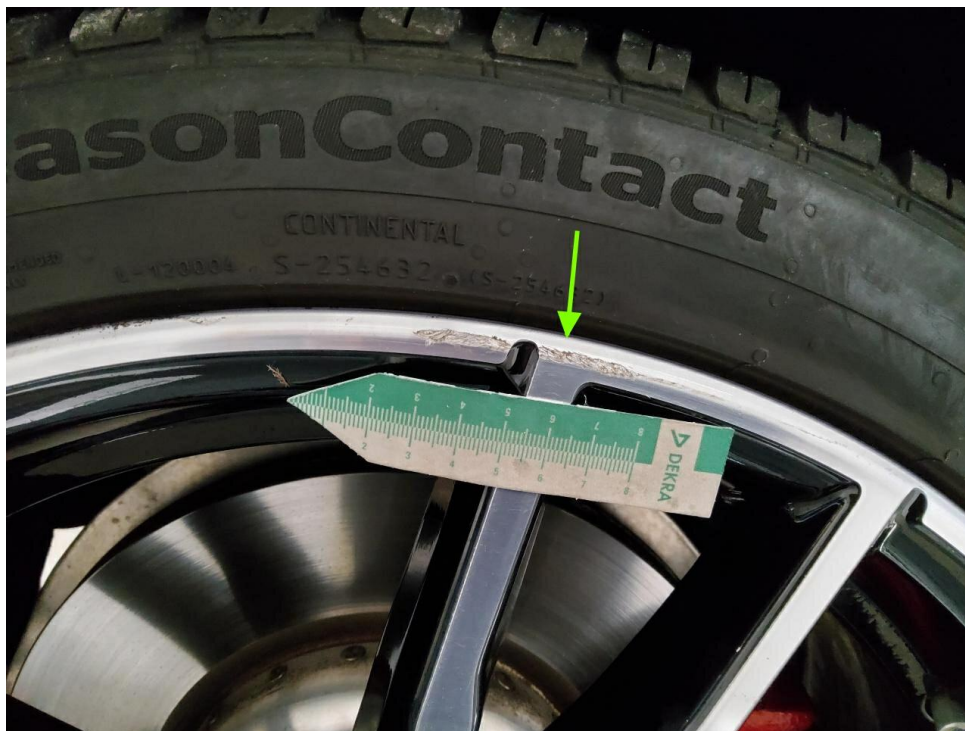
Bild 12 : Felge hinten rechts verschrammt (glanzgedreht)
