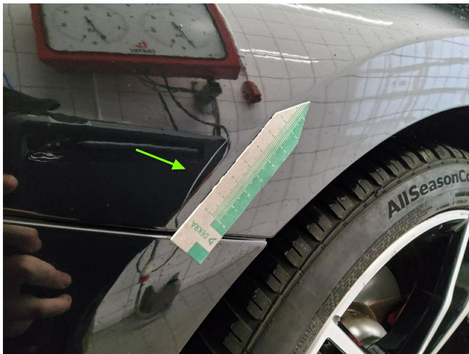
Bild 7 : Seitenteil hinten rechts Lackierung, verschrammt, lackieren mit Lackaufbau
