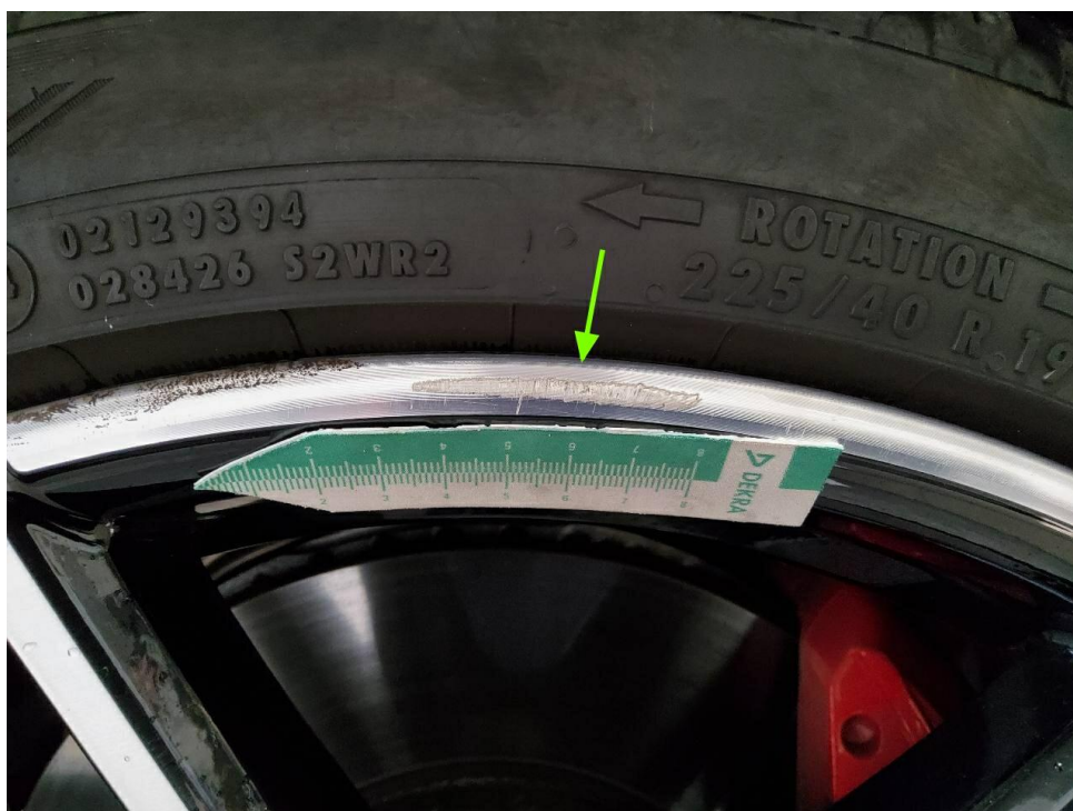
Bild 14 : Felge vorne links verschrammt (glanzgedreht)
