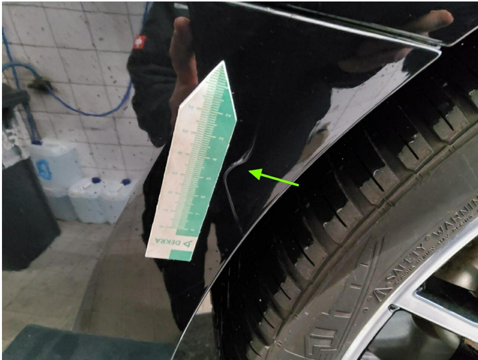
Bild 9 : Stoßfänger hinten, verschrammt, smart repair
