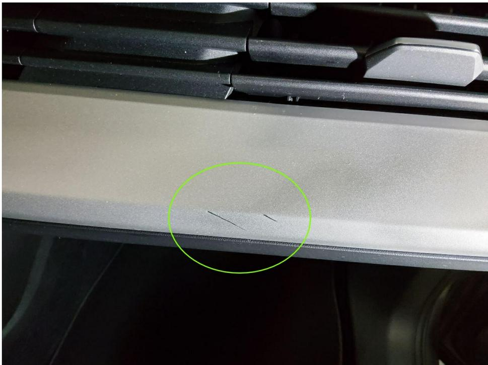
Bild 14 : Armaturenbrett e-tron zierleiste verschrammt
