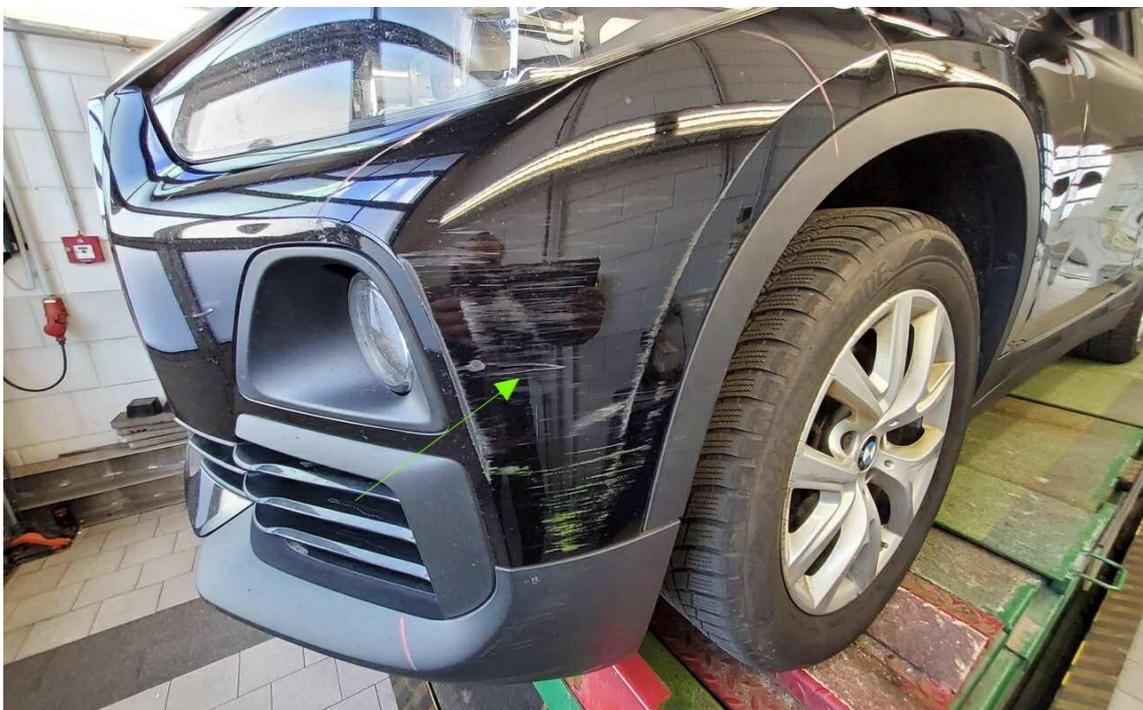
Bild 24 : Stoßfänger vorne mehrfach angefahren, Kühlergitter beschädigt
