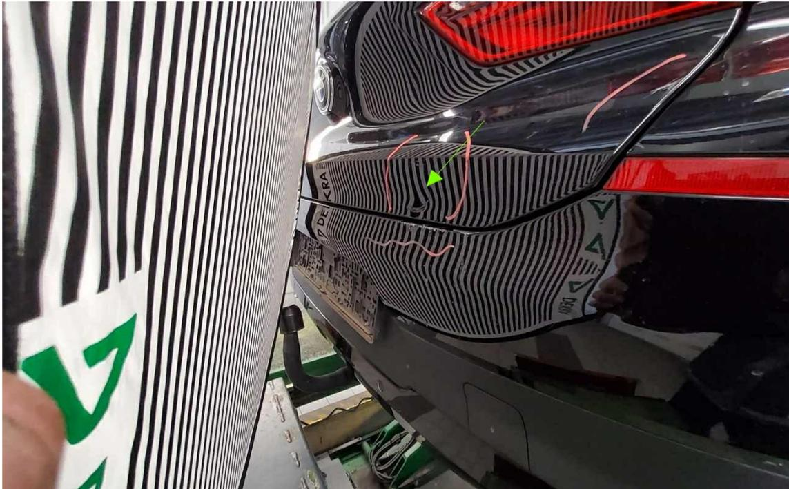
Bild 21 : Heckklappe Deformiert
