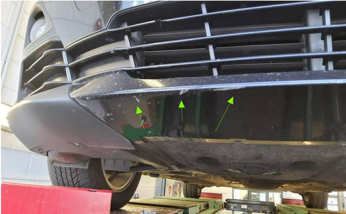
Bild 25 : Stoßfänger vorne mehrfach angefahren, Kühlergitter beschädigt
