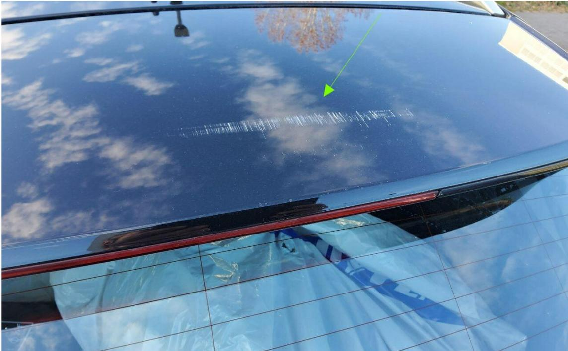
Bild 29 : Heckspoiler verschrammt
