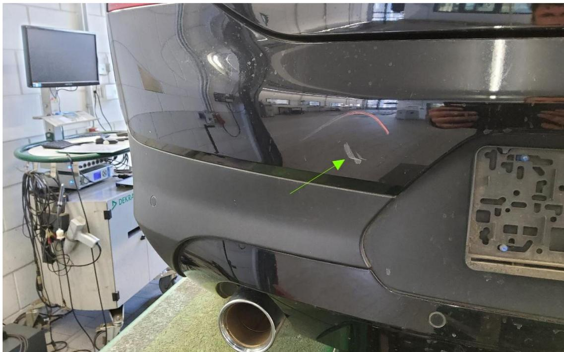
Bild 15 : Stoßfänger hinten mehrfach angefahren
