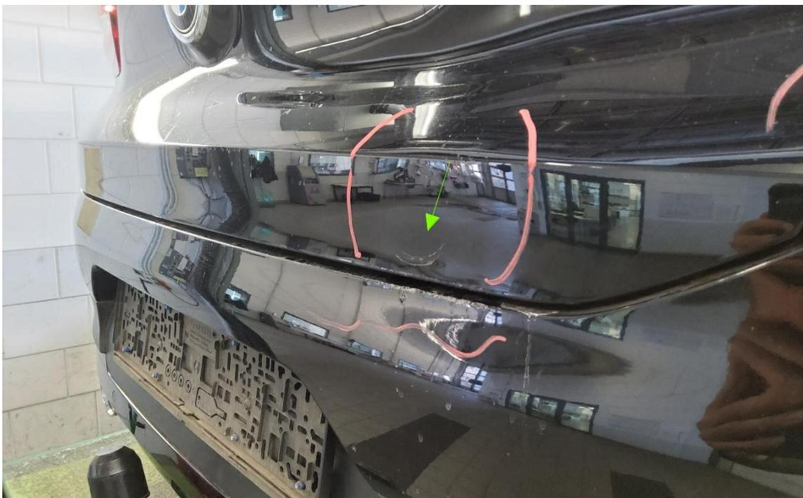
Bild 20 : Heckklappe Deformiert
