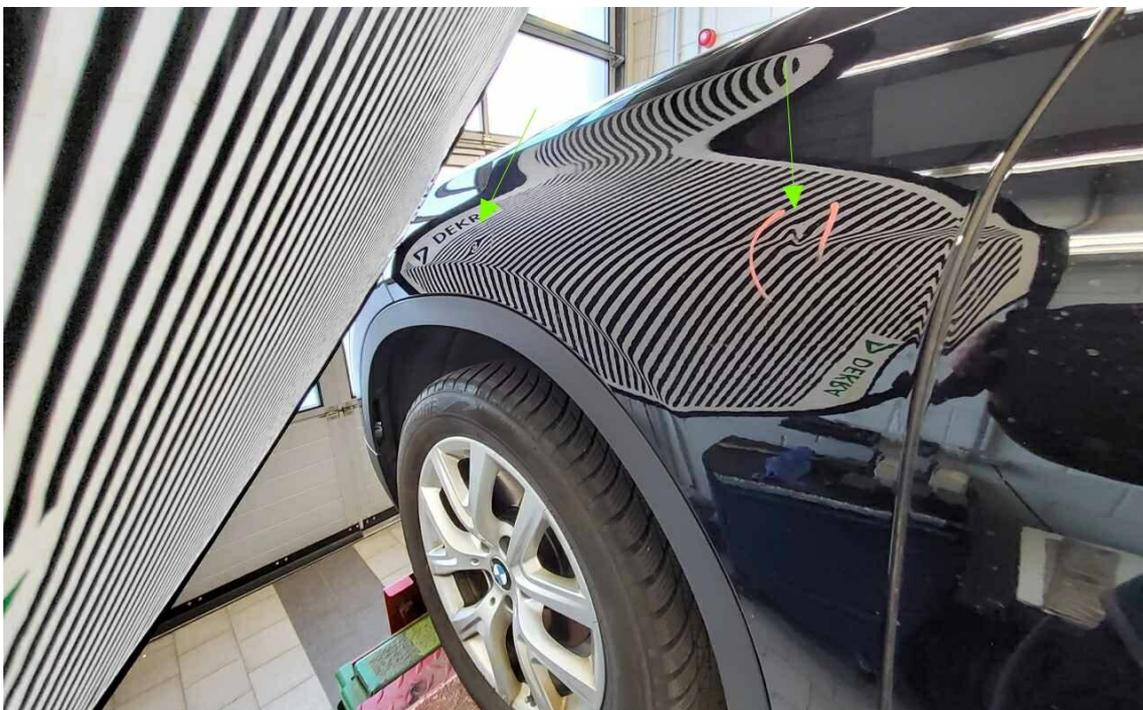
Bild 14 : Kotflügel links verdellt
