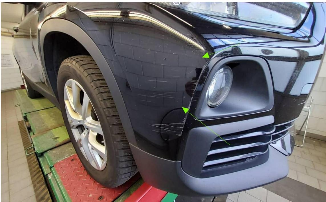
Bild 22 : Stoßfänger vorne mehrfach angefahren, Kühlergitter beschädigt
