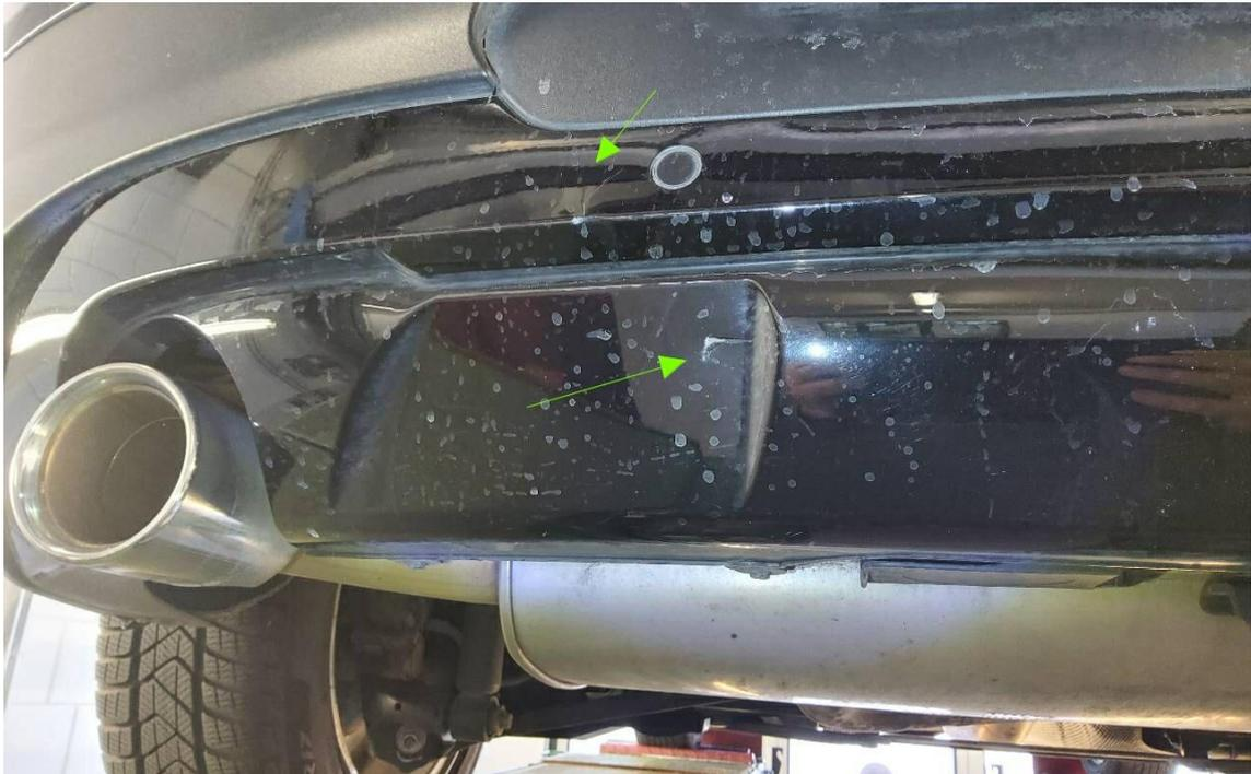
Bild 19 : Stoßfänger hinten mehrfach angefahren
