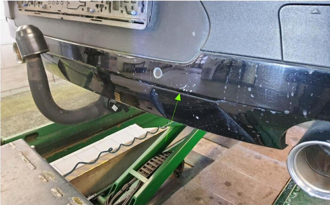
Bild 17 : Stoßfänger hinten mehrfach angefahren
