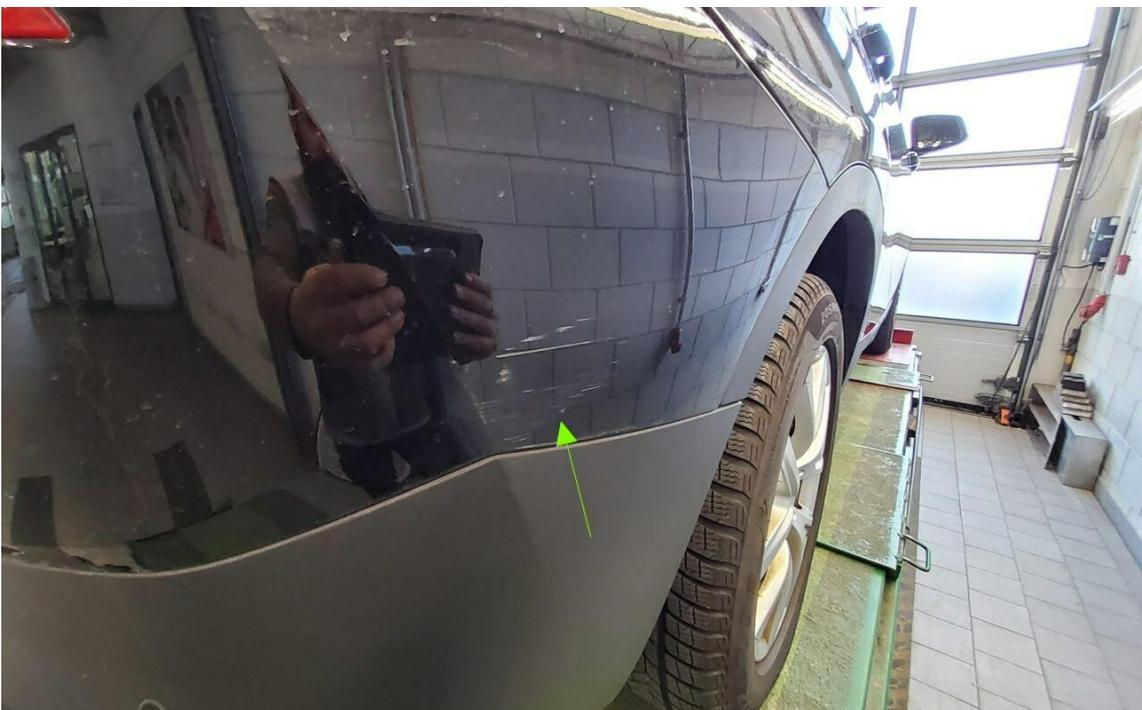
Bild 18 : Stoßfänger hinten mehrfach angefahren
