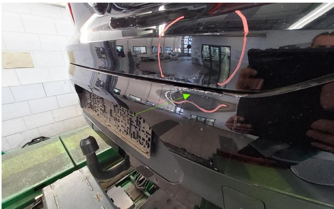
Bild 16 : Stoßfänger hinten mehrfach angefahren
