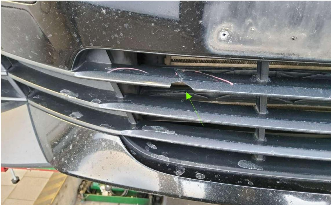
Bild 23 : Stoßfänger vorne mehrfach angefahren, Kühlergitter beschädigt
