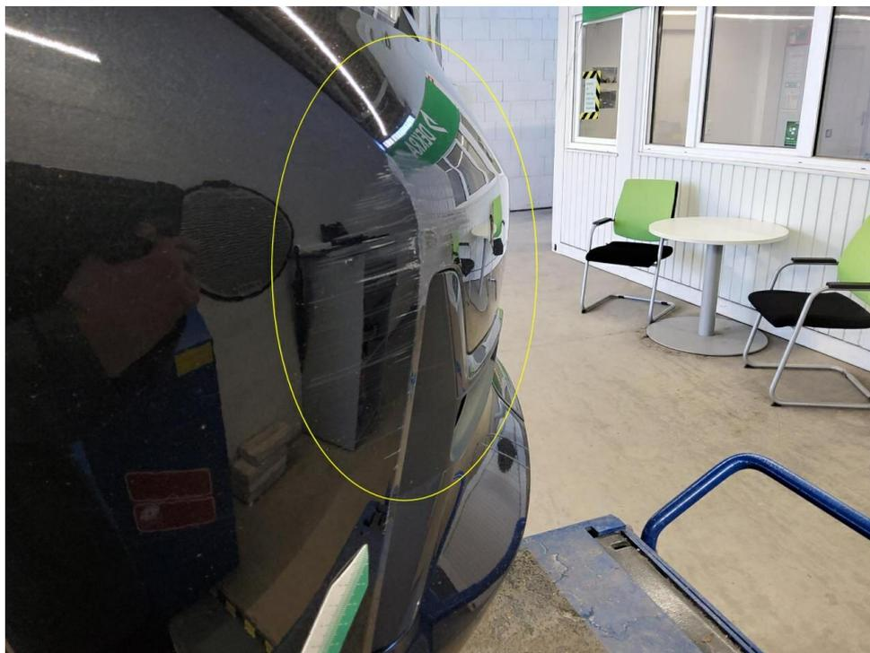
Bild 14 : Stoßfänger vorne Lackierung, zerkratzt, lackieren mit Lackaufbau
