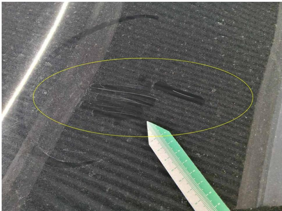
Bild 15 : Heckdeckel Lackierung, zerkratzt, lackieren mit Lackaufbau
