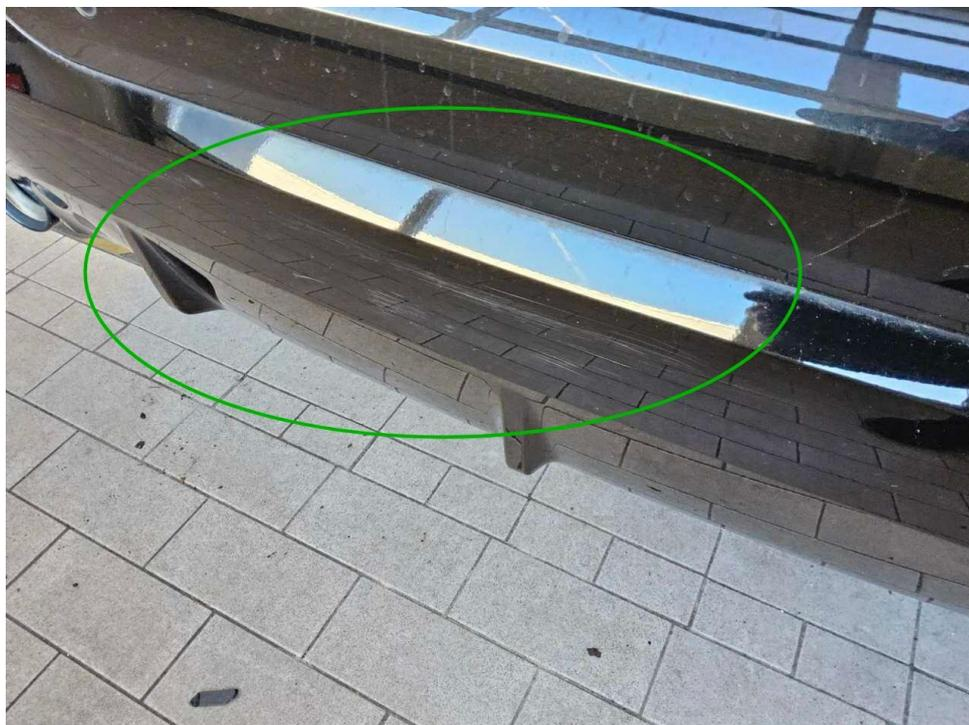
Bild 18 : Heckschürze hinten unten Lackierung, verschrämmt
