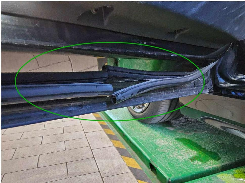
Bild 22 : Türdichtung vorne links beschädigt
