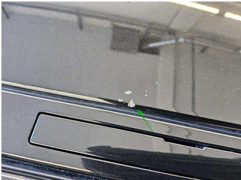
Bild 17 : Dach Lackierung, Steinschlag
