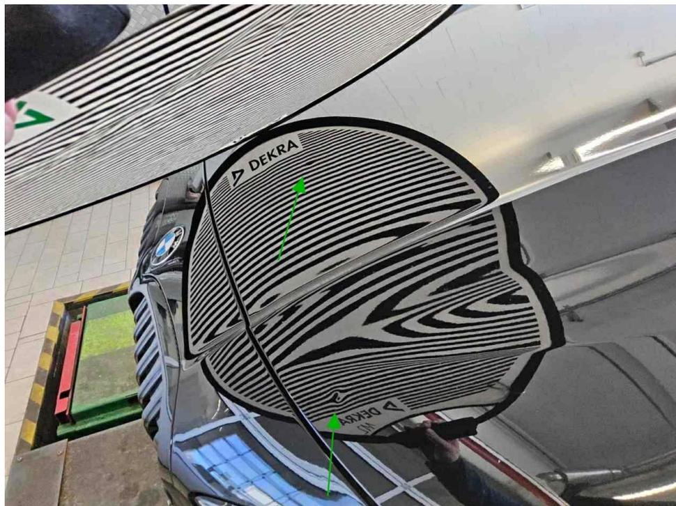
Bild 13 : Motorhaube, mehrfach eingedellt
