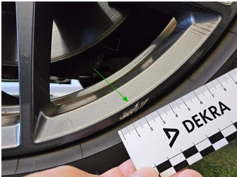
Bild 19 : Felge vorne rechts, verschrammt
