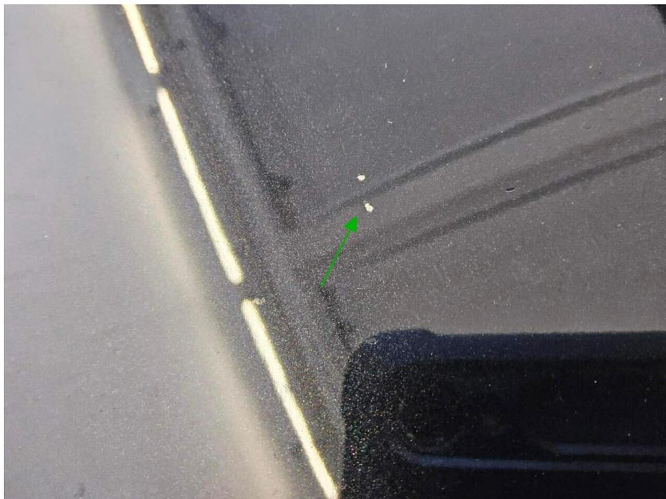
Bild 15 : Motorhaube Lackierung, Steinschlag
