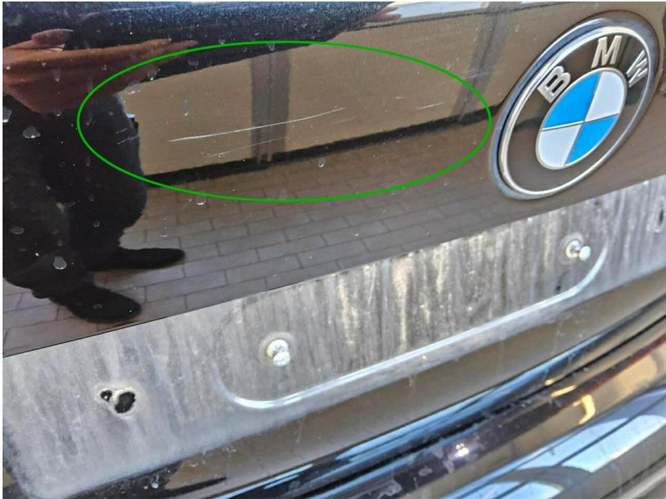
Bild 21 : Heckdeckel Lackierung, zerkratzt
