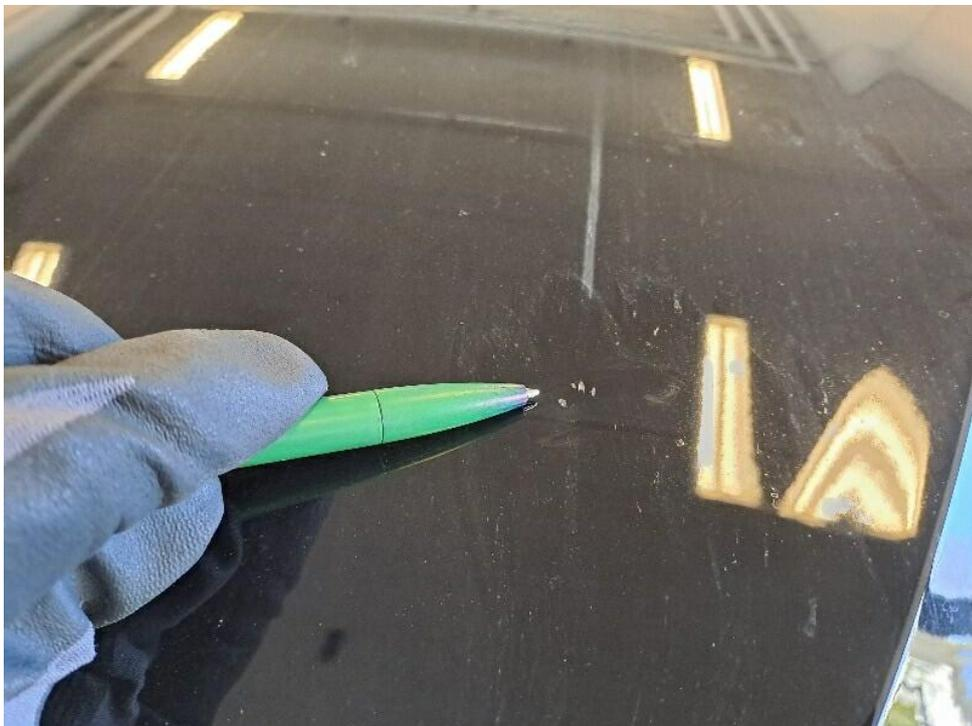
Bild 16 : Motorhaube Steinschlag
