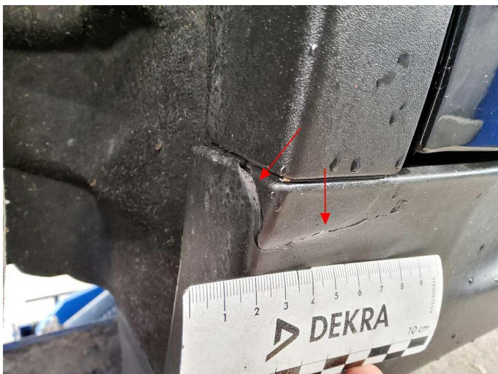
Bild 19 : Verkleidung Schweller rechts, gebrochen
