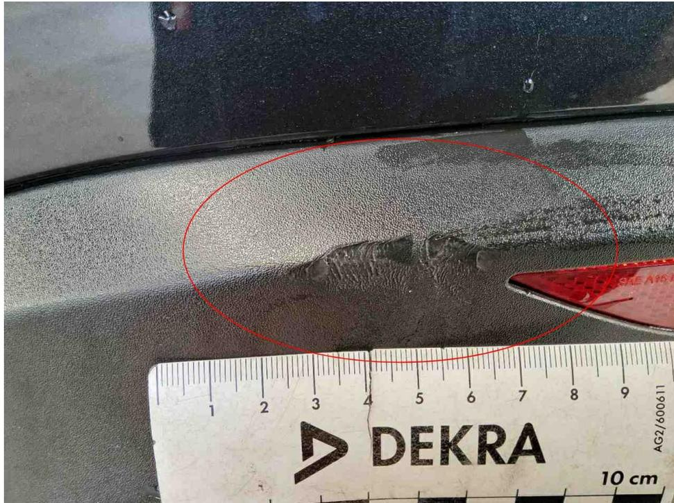
Bild 22 : Schaden Stoßfänger hinten, Heckklappe
