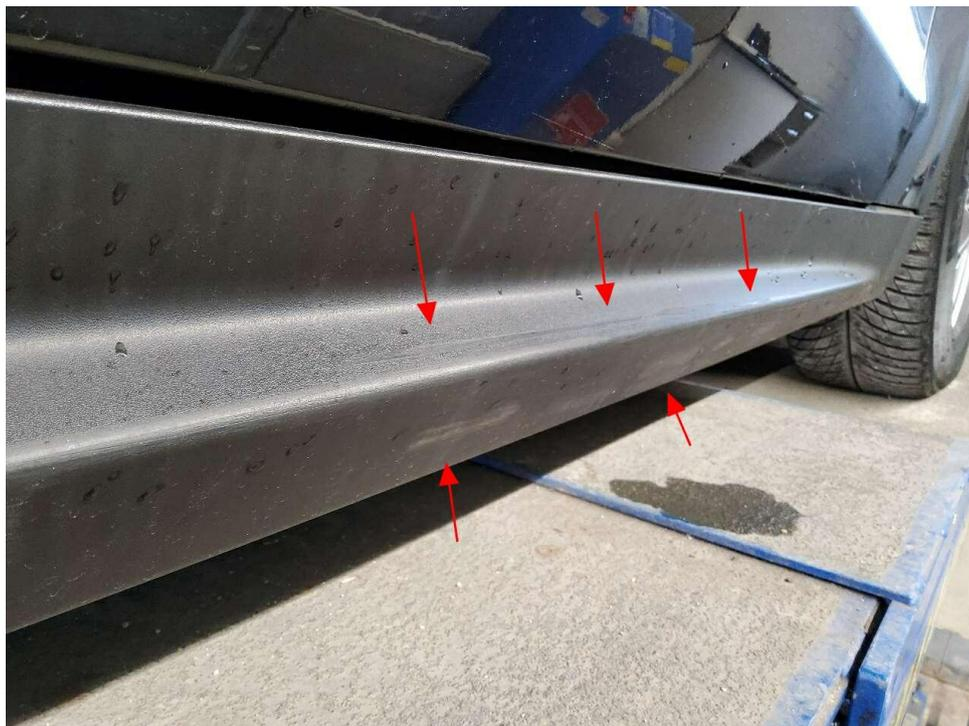
Bild 16 : Verkleidung Schweller rechts, gebrochen
