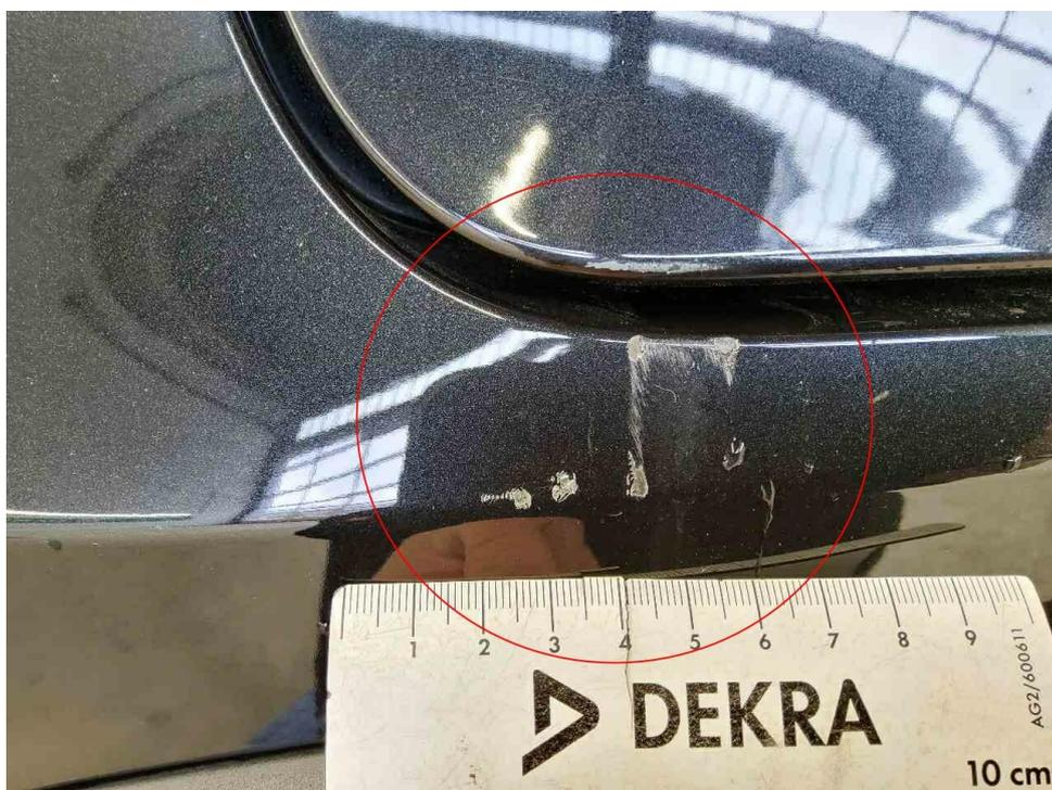
Bild 21 : Schaden Stoßfänger hinten, Heckklappe
