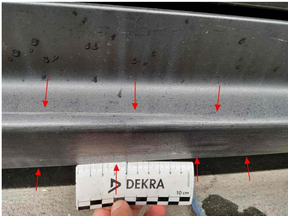
Bild 18 : Verkleidung Schweller rechts, gebrochen
