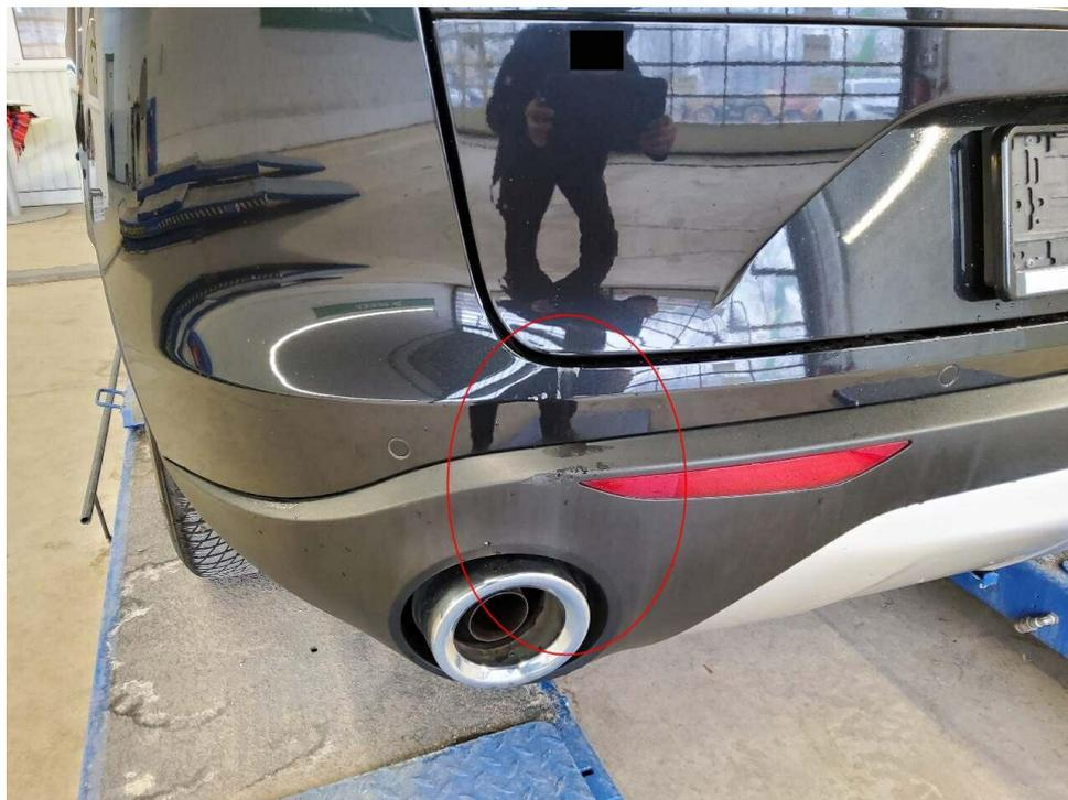
Bild 20 : Schaden Stoßfänger hinten, Heckklappe
