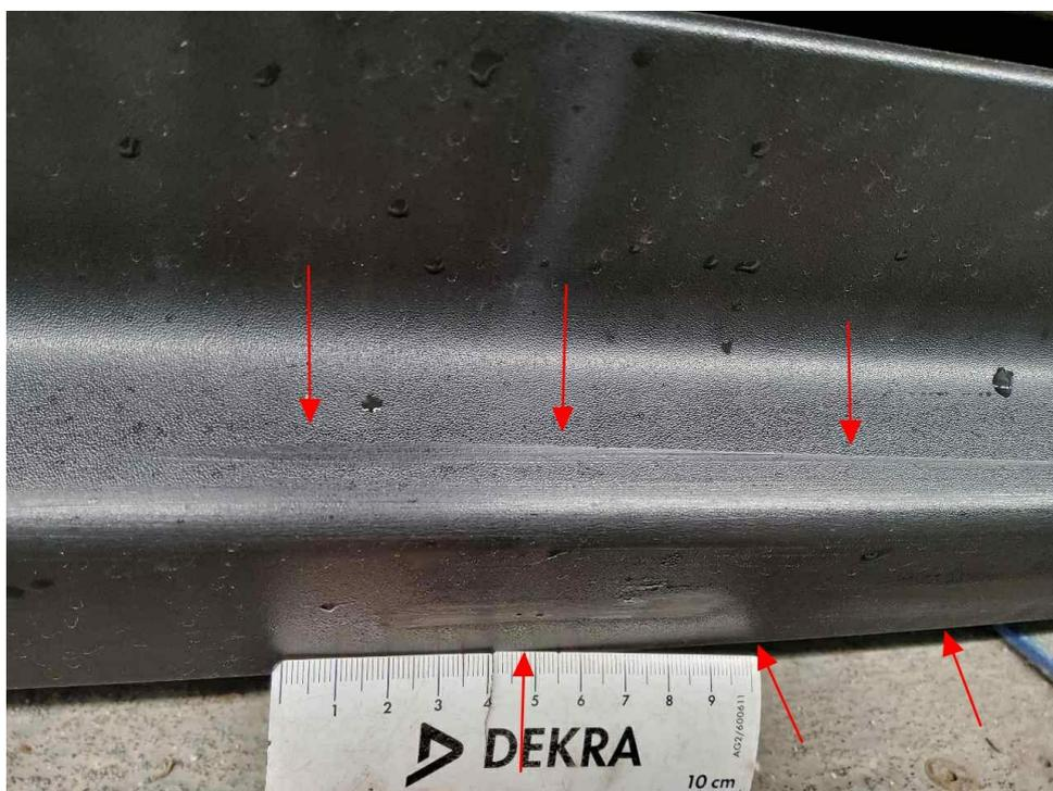
Bild 17 : Verkleidung Schweller rechts, gebrochen
