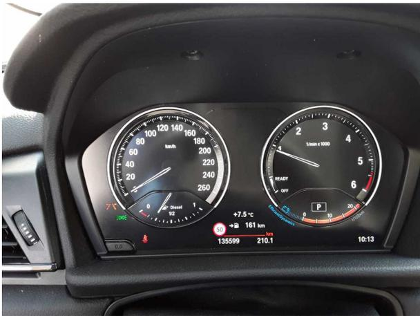
Abbildung 9: Kombiinstrument
