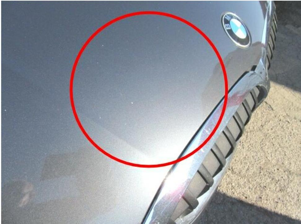
Bild 17 : Motorhaube erheblicher Steinschlag und Kratzer
