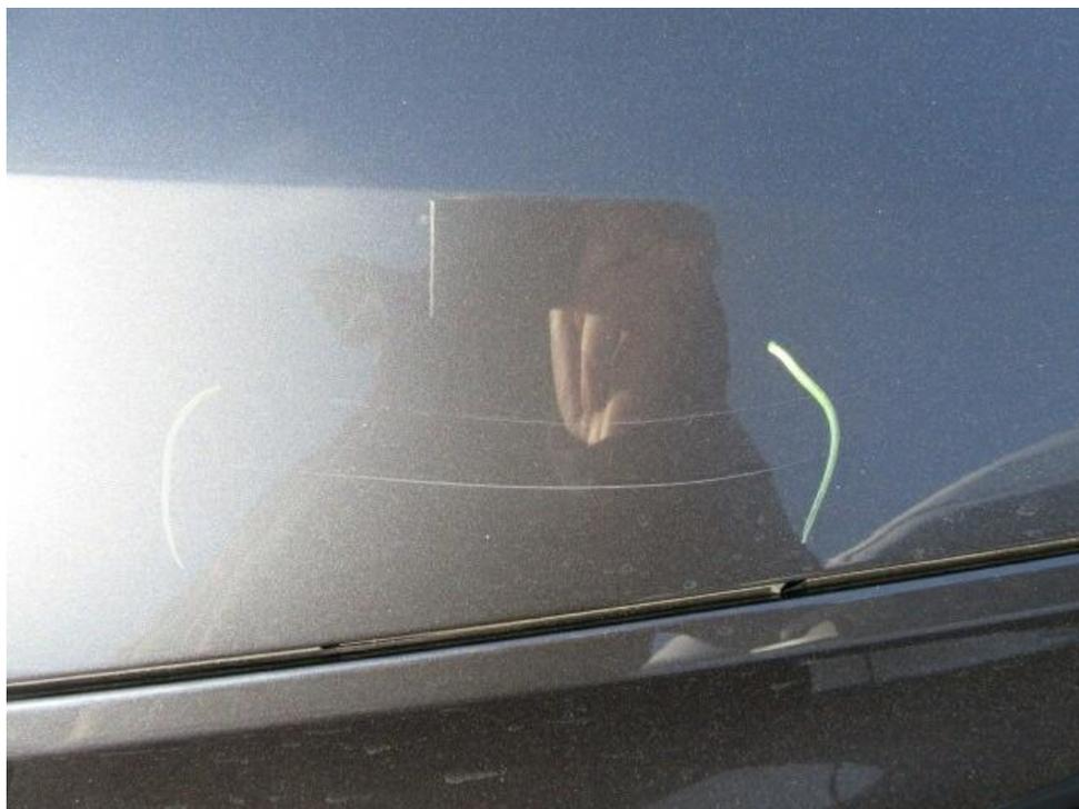
Bild 20 : Motorhaube erheblicher Steinschlag und Kratzer
