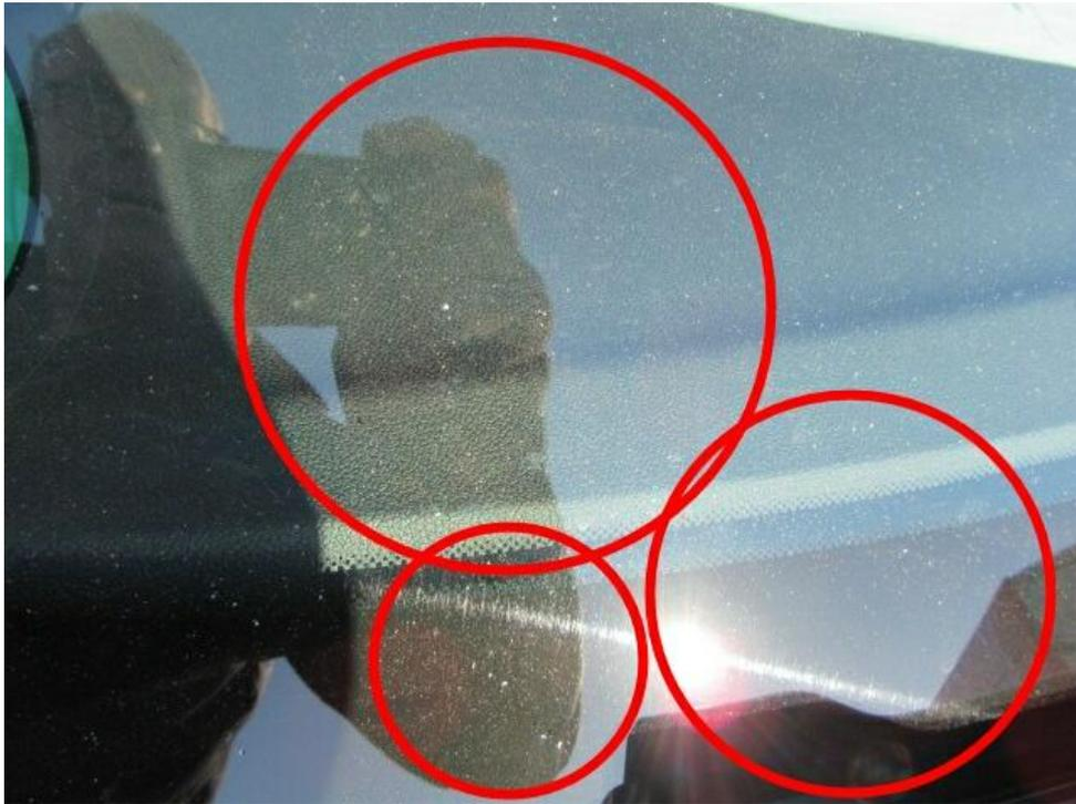
Bild 15 : WSS erhebliche Steinschläge ( Microsteinschläge)
