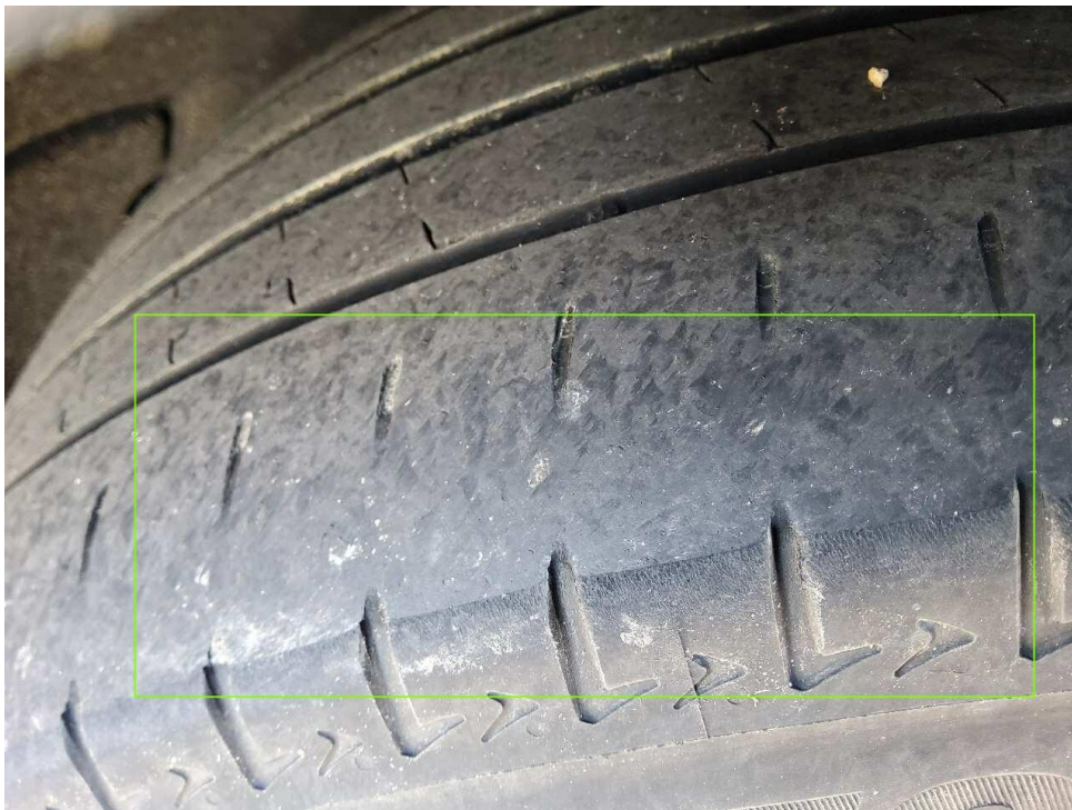
Bild 18 : Sommerreifen vorne einseitig abgefahren
