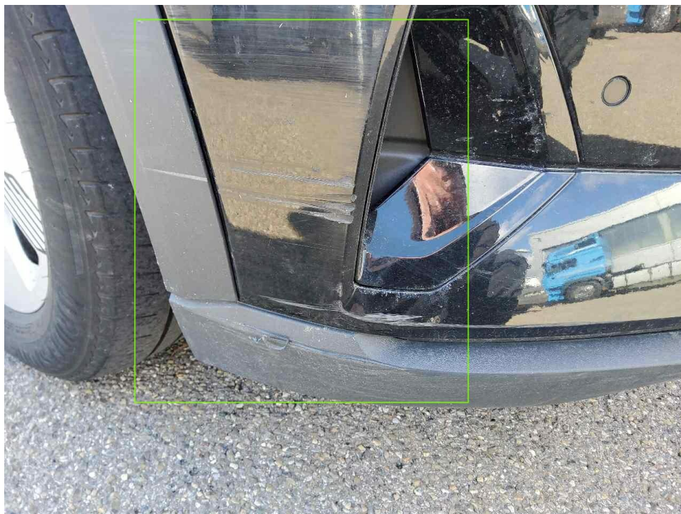
Bild 21 : Stoßfänger vorne rechts und links Anfahrtschaden
