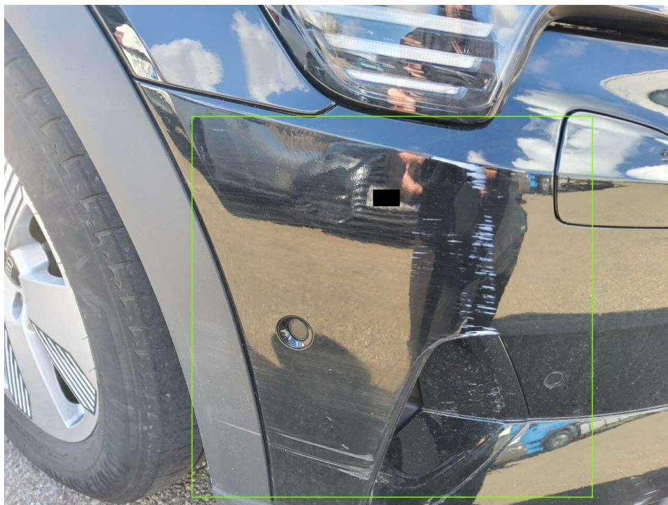
Bild 23 : Stoßfänger vorne rechts und links Anfahrtschaden
