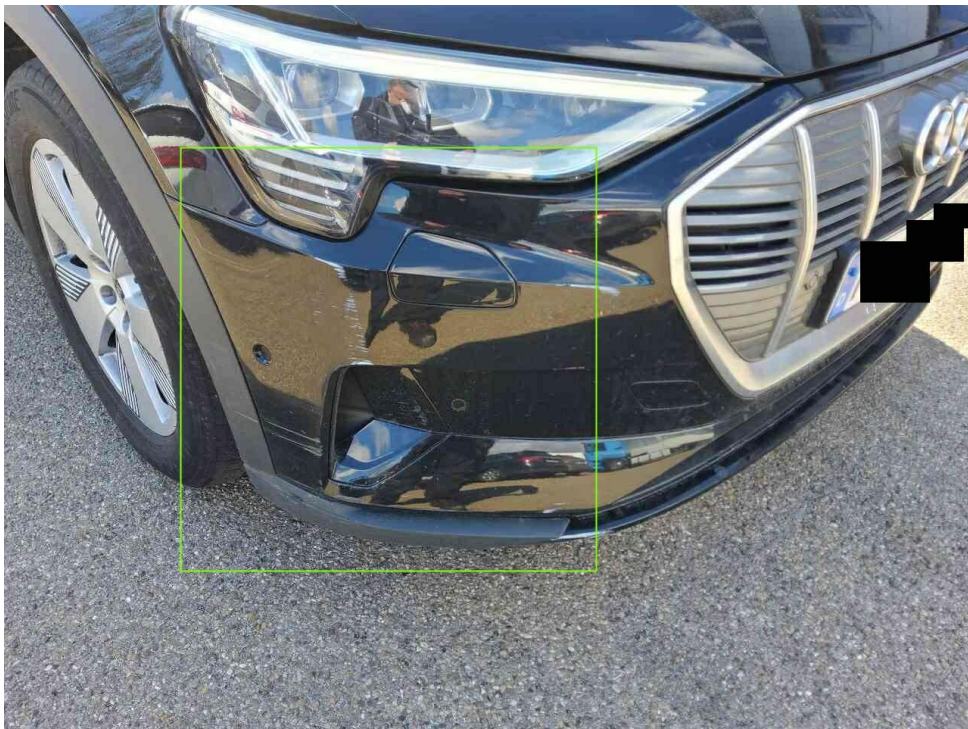
Bild 20 : Stoßfänger vorne rechts und links Anfahrtschaden
