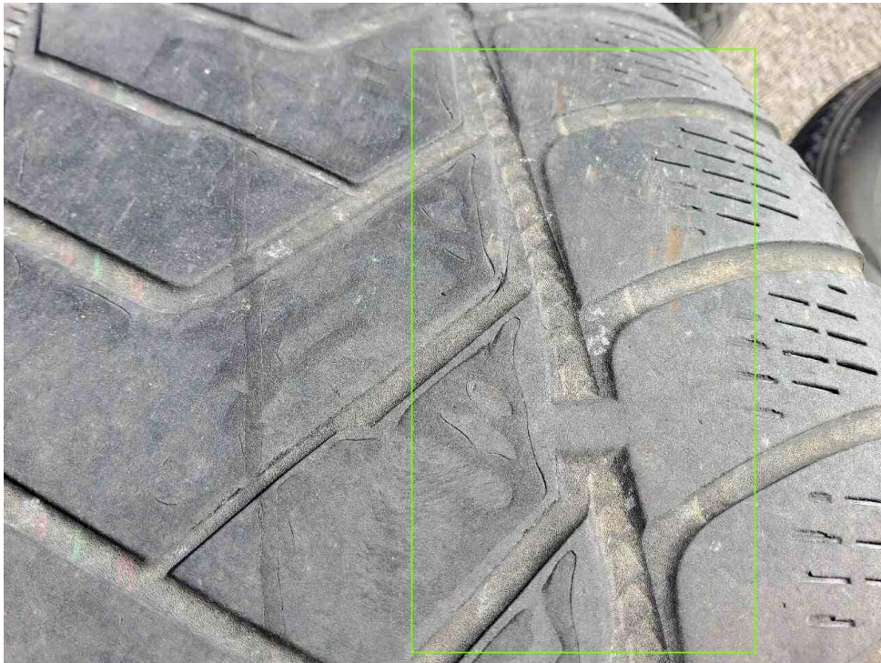
Bild 15 : Winterreifen 2 Stück abgefahren
