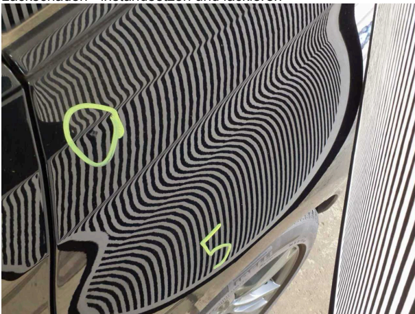
Beschädigung #5: Seitenwand links: Seitenwand - Delle / Lackschaden - instandsetzen und lackieren
