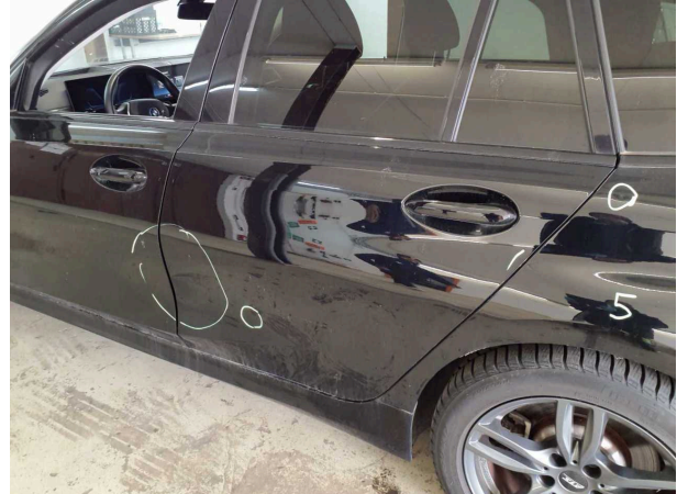
Beschädigung #8: Tür hinten links: Tür - verformt - erneuern
