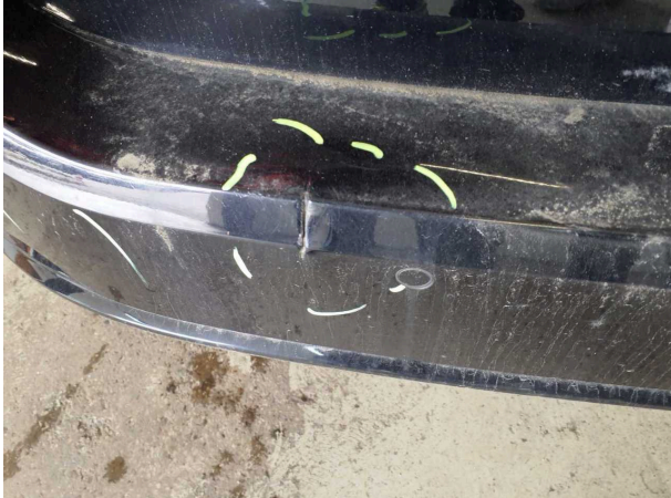
Beschädigung #7: Stossfänger hinten: Stossfänger hinten - Delle / Lackschaden - erneuern
