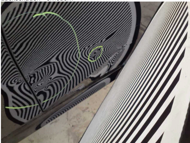
Beschädigung #8: Tür hinten links: Tür - verformt - erneuern
