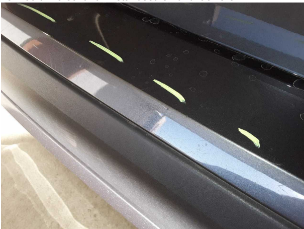
Beschädigung #2: Stossfänger hinten: Stossfänger hinten - verkratzt / verschürft - instandsetzen und lackieren
