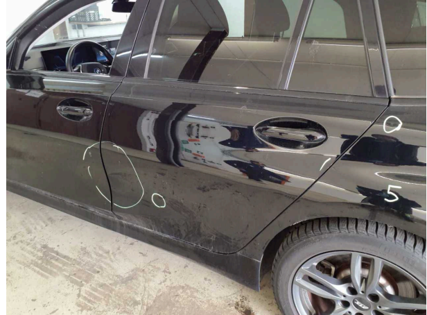
Damage #8: Door - rear left side: Door - Deformed - Replace
