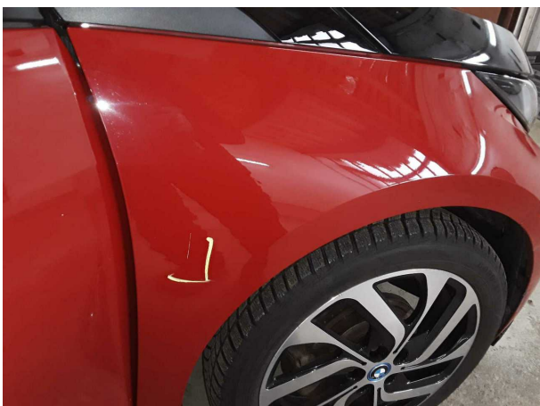
Beschädigung #9: Kotflügel rechts: Kotflügel rechts - verkratzt / verschürft - instandsetzen und lackieren
