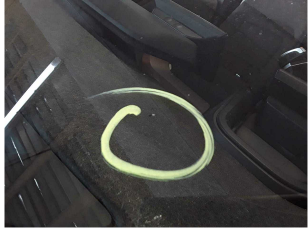
Beschädigung #10: Verglasung: Frontscheibe (Rissbildung) - Steinschlag - erneuern
