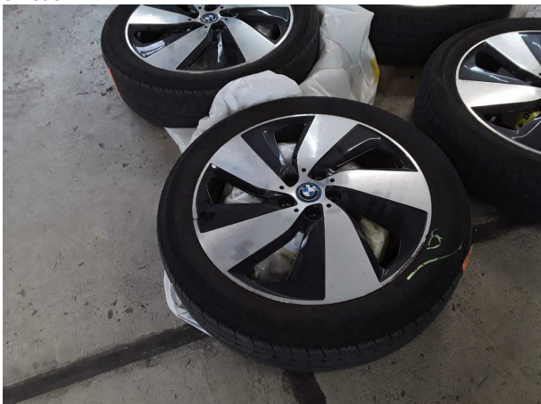
Beschädigung #5: 2.Radsatz: 1 Leichtmetallfelge - verkratzt / verschürft - Wertminderung
