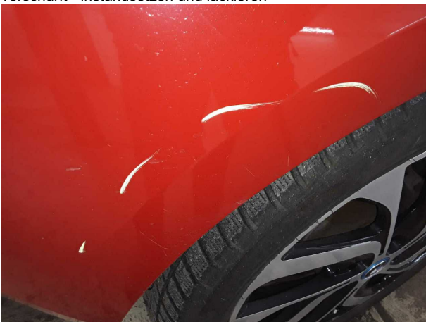
Beschädigung #12: Seitenwand rechts: Seitenwand - verkratzt / verschürft - instandsetzen und lackieren
