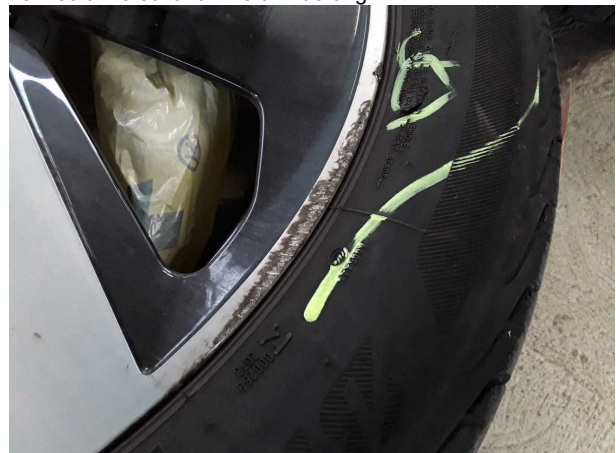
Beschädigung #5: 2.Radsatz: 1 Leichtmetallfelge - verkratzt / verschürft - Wertminderung
