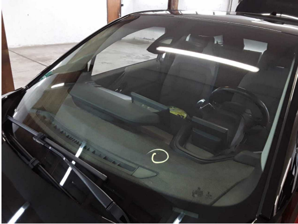
Beschädigung #10: Verglasung: Frontscheibe (Rissbildung) - Steinschlag - erneuern
