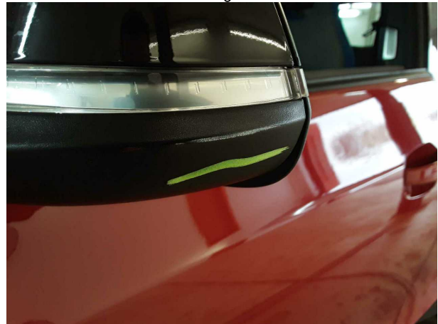
Beschädigung #4: Außenspiegel rechts: Abdeckkappe - verkratzt / verschürft - Wertminderung
