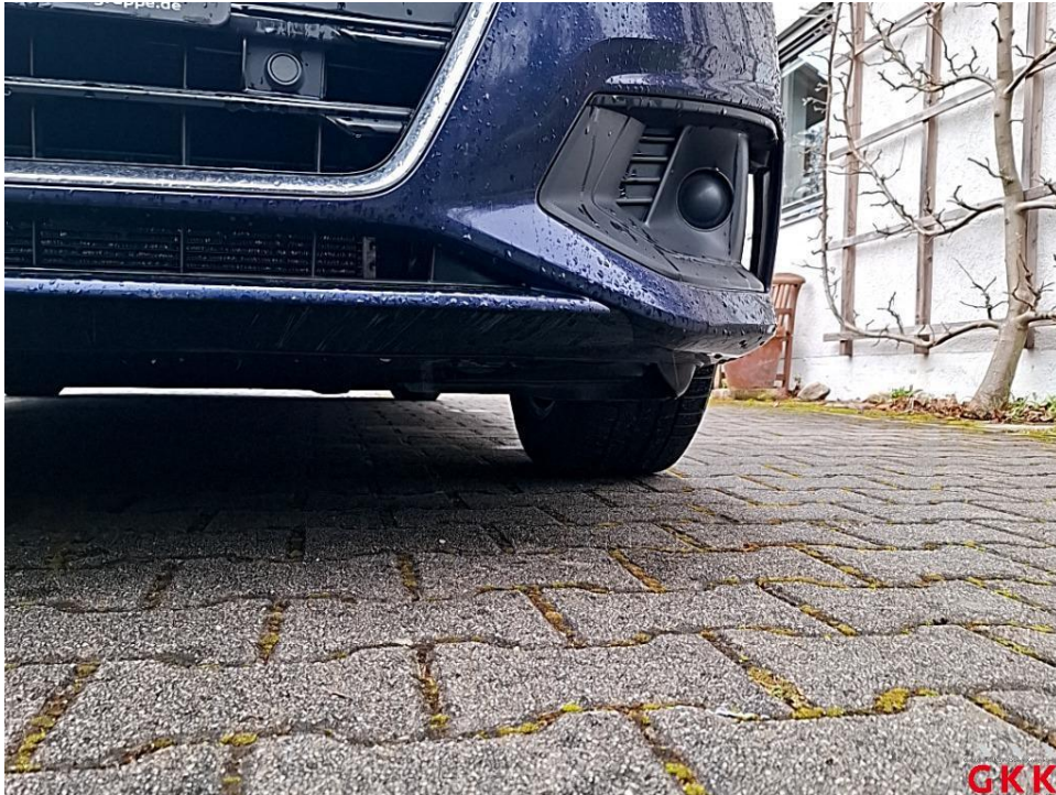
Bild 13. Stoßfänger vorne, Verkleidung -lackiert-, verkratzt, Smartrepair
