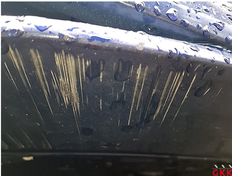
Bild 14. Stoßfänger vorne, Verkleidung -lackiert-, verkratzt, Smartrepair
