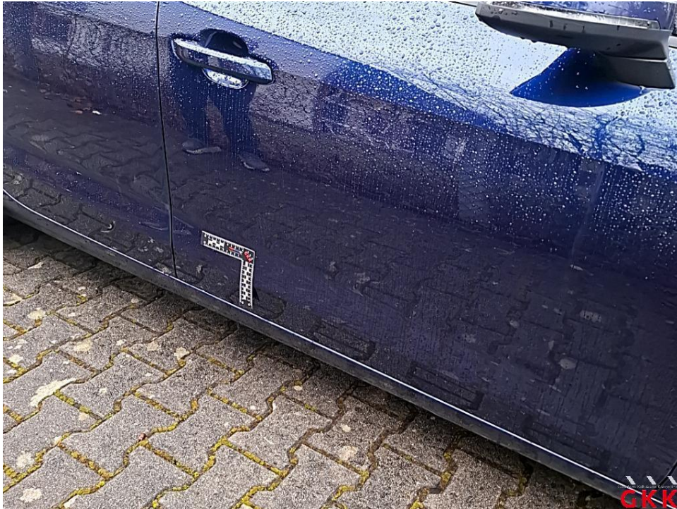
Bild 15. Tür vorne rechts, beschädigt, instand setzen - lackieren
