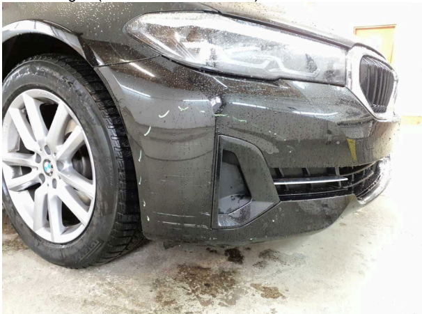
Beschädigung #4: Stossfänger vorn: Stossfänger vorn - verkratzt / verschürft - instandsetzen und lackieren
