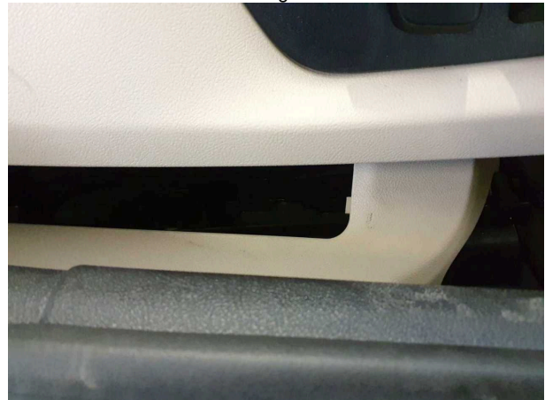
Beschädigung #3: Verkleidungen/Abdeckungen: Verkleidungen/Abdeckungen (Sitz vorne rechts unten) - lose -
