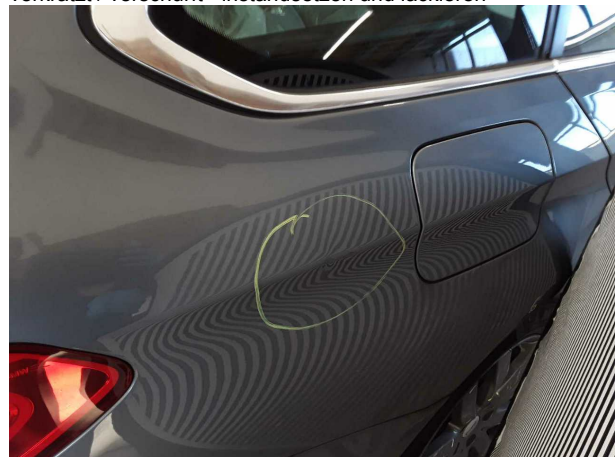
Beschädigung #9: Seitenwand rechts: Seitenwand - verformt - instandsetzen und lackieren
