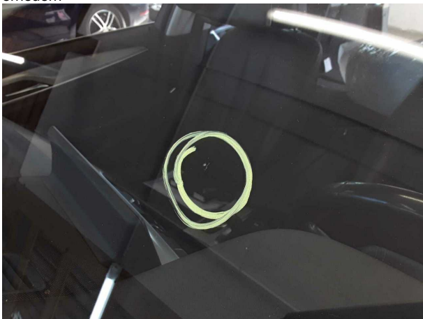
Beschädigung #7: Verglasung: Frontscheibe - Steinschlag - erneuern
