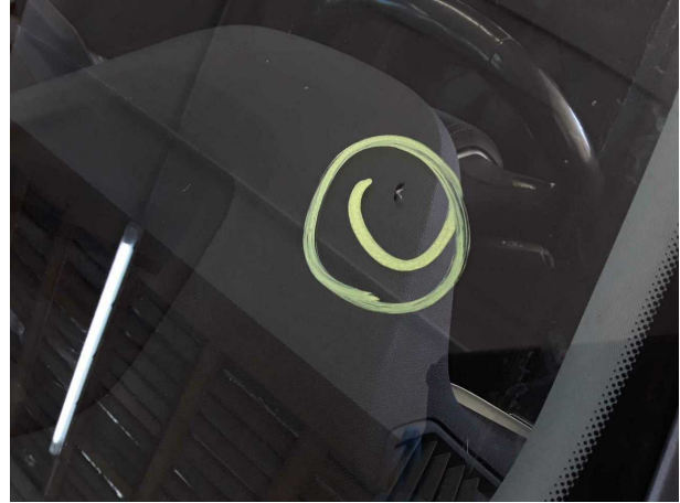
Beschädigung #7: Verglasung: Frontscheibe - Steinschlag - erneuern
