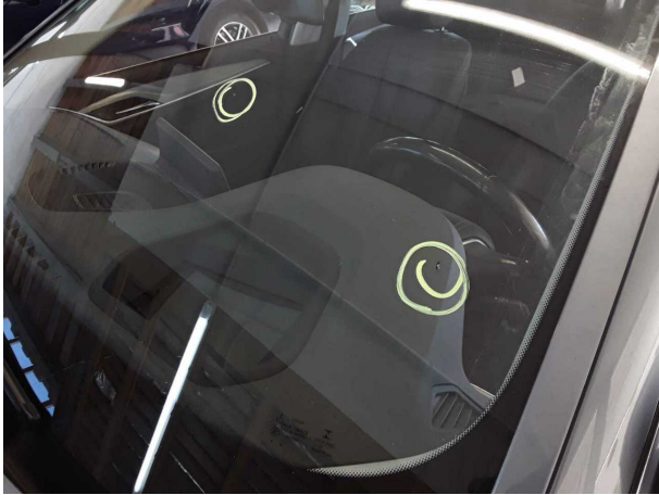
Beschädigung #7: Verglasung: Frontscheibe - Steinschlag - erneuern
