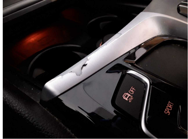
Beschädigung #4: Instrumententafel: Mittelkonsole vorn - verkratzt / verschürft - erneuern
