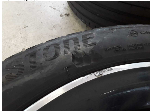
Damage #10: 2nd wheel set: 2 tyres (Seitlich abgefahren) - Worn - Replace
