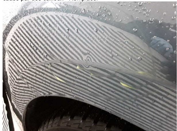
Domage #5: Panneau latéral arrière droit: Paroi latérale - bosse(s) - Réparer et repeindre
