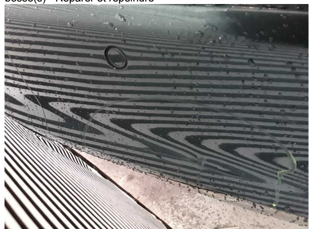
Domage #6: Pare-chocs arrière: Pare-chocs arrière - Déformé - Remplacer
