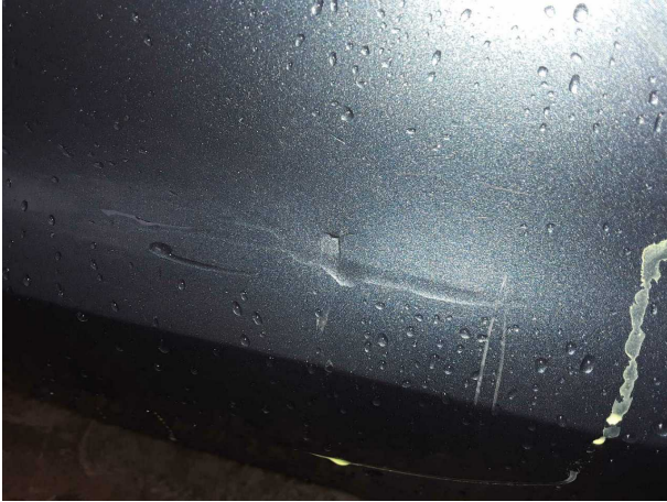
Domage #6: Pare-chocs arrière: Pare-chocs arrière - Déformé - Remplacer
