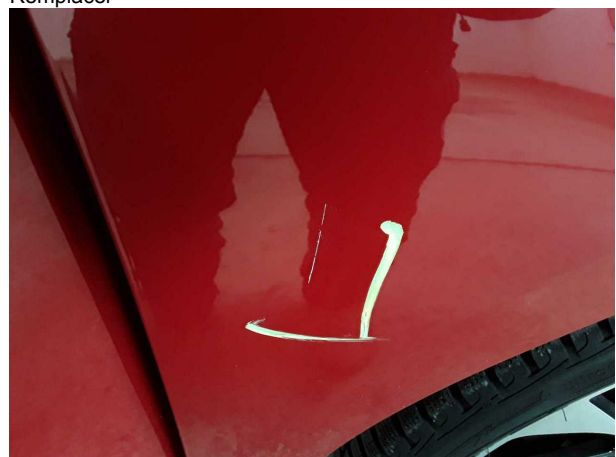
Domage #9: Garde-boue droit: Garde-boue droit - Erafilé - Réparer et repeindre
