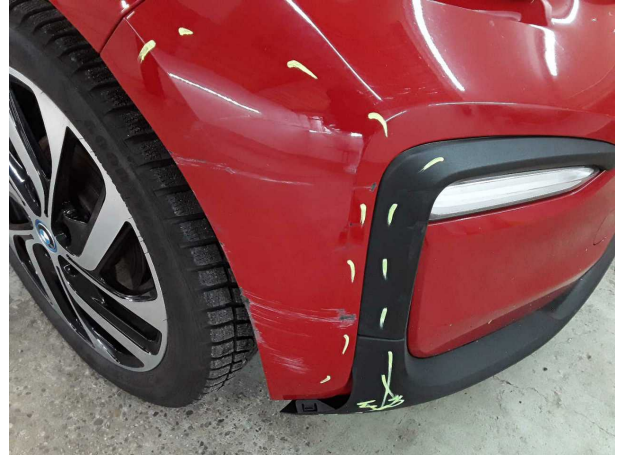
Domage #13: Pare-chocs avant: Pare-chocs avant - Dommages - Remplacer
