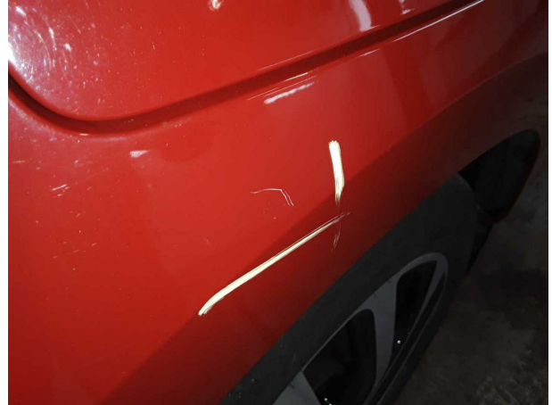
Domage #12: Panneau latéral arrière droit: Paroi latérale - Eraflé - Réparer et repeindre
