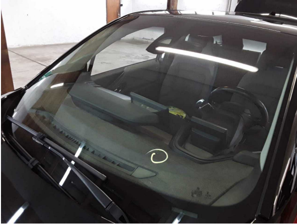
Domage #10: Vitrage: Pare-brise (Rissbildung) - Dommage causé par des cailloux - Remplacer
