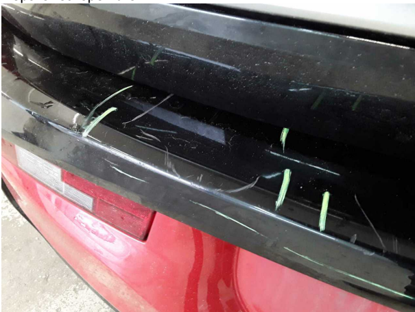
Domage #11: Pare-chocs arrière: Pare-chocs arrière - Erafilé - Réparer et repeindre
