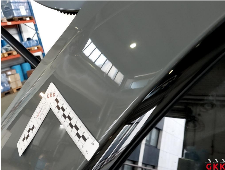
Bild 19. Dach, Holm rechts, Reparaturmangel, lackieren
