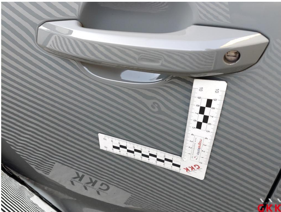
Bild 26. Tür vorne links, bis 3 Dellen / Bauteil, kalt drücken
