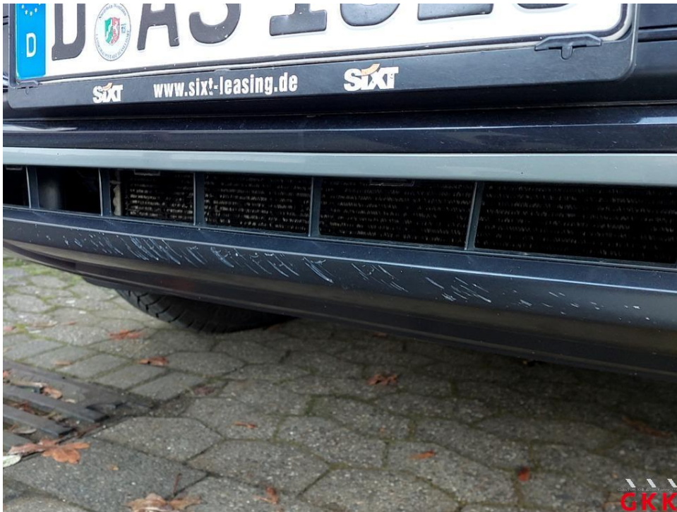
Bild 23. Stoßfänger vorne, Spoiler -unlackiert-, beschädigt, ersetzen
