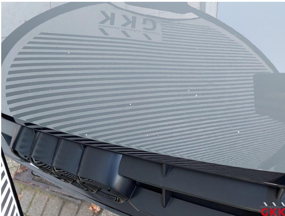
Bild 14. Motorhaube, Steinschlag, lackieren
