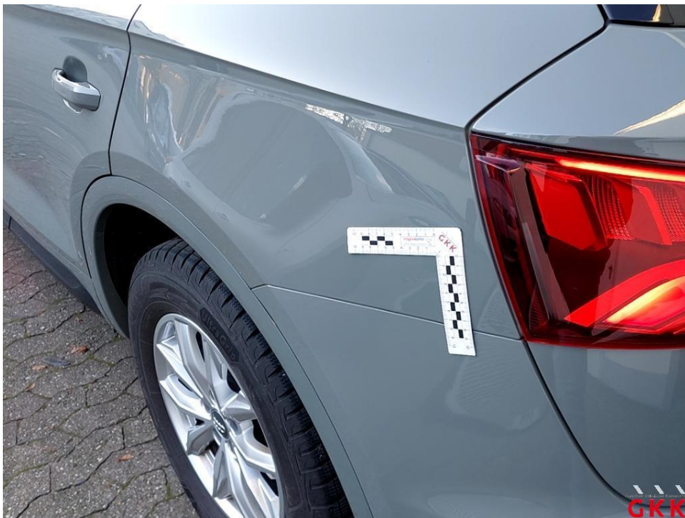
Bild 28. Seitenwand links, bis 3 Dellen / Bauteil, Smartrepair
