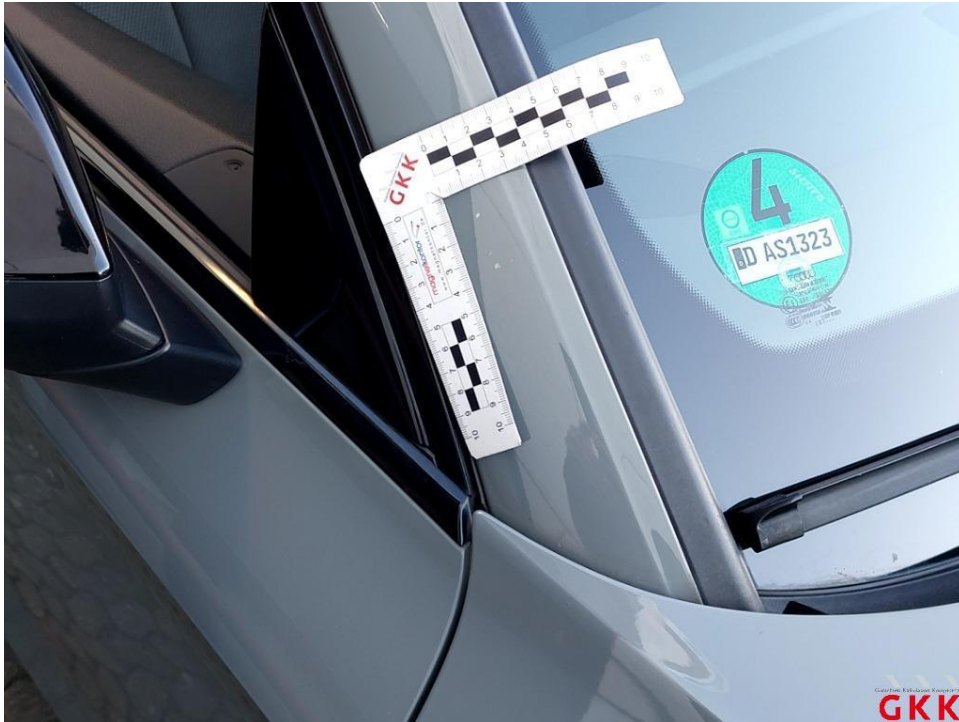
Bild 21. A- Säule rechts, Steinschlag, auslegen, schleifen, polieren
