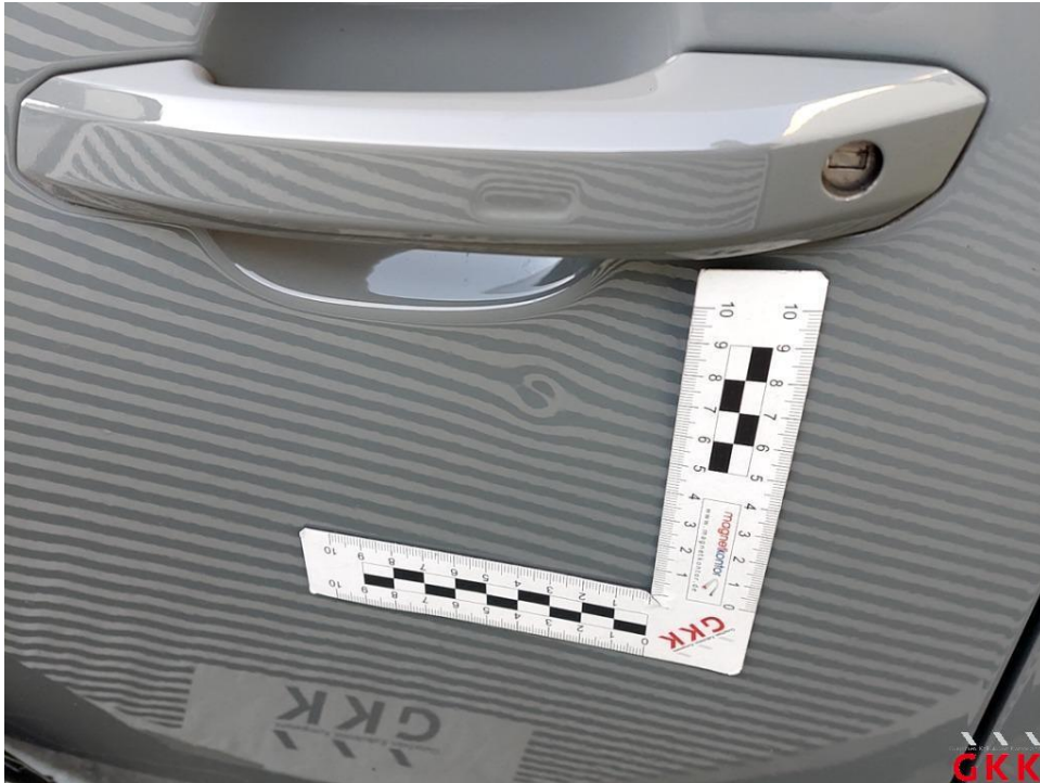
Bild 27. Tür vorne links, bis 3 Dellen / Bauteil, kalt drücken
