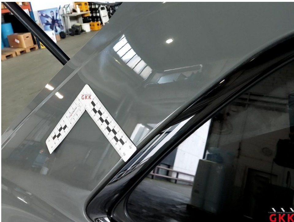
Bild 18. Dach, Holm rechts, Reparaturmangel, lackieren
