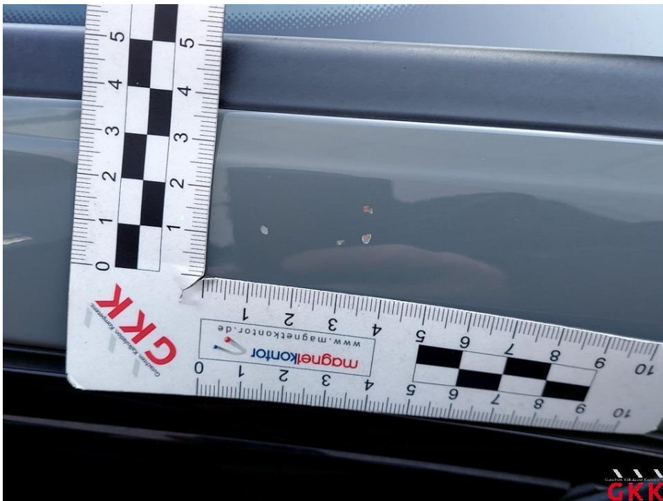
Bild 22. A- Säule rechts, Steinschlag, auslegen, schleifen, polieren
