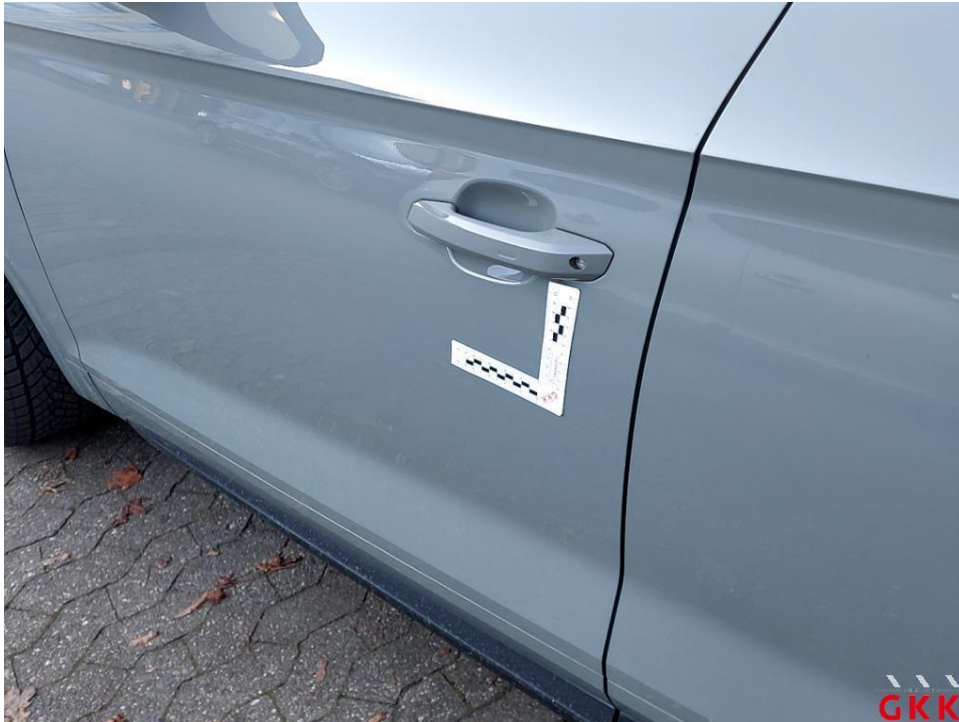
Bild 25. Tür vorne links, bis 3 Dellen / Bauteil, kalt drücken
