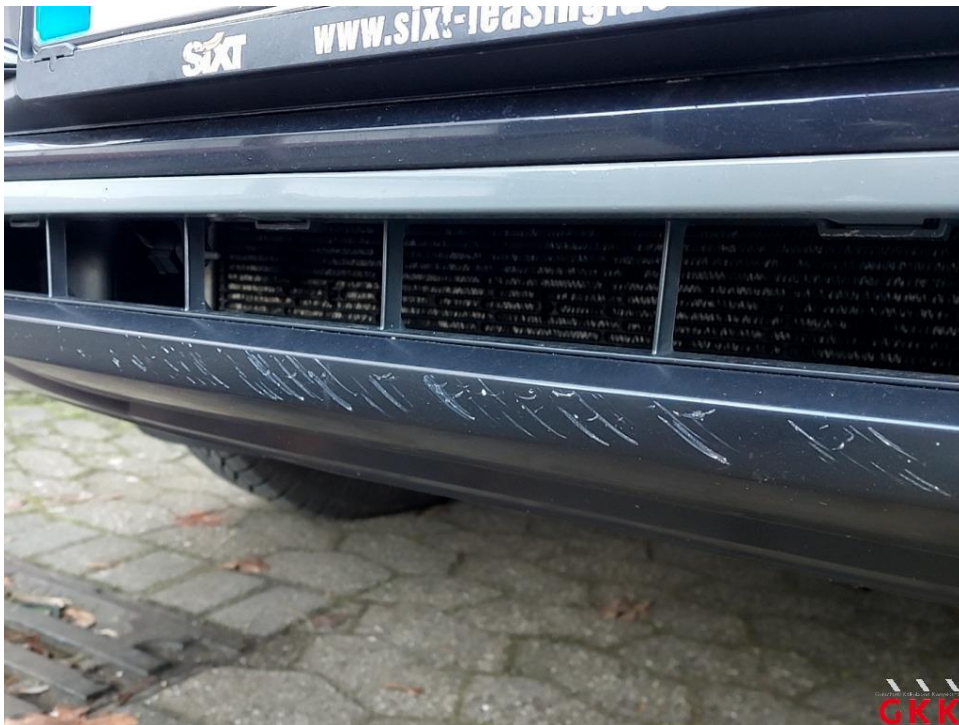
Bild 24. Stoßfänger vorne, Spoiler -unlackiert-, beschädigt, ersetzen
