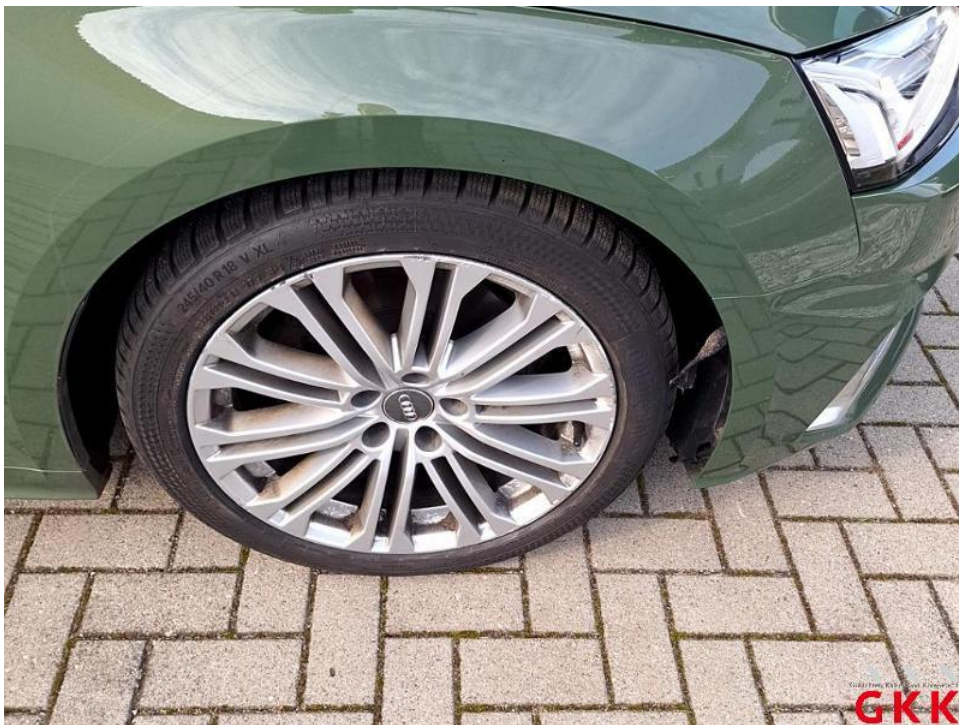
Bild 44. Kotflügel vorne rechts, Schale, beschädigt, ersetzen
