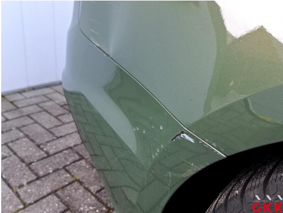
Bild 51. Fahrzeug, hinten rechts, Unfallschaden, instand setzen
