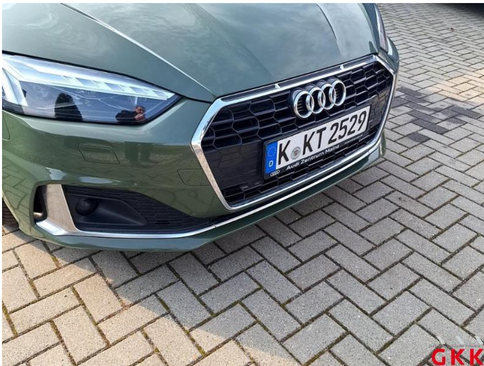
Bild 20. Stoßfänger vorne, Verkleidung -lackiert-, verkratzt, Spotlackieren
