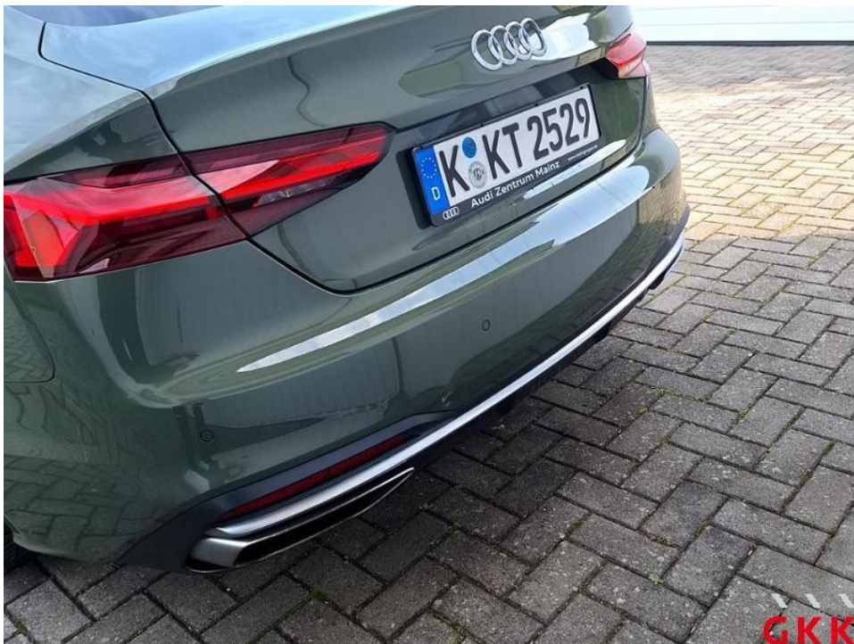
Bild 32. Stoßfänger hinten, Verkleidung -lackiert-, beschädigt, ersetzen
