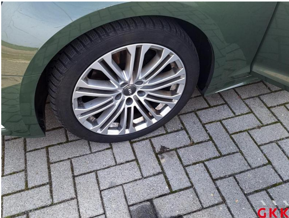
Bild 12. Reifen, vorne links, Untermaß, ersetzen
