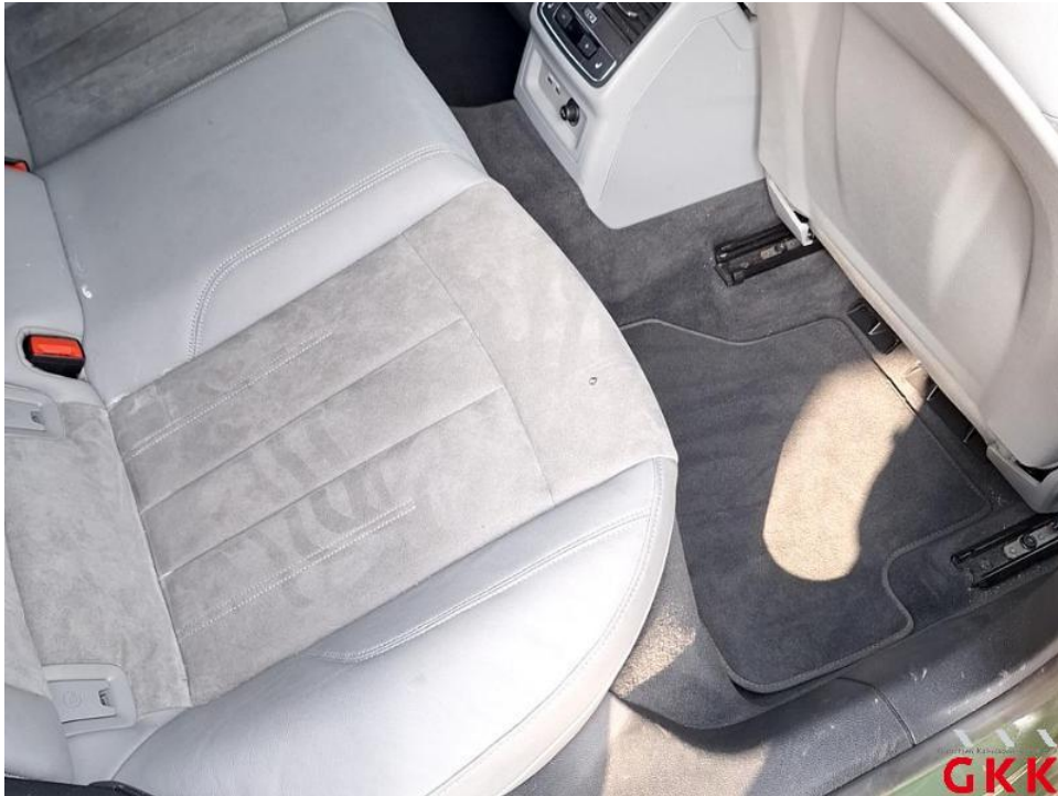
Bild 37. Sitz hinten rechts, Bezug Sitzkissen -Leder-, Brandloch, Smartrepair
