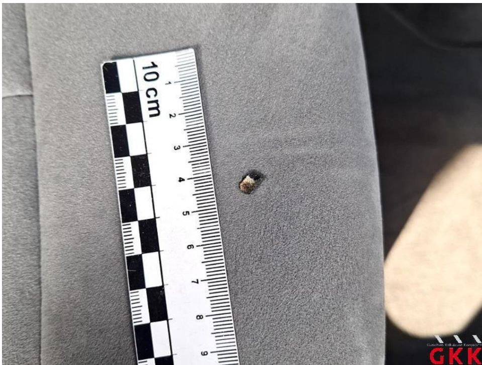
Bild 38. Sitz hinten rechts, Bezug Sitzkissen -Leder-, Brandloch, Smartrepair
