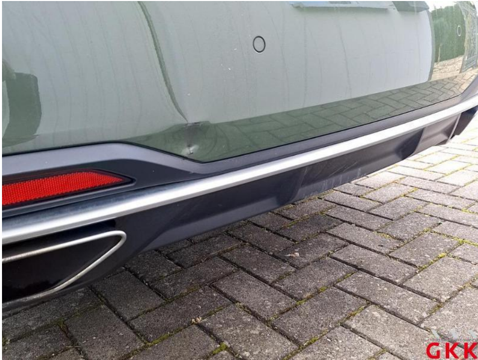
Bild 35. Stoßfänger hinten, Spoiler -unlackiert-, beschädigt, ersetzen
