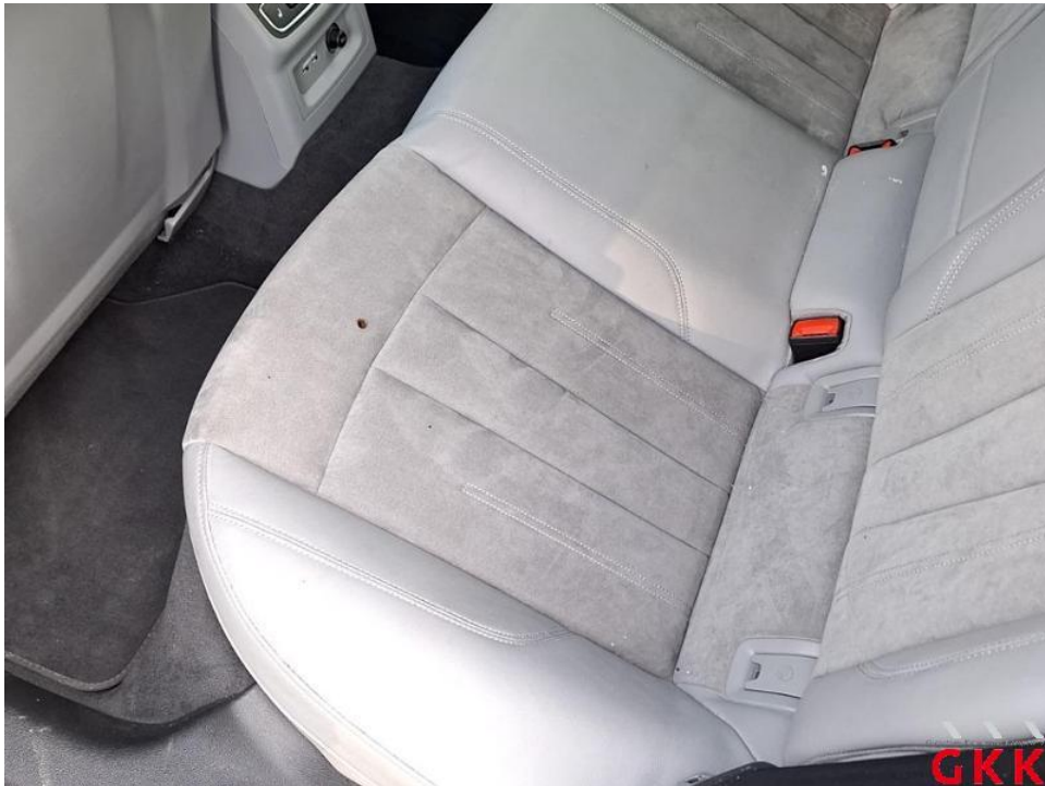
Bild 26. Sitz hinten links, Bezug Sitzkissen -Leder-, Brandloch, Smartrepair
