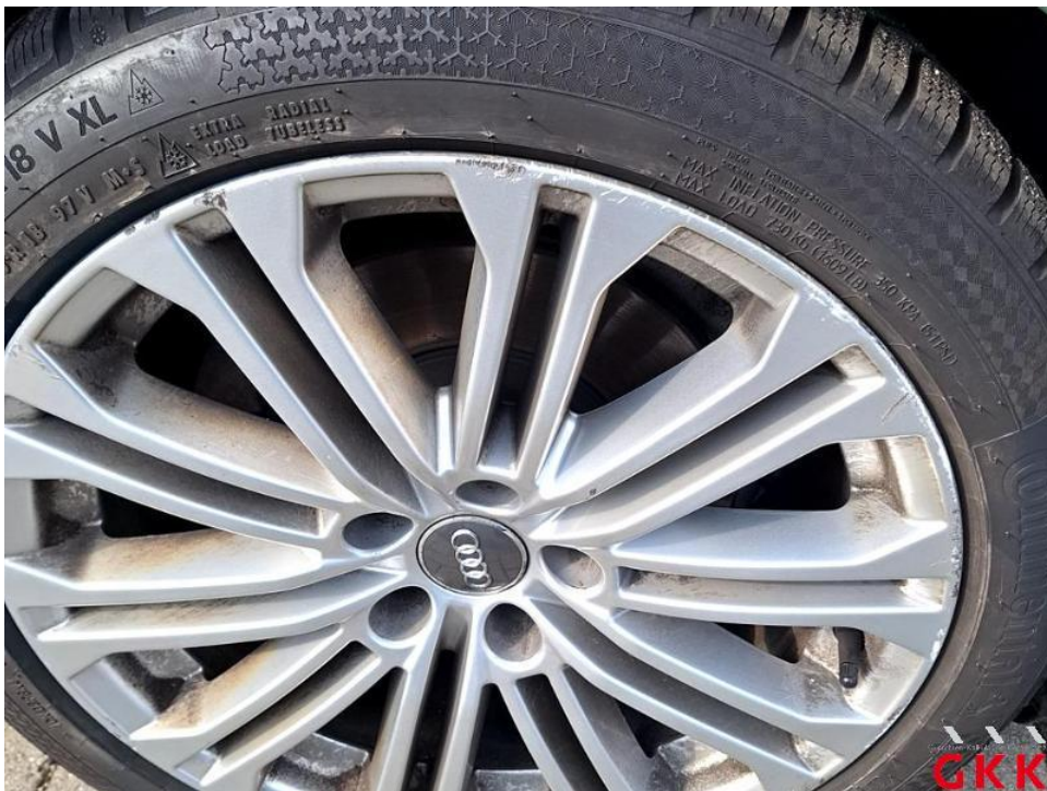
Bild 42. LM-Rad, vorne rechts, beschädigt, ersetzen
