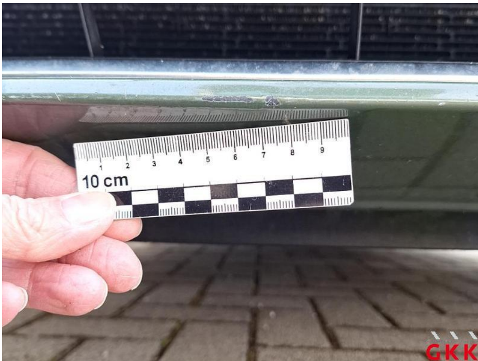
Bild 22. Stoßfänger vorne, Verkleidung -lackiert-, verkratzt, Spotlackieren
