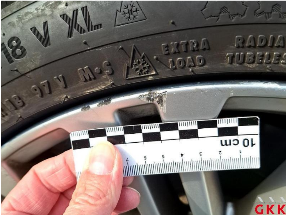
Bild 43. LM-Rad, vorne rechts, beschädigt, ersetzen
