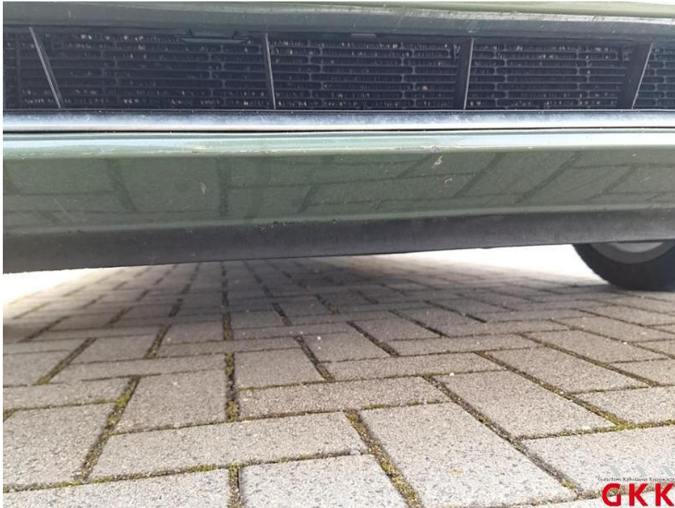
Bild 21. Stoßfänger vorne, Verkleidung -lackiert-, verkratzt, Spotlackieren
