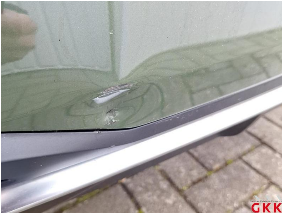
Bild 34. Stoßfänger hinten, Verkleidung -lackiert-, beschädigt, ersetzen
