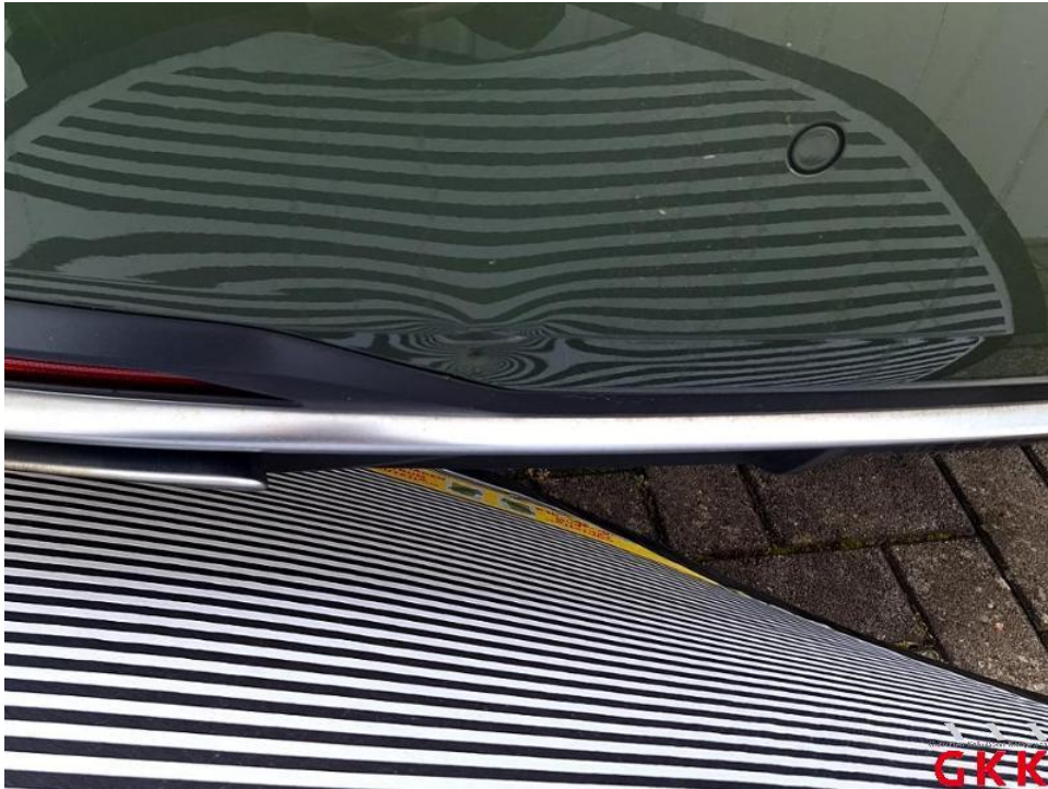
Bild 33. Stoßfänger hinten, Verkleidung -lackiert-, beschädigt, ersetzen
