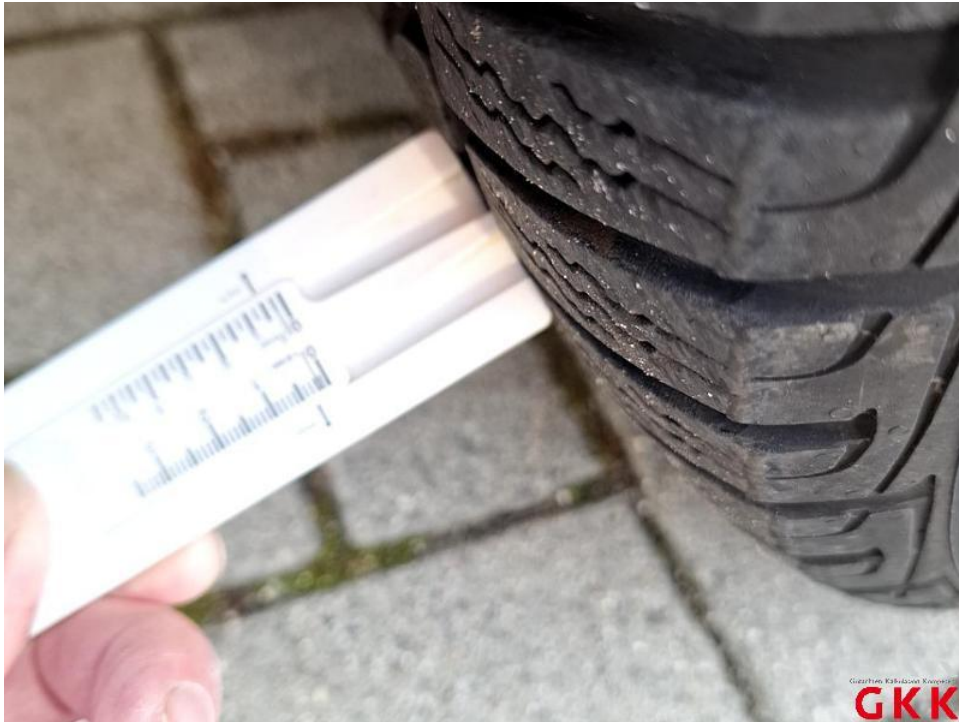
Bild 13. Reifen, vorne links, Untermaß, ersetzen
