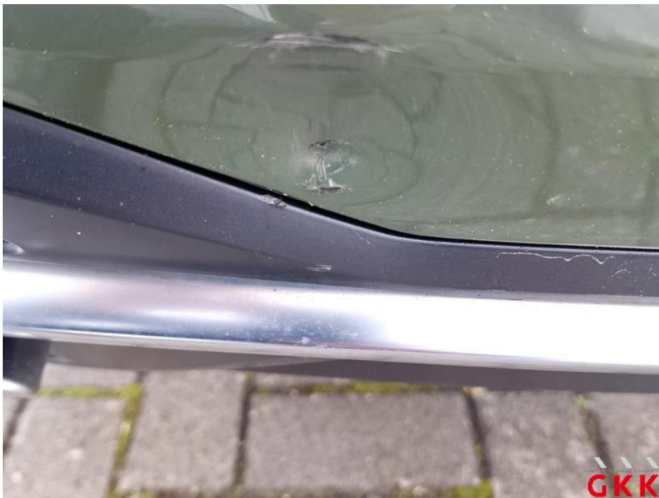
Bild 36. Stoßfänger hinten, Spoiler -unlackiert-, beschädigt, ersetzen
