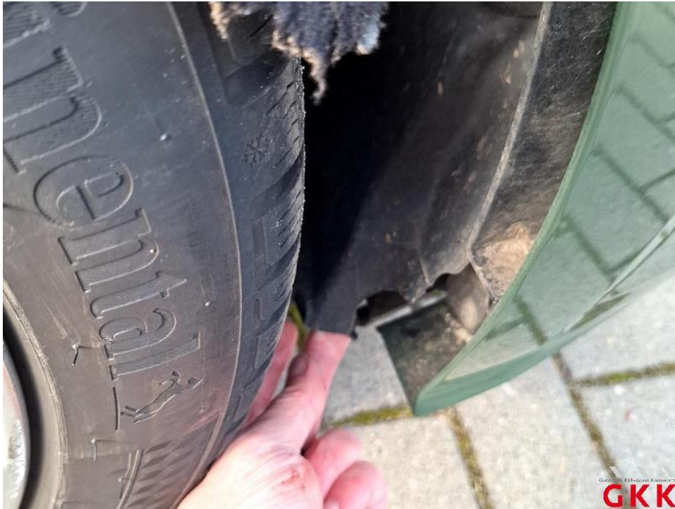
Bild 45. Kotflügel vorne rechts, Schale, beschädigt, ersetzen
