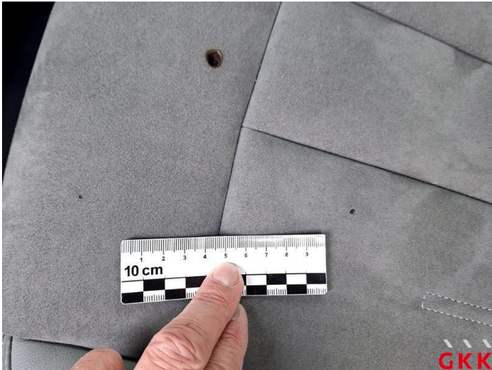
Bild 28. Sitz hinten links, Bezug Sitzkissen -Leder-, Brandloch, Smartrepair
