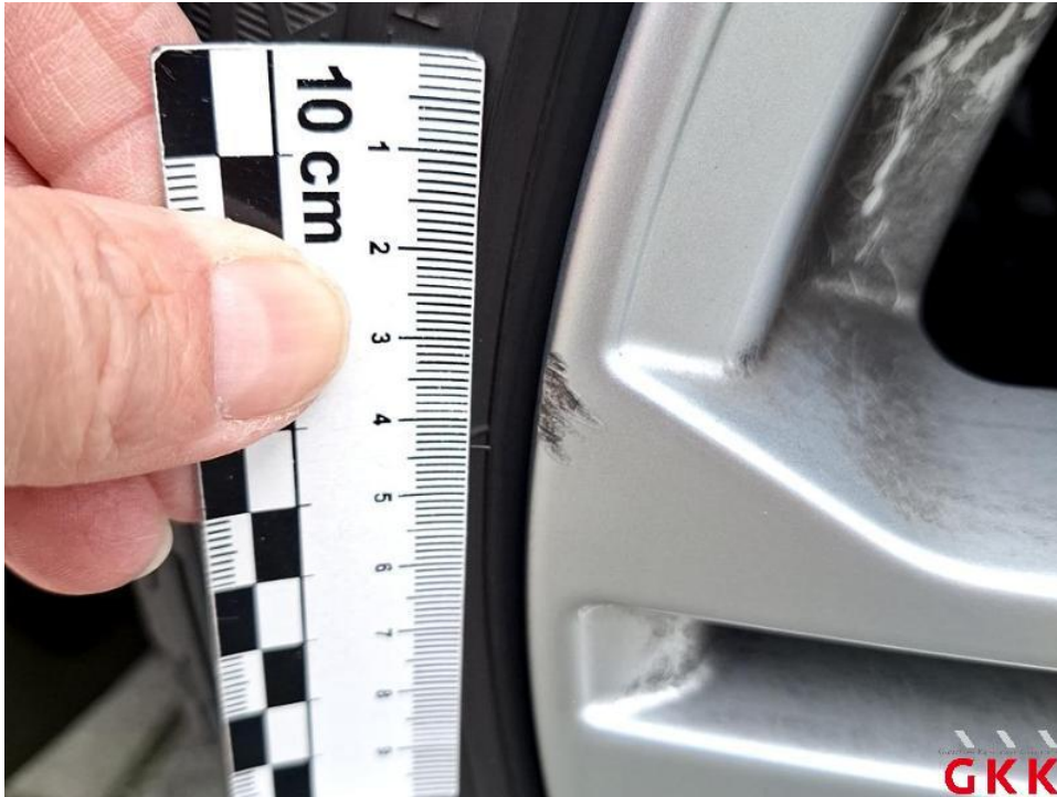
Bild 31. LM-Rad, hinten links, beschädigt, ersetzen
