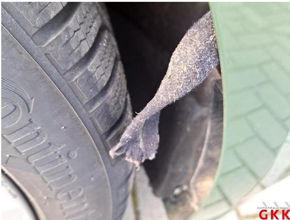
Bild 46. Kotflügel vorne rechts, Schale, beschädigt, ersetzen
