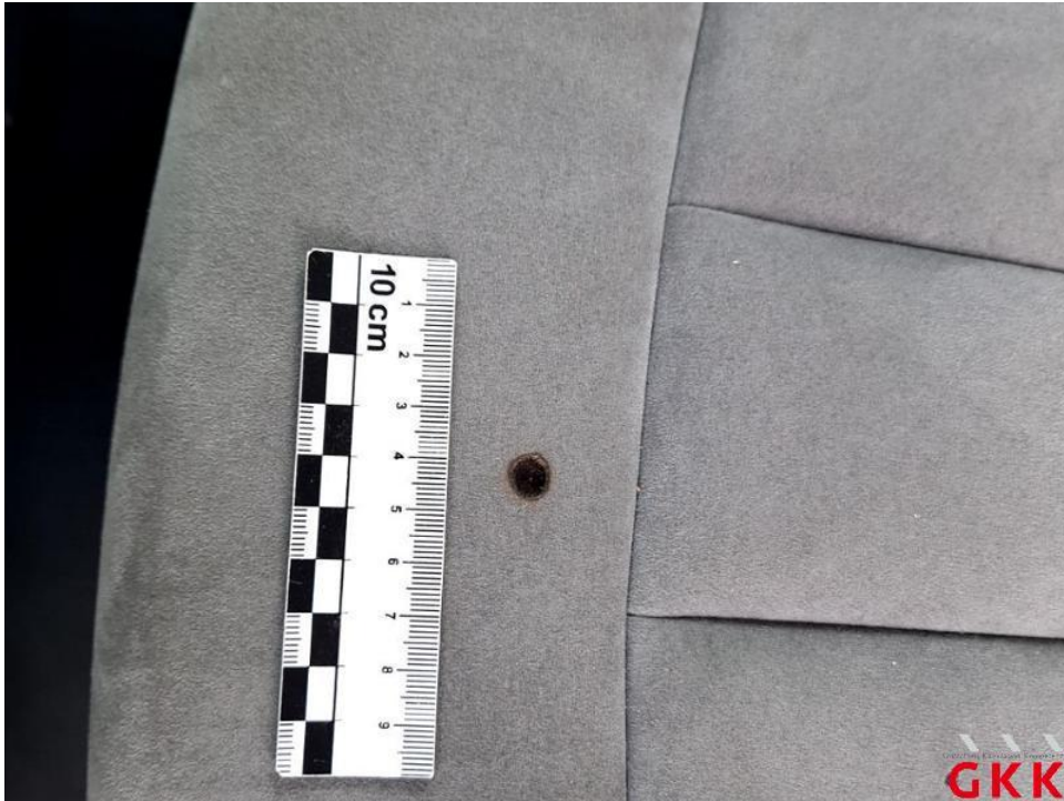
Bild 27. Sitz hinten links, Bezug Sitzkissen -Leder-, Brandloch, Smartrepair
