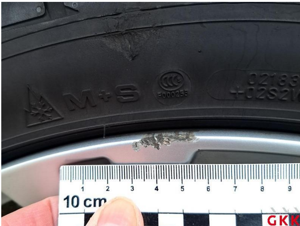
Bild 30. LM-Rad, hinten links, beschädigt, ersetzen
