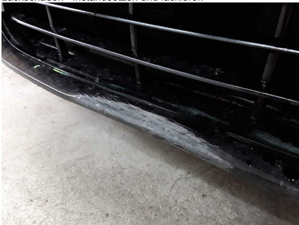
Beschädigung #19: Stossfänger vorn: Stossfänger vorn - beschädigt - erneuern
