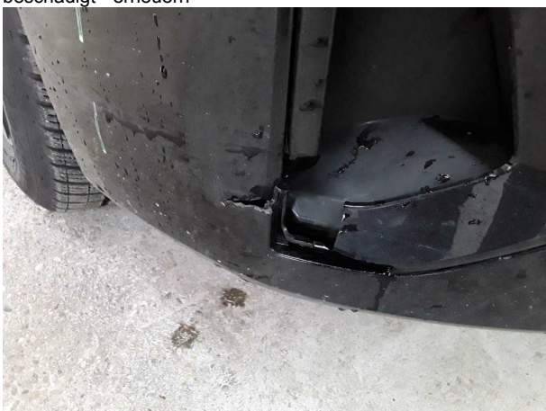
Beschädigung #19: Stossfänger vorn: Stossfänger vorn - beschädigt - erneuern
