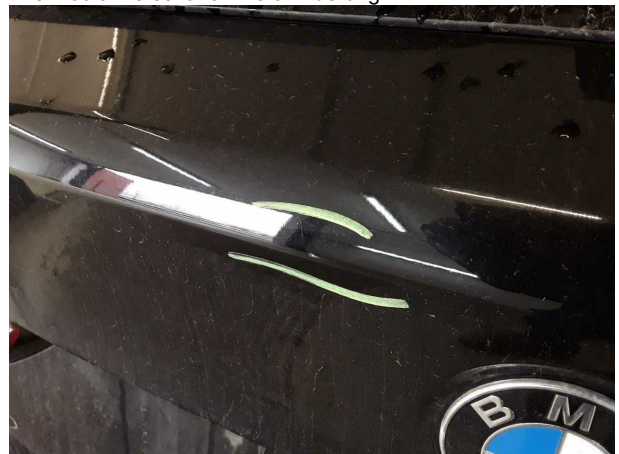
Beschädigung #9: Heckklappe/-tür: Heckklappe - verkratzt / verschüft - Smart Repair
