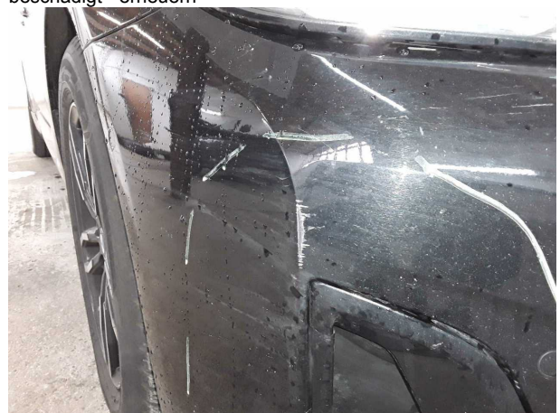
Beschädigung #19: Stossfänger vorn: Stossfänger vorn - beschädigt - erneuern
