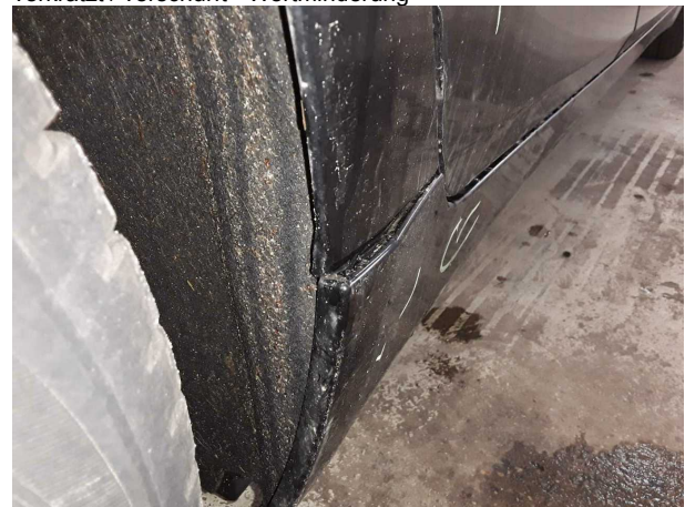
Beschädigung #12: Schweller rechts: Verkleidung - verkratzt / verschürft - erneuern
