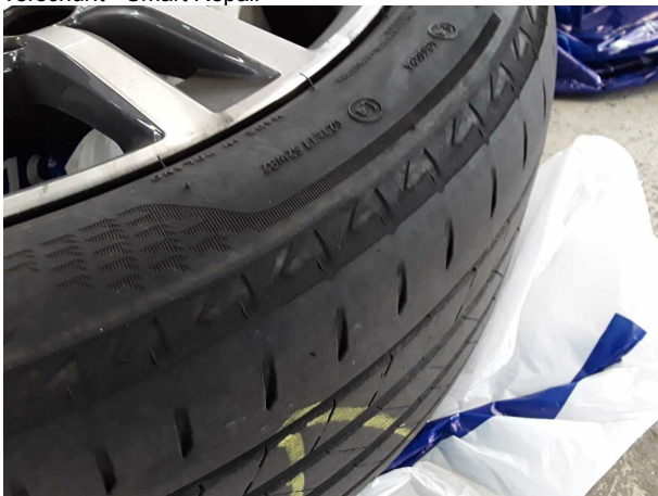
Beschädigung #10: 2.Radsatz: 2 Reifen (Seitlich abgefahren) - verschlissen - erneuern
