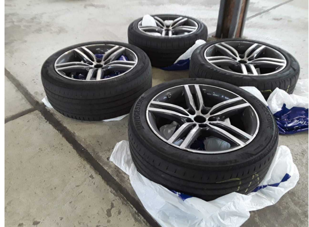
Beschädigung #10: 2.Radsatz: 2 Reifen (Seitlich abgefahren) - verschlissen - erneuern
