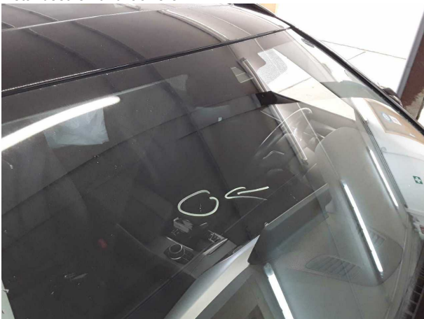
Beschädigung #16: Verglasung: Frontscheibe (Rissbildung) - Steinschlag - erneuern
