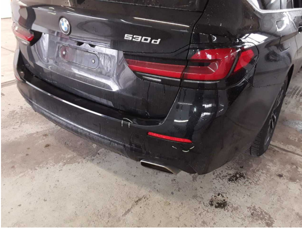
Beschädigung #17: Stossfänger hinten: Stossfänger hinten - verkratzt / verschürft - instandsetzen und lackieren
