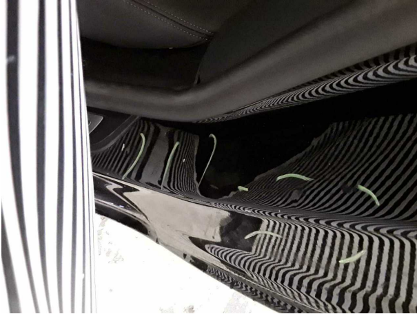
Beschädigung #14: Seitenwand links: Einstieg - verkratzt / verschürft - instandsetzen und lackieren
