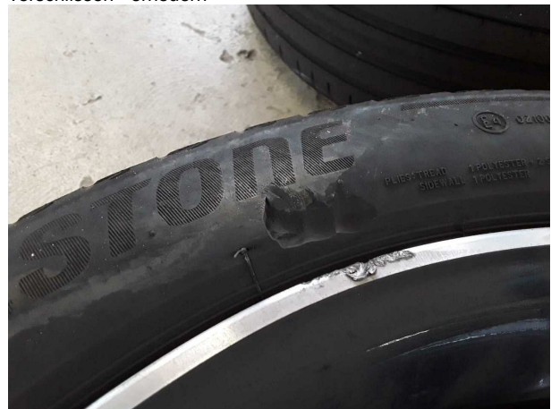
Beschädigung #10: 2.Radsatz: 2 Reifen (Seitlich abgefahren) - verschlissen - erneuern
