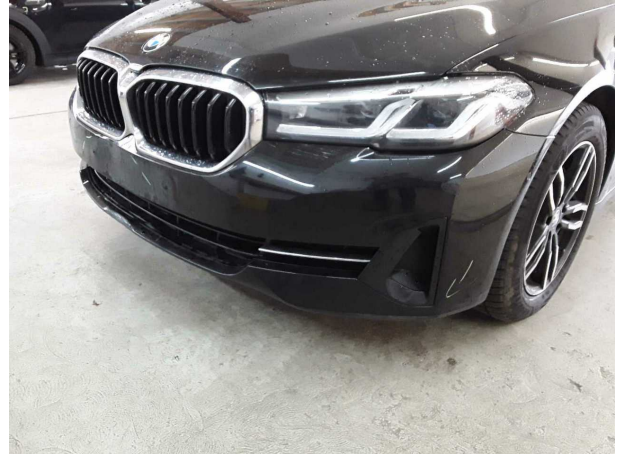
Beschädigung #19: Stossfänger vorn: Stossfänger vorn - beschädigt - erneuern
