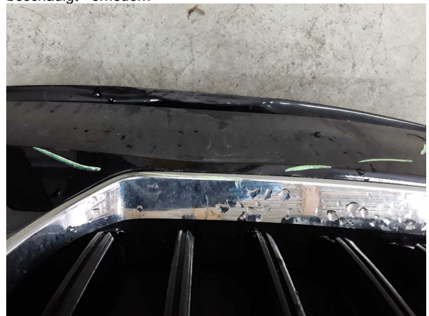
Beschädigung #19: Stossfänger vorn: Stossfänger vorn - beschädigt - erneuern
