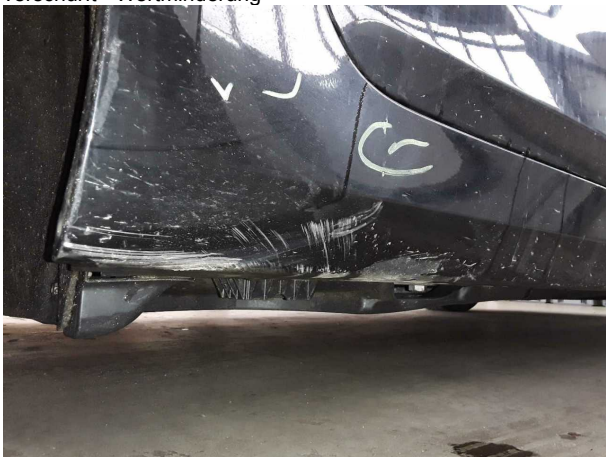
Beschädigung #12: Schweller rechts: Verkleidung - verkratzt / verschürft - erneuern
