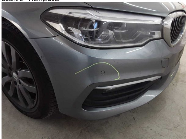
Domage #10: Pare-chocs avant: Pare-chocs avant - Cassé/déchiré - Remplacer
