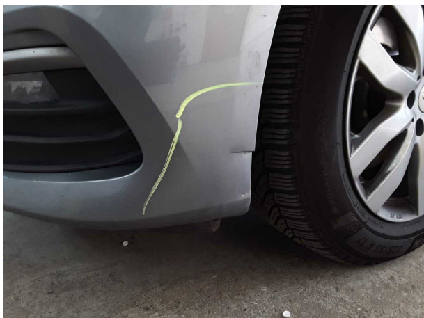
Domage #10: Pare-chocs avant: Pare-chocs avant - Cassé/déchiré - Remplacer
