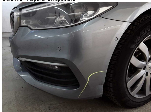
Domage #10: Pare-chocs avant: Pare-chocs avant - Cassé/déchiré - Remplacer
