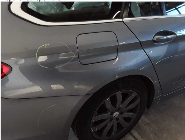
Domage #9: Panneau latéral arrière droit: Paroi latérale - Déformé - Réparer et repeindre
