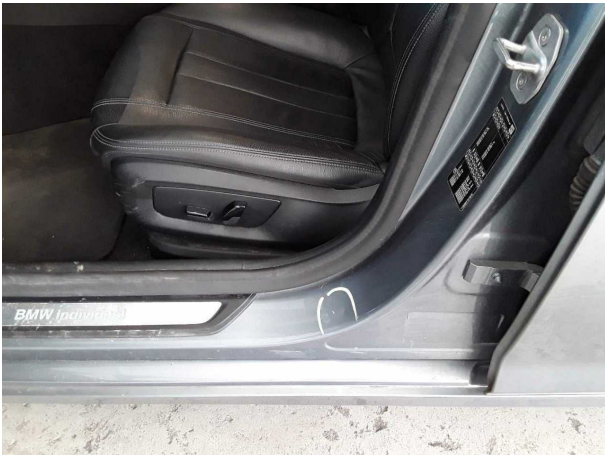
Dommage #2: Seuil gauche: Accès - Bosse, dommage peinture - Réparation intelligente
