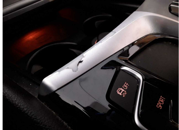
Domage #4: Tableau de bord: Console centrale avant - Era... - Remplacer
