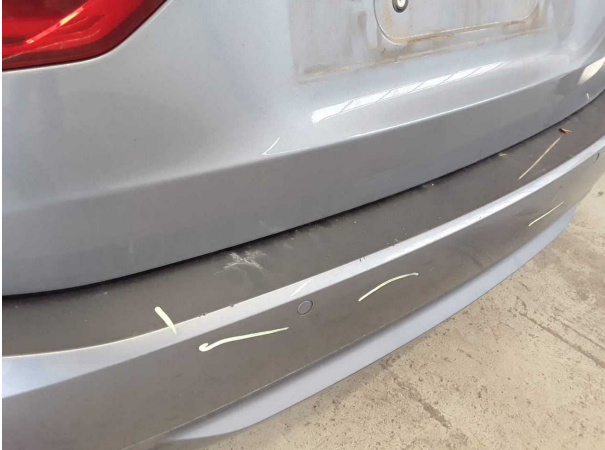
Domage #8: Pare-chocs arrière: Pare-chocs arrière - Erafilé - Réparer et repeindre
