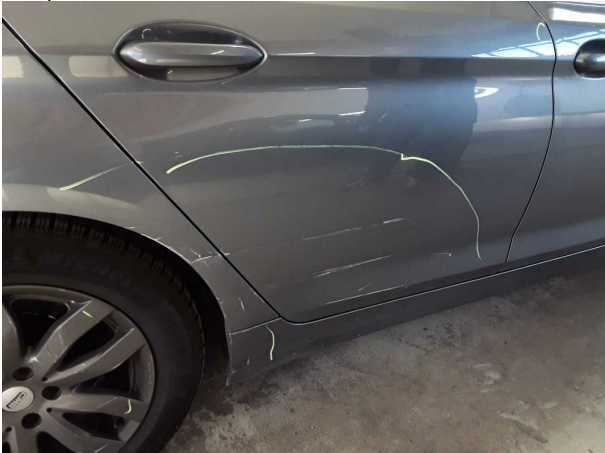
Domage #5: Seuil droit: Habillage - Erafilé - Réparer et repeindre
