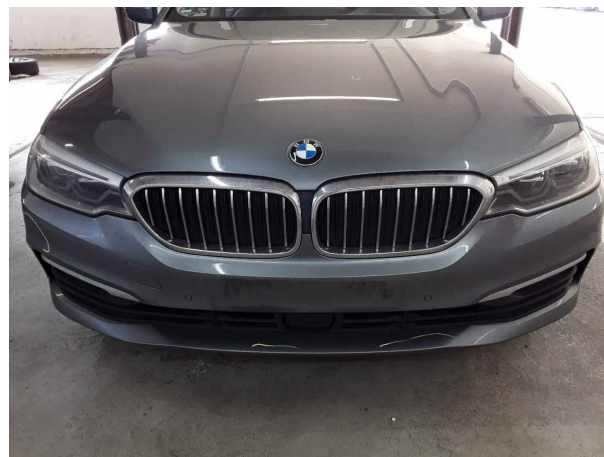
Domage #10: Pare-chocs avant: Pare-chocs avant - Cassé/déchiré - Remplacer
