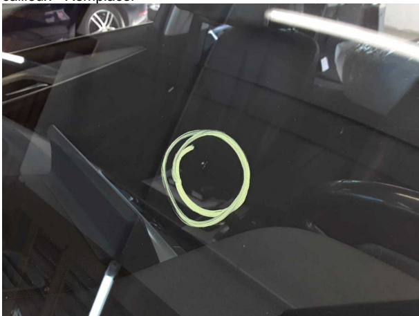
Domage #7: Vitrage: Pare-brise - Dommage causé par des cailloux - Remplacer
