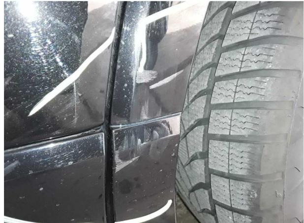
**Beschädigung #2:** Seitenwand links: Radhausverbreiterung - verkratzt / verschürft - Smart Repair
