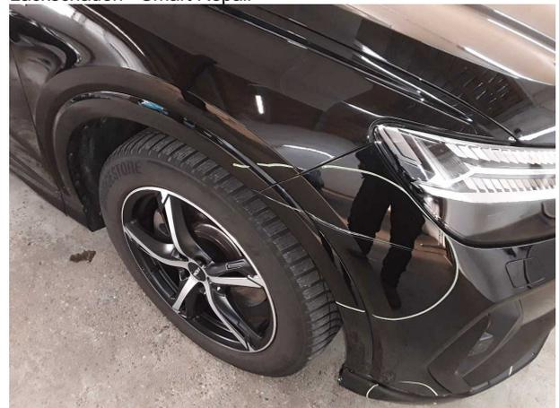
**Beschädigung #5:** Kotflügel rechts: Radhausverbreiterung - verkratzt / verschürft - lackieren
