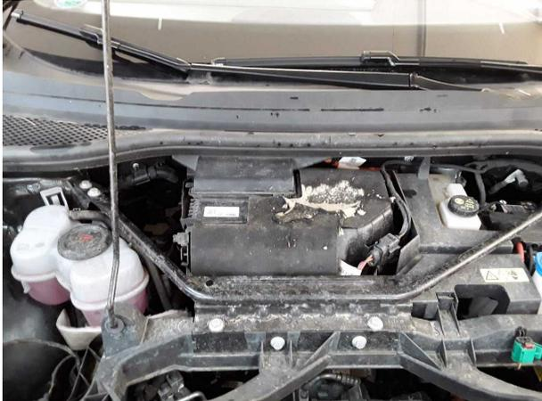
**Beschädigung #1:** Motor: Motorabdeckung oben / Blende - Marderschaden - erneuern
