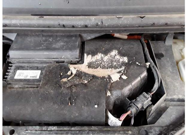
**Domage #1:** Moteur: Capot de moteur haut / Cache - Dommage provoqué par les mantes/rongeurs - Remplacer
