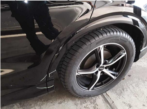
**Domage #2:** Panneau latéral arrière gauche: Elargissement du passage de roue - Eraflé - Réparation intelligente
