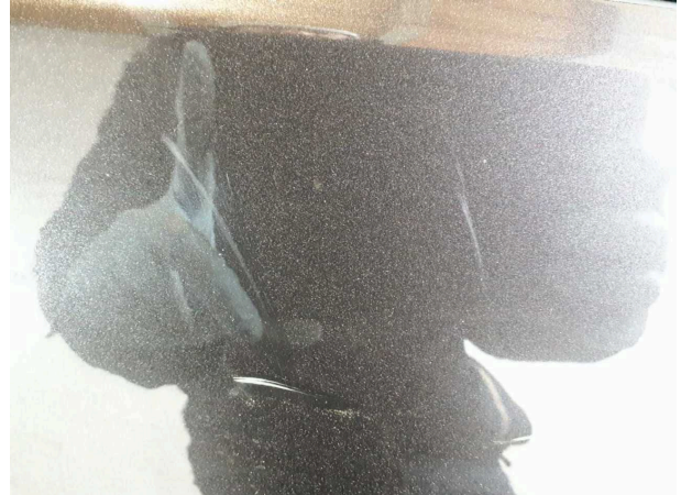
Beschädigung #4: Kotflügel rechts: Kotflügel rechts - Kratzer - auslegen / polieren
