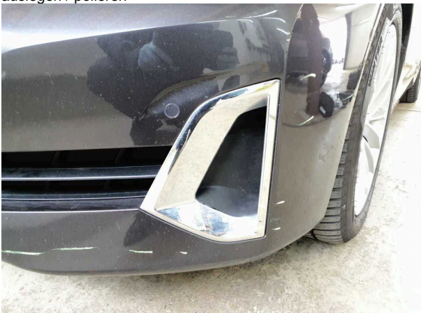
Beschädigung #6: Stossfänger vorn: Blende Stossfänger vorn - verkratzt / verschürft - erneuern
