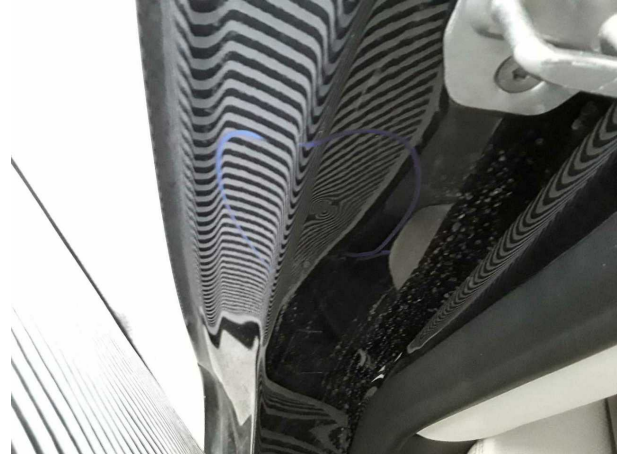
Beschädigung #1: Seitenwand rechts: Einstieg - Delle(n) - sanft instandsetzen
