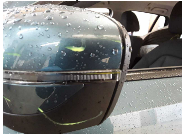
Beschädigung #2: Blinkleuchte: Spiegel links - verkratzt / verschürft - erneuern
