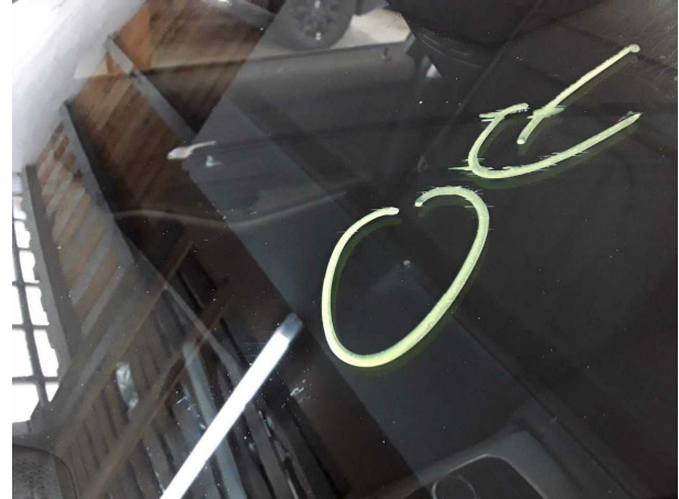
Beschädigung #4: Verglasung: Frontscheibe (Rissbildung) - Steinschlag - erneuern
