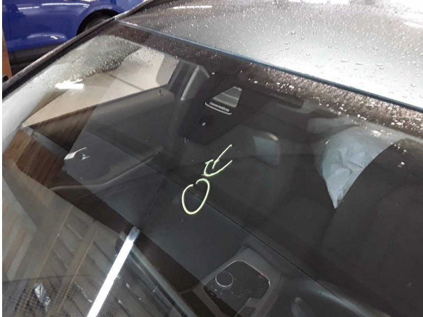
Beschädigung #4: Verglasung: Frontscheibe (Rissbildung) - Steinschlag - erneuern
