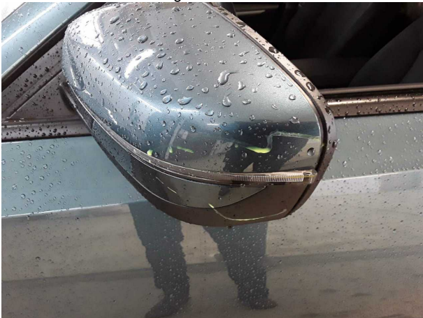
Beschädigung #2: Blinkleuchte: Spiegel links - verkratzt / verschürft - erneuern
