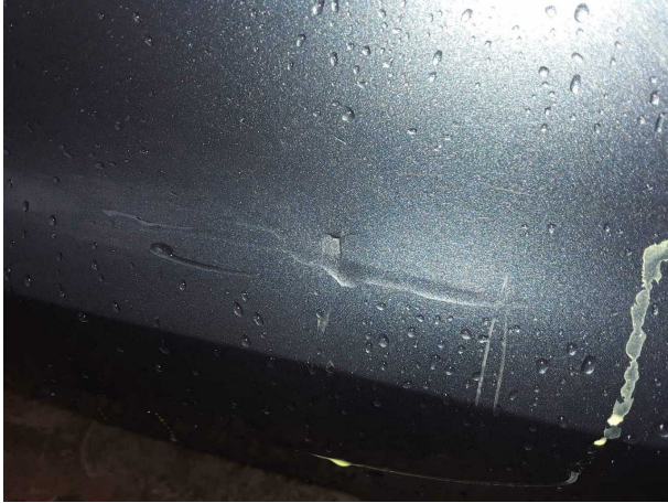
Beschädigung #6: Stossfänger hinten: Stossfänger hinten - verformt - erneuern
