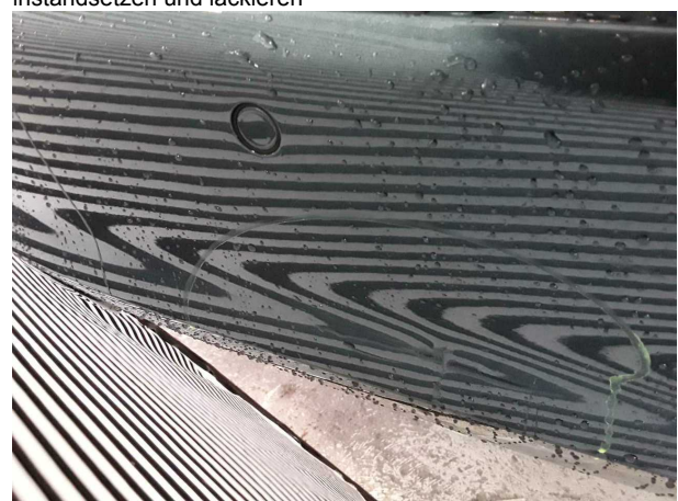
Beschädigung #6: Stossfänger hinten: Stossfänger hinten - verformt - erneuern
