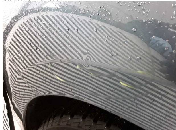
Beschädigung #5: Seitenwand rechts: Seitenwand - Delle(n) - instandsetzen und lackieren
