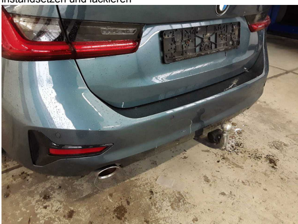
Beschädigung #6: Stossfänger hinten: Stossfänger hinten - verformt - erneuern
