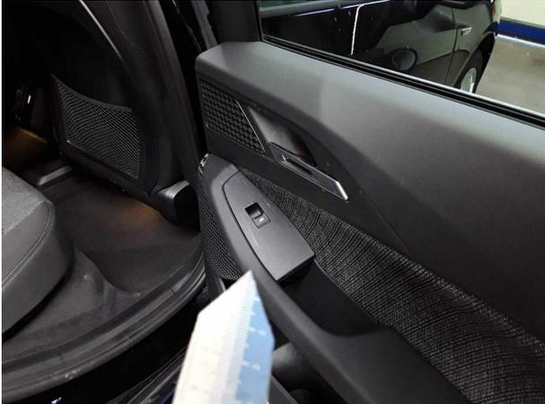
**Beschädigung #1:** Verkleidungen/Abdeckungen: Türverkleidung hinten rechts (Fensterhebereinheit) - Kratzer - erneuern
