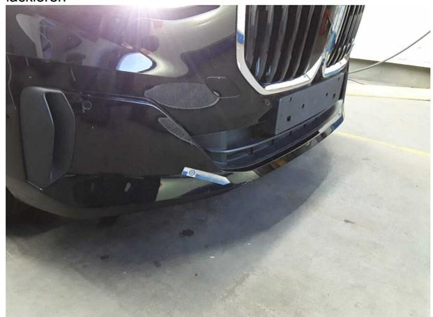
**Beschädigung #5:** Stossfänger vorn: Stossfänger vorn (Unterhalb) - verkratzt / verschürft - instandsetzen und lackieren
