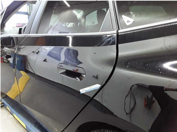
**Beschädigung #2:** Tür hinten links: Türkante - verkratzt / versch...
