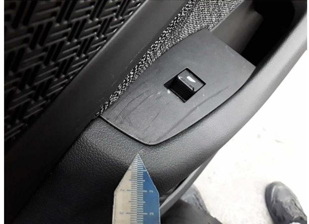
**Beschädigung #1:** Verkleidungen/Abdeckungen: Türverkleidung hinten rechts (Fensterhebereinheit) - Kratzer -
