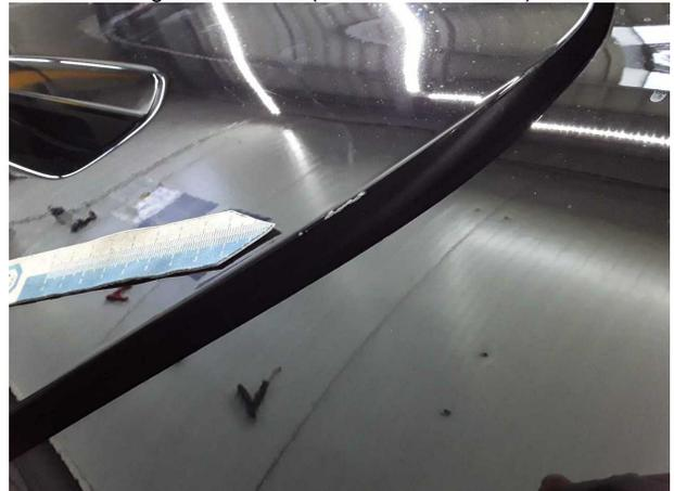
**Beschädigung #2:** Tür hinten links: Türkante - verkratzt /
