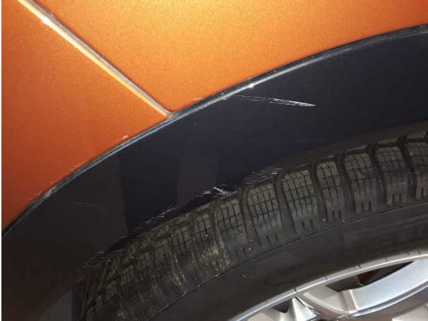
Beschädigung #2: Seitenwand rechts: Radlauf - Kratzer - Smart Repair
