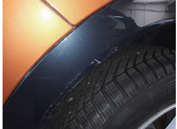
Beschädigung #2: Seitenwand rechts: Radlauf - Kratzer - Smart Repair
