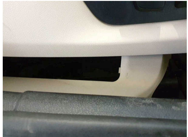
Damage #3: Trim / covers: Trim / covers (Sitz vorne rechts unten) - Loose - Replace
