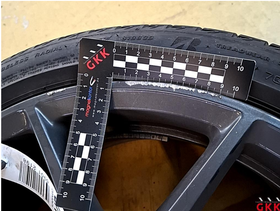
Bild 14. LM-Rad, 1 x beiliegend, beschädigt, Smartrepair
