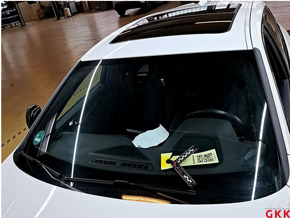
Bild 19. Frontscheibe, mit Regensensor, Frontkamera und Head-up-Display, Steinschlag im Sichtfeld, ersetzen
