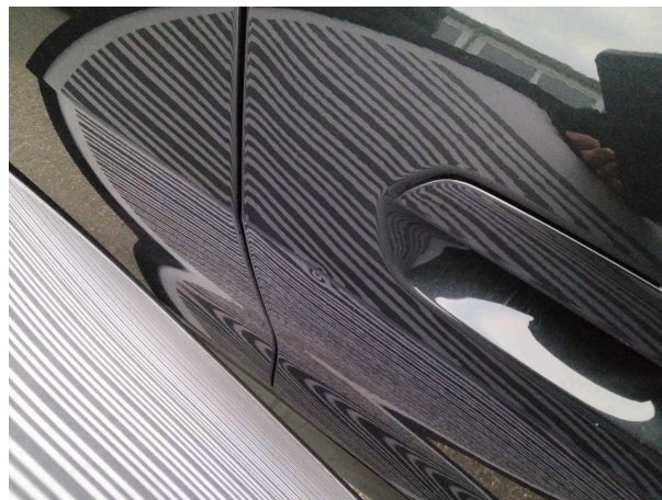
Dommage 1: Porte AvD: Porte - bosse(s) - Réparation intelligente
