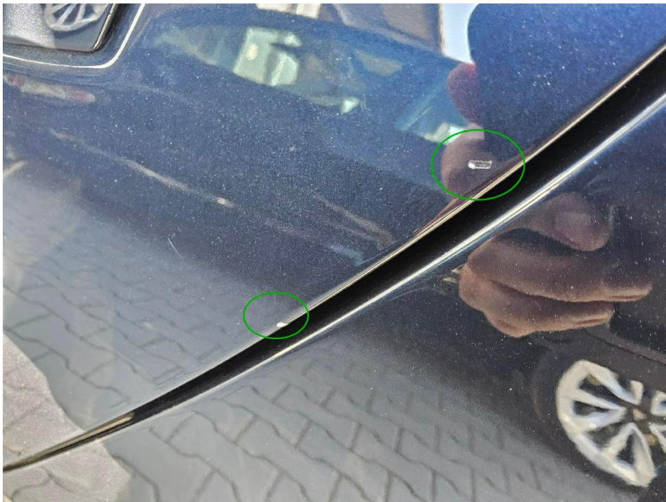
Bild 34 : Türkante hinten links verschrammt
