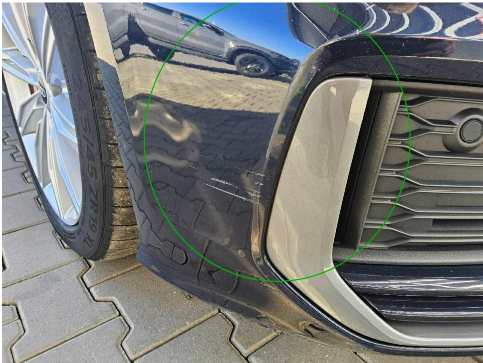
Bild 20 : Stoßfänger vorne verschrammt und verformt
