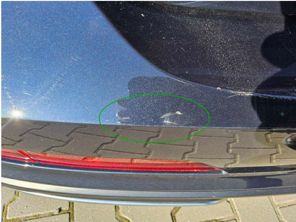
Bild 31 : Stoßfänger hinten verschrammt
