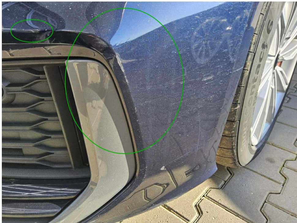
Bild 16 : Stoßfänger vorne verschrammt und verformt
