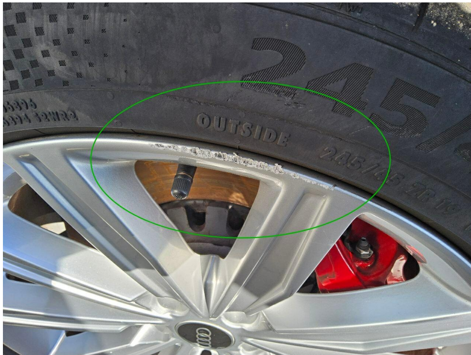
Bild 9 : 4x LM-Felge verschrammt
