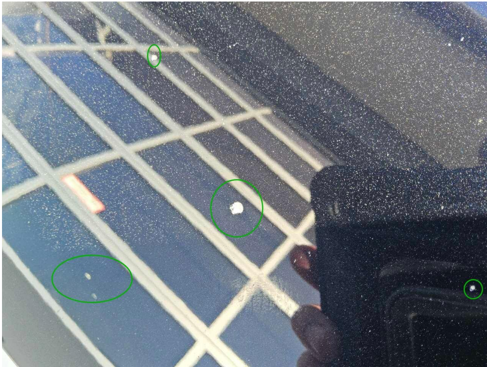
Bild 23 : Motorhaube mehrere Steinschläge
