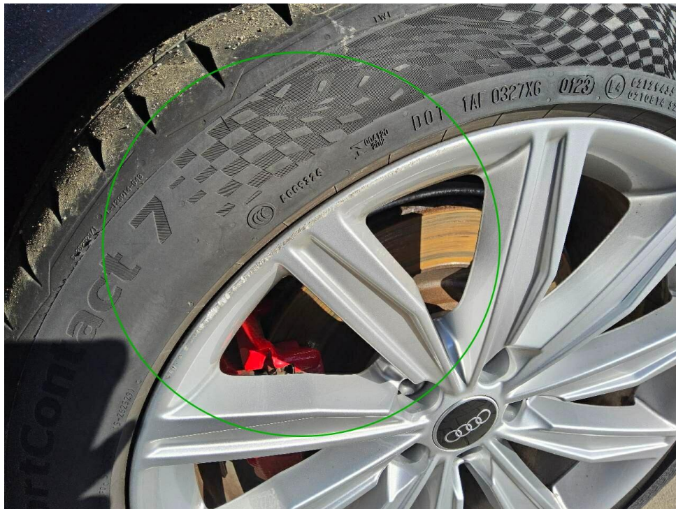
Bild 13 : 4x LM-Felge verschrammt
