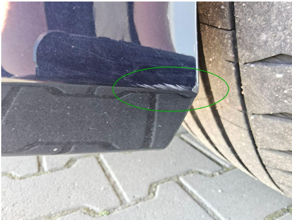
Bild 30 : Stoßfänger hinten verschrammt
