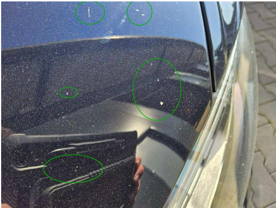
Bild 24 : Motorhaube mehrere Steinschläge
