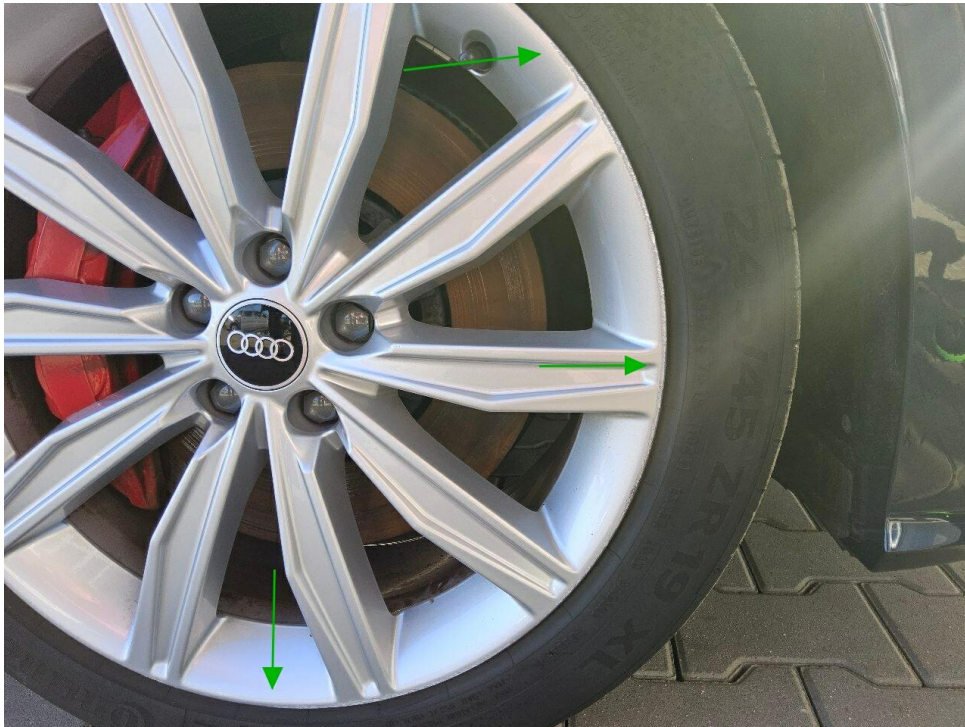
Bild 11 : 4x LM-Felge verschrammt
