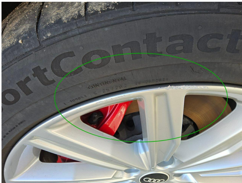
Bild 10 : 4x LM-Felge verschrammt
