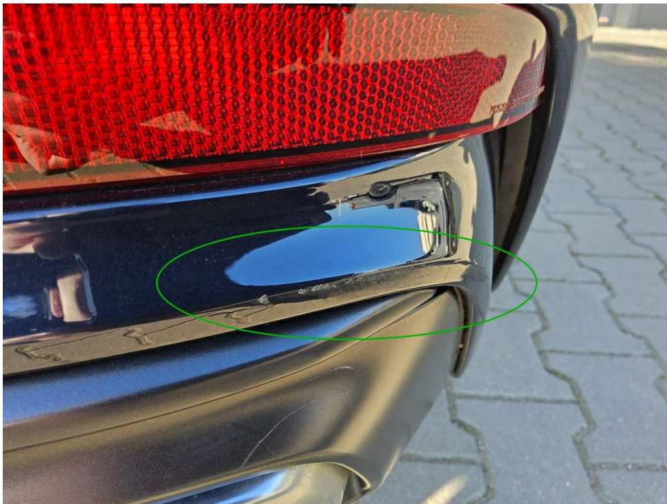
Bild 28 : Stoßfänger hinten verschrammt
