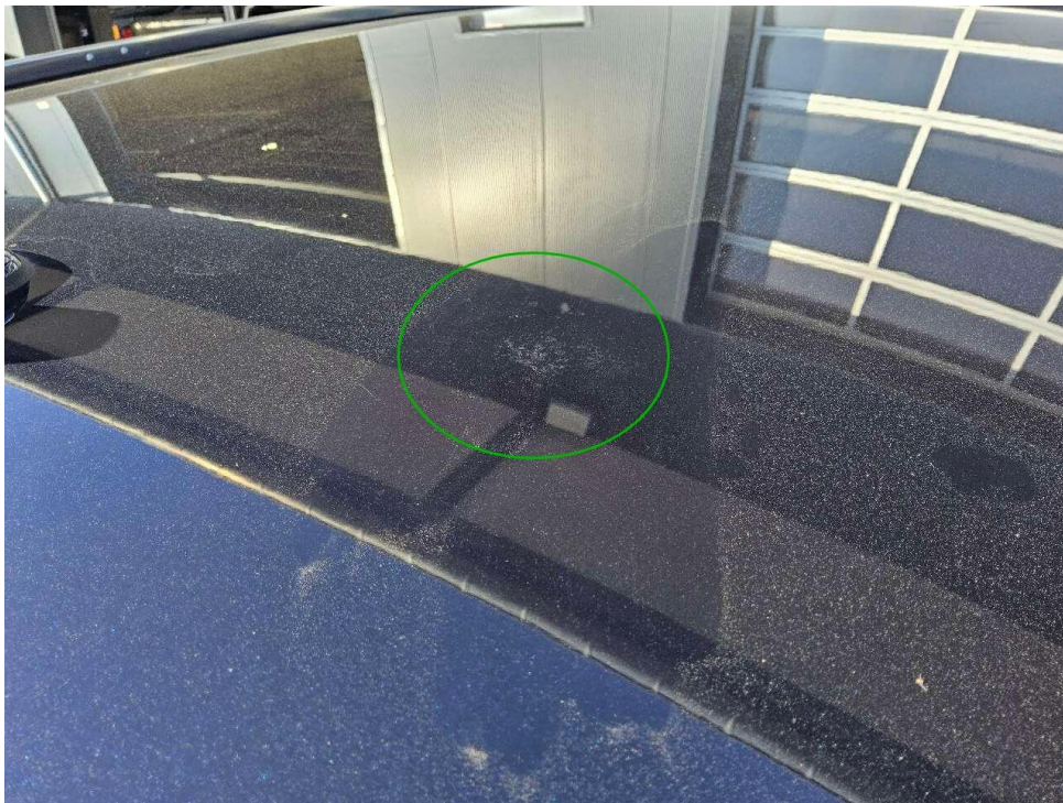
Bild 26 : Dach verschmutzt (Umwelteinflüsse), polieren
