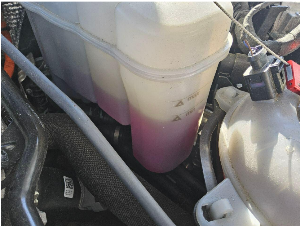
Bild 8 : Kühlmittelstand unter min.
