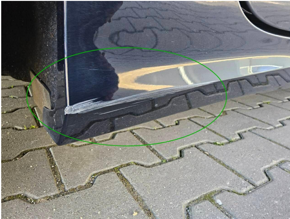
Bild 27 : Außenschweller rechts verschrammt
