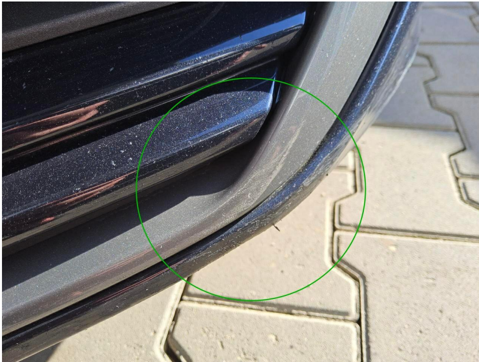
Bild 25 : Stoßfänger Zierleiste links verschrammt
