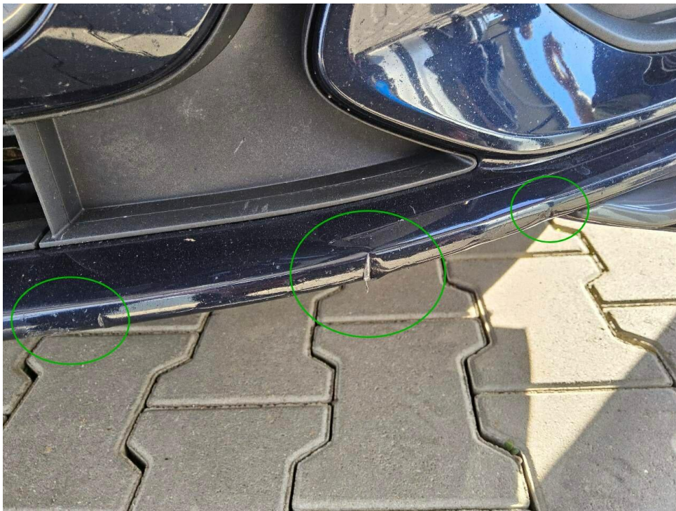
Bild 18 : Stoßfänger vorne verschrammt und verformt
