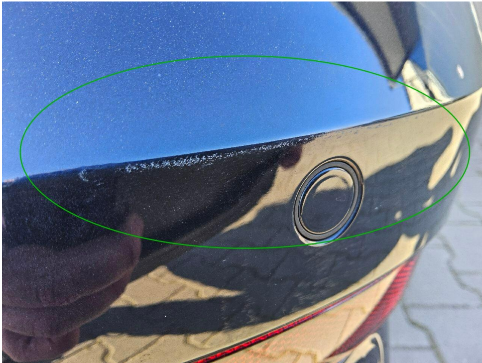
Bild 29 : Stoßfänger hinten verschrammt
