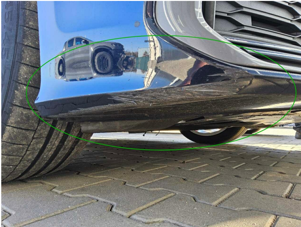
Bild 21 : Stoßfänger vorne verschrammt und verformt
