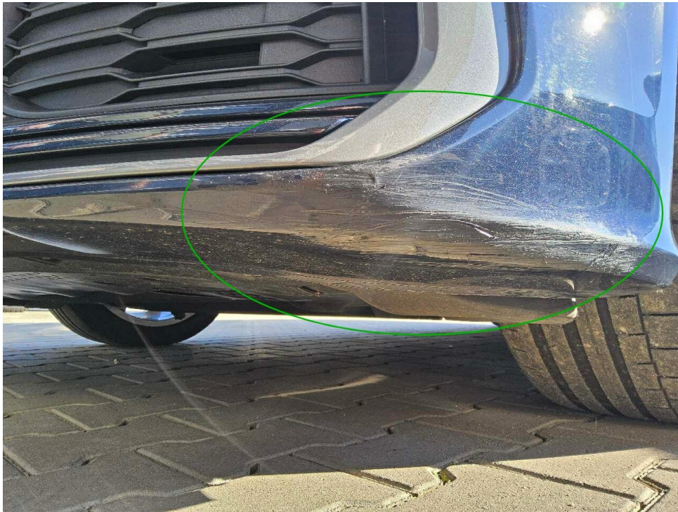
Bild 17 : Stoßfänger vorne verschrammt und verformt
