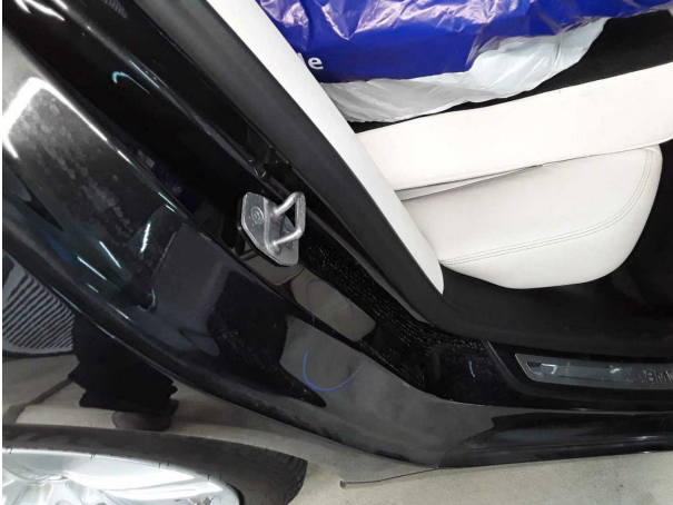
Domage #1: Panneau latéral arrière droit: Accès - bosse(s) - Bon travail de réparation
