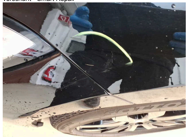
Beschädigung #3: Kotflügel links: Kotflügel links - verkratzt / verschürft - instandsetzen und lackieren
