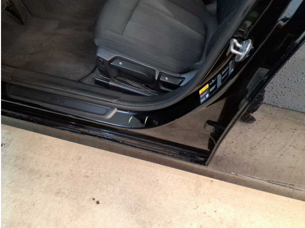
Beschädigung #1: Schweller links: Einstieg - Kratzer - Smart Repair
