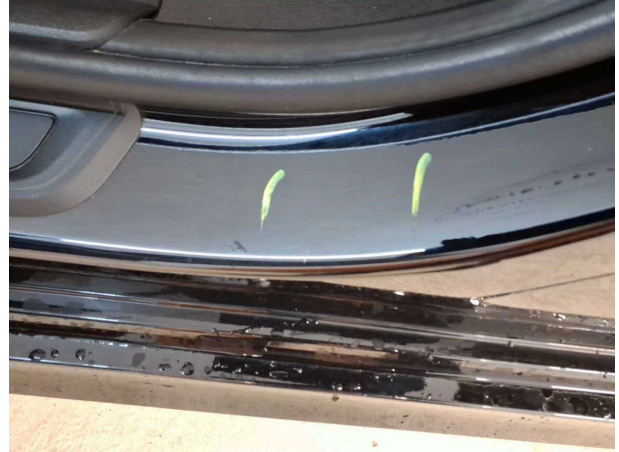
Beschädigung #1: Schweller links: Einstieg - Kratzer - Smart Repair
