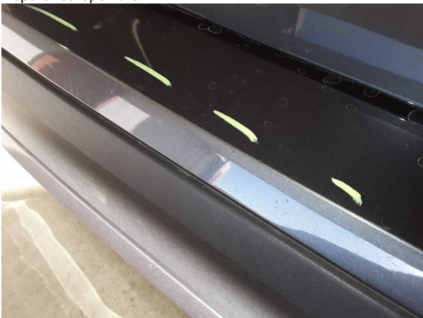
Dommage #2: Pare-chocs arrière: Pare-chocs arrière - Eraflé - Réparer et repeindre
