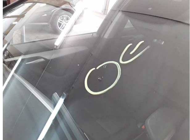
Domage #3: Vitrage: Pare-brise (Rissbildung) - Dommage causé par des cailloux - Remplacer
