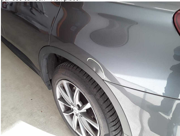
Domage #4: Panneau latéral arrière gauche: Paroi latérale - Bosse, dommage peinture - Réparer et repeindre
