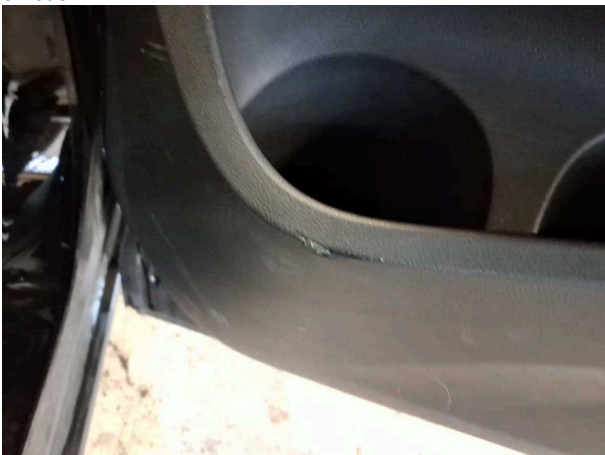
Beschädigung #3: Verkleidungen/Abdeckungen: Türverkleidung hinten rechts - verkratzt / verschürft - Wertminderung
