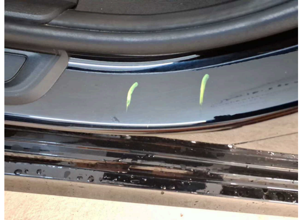
Dommage #1: Seuil gauche: Accès - Rayure(s) - Réparation intelligente
