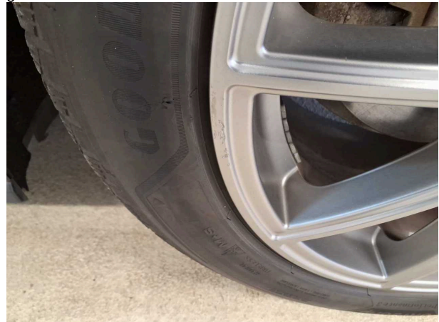
Domage #2: Roue / Pneumatiques: Jante alliage arrière gauche - Erafé - Pas de moins-value
