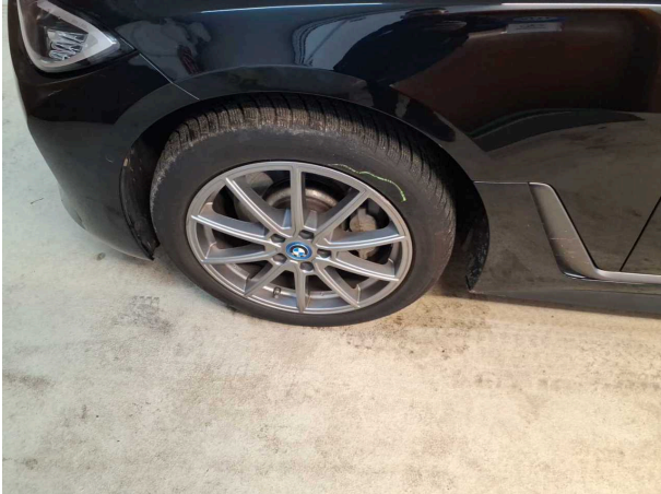
Domage #1: Roue / Pneumatiques: Jante alliage avant gauche - Erafé - Pas de moins-value
