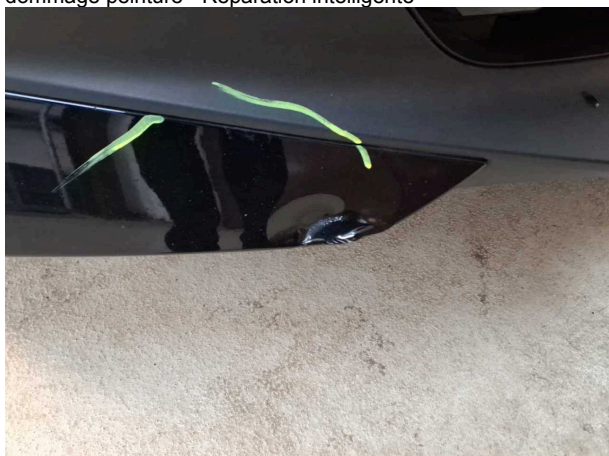
Domage #4: Pare-chocs avant: Pare-chocs avant - Déformé - Remplacer
